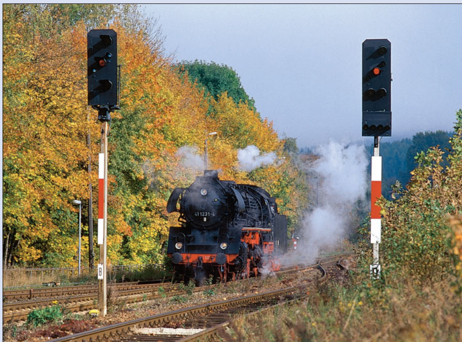
Das vom linken HI-Ausfahrtsignal signalisierte Ra 12 verrät, dass 411231 den Bahnhof nicht verlassen, sondern lediglich an das andere Zugende umsetzen soll.
