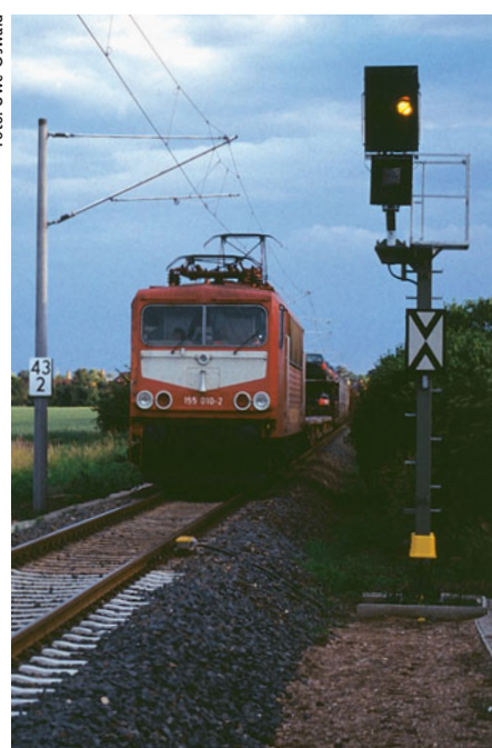
Die KS-Signale der DB AG besitzen schlichte Signalschirme; eine 155 rollt hier an einem Vorsignal vorbei.
