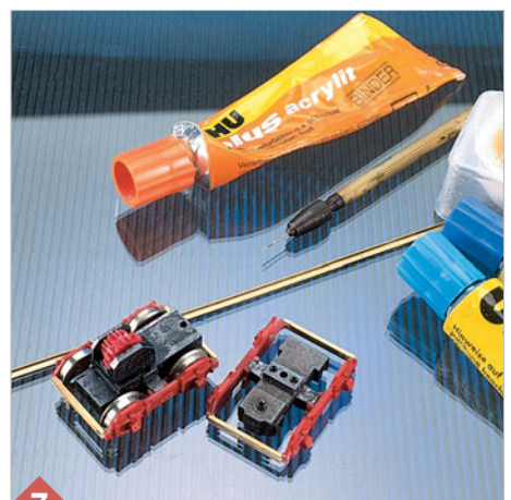
7 Als Verbindung zwischen den Drehgestellblenden dient ein Ms-U-Profil.
