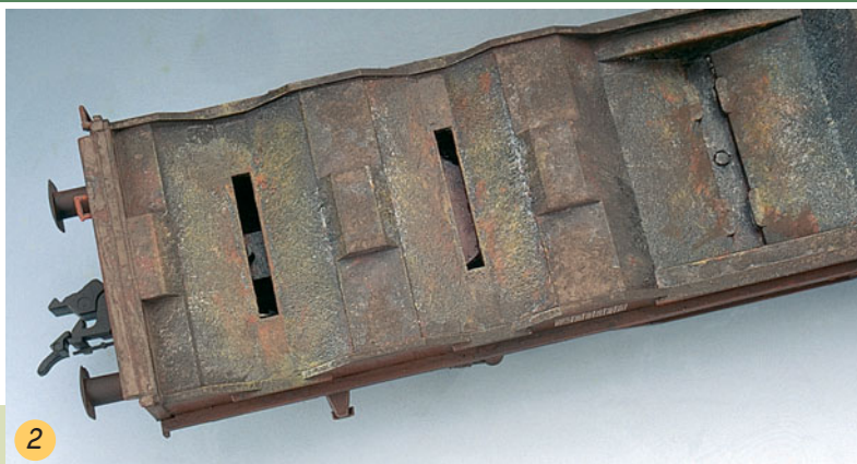
2 Zum Schluss dämpfen nochmals schmutzige Rosttöne die Farbigkeit. Beim Auftragen der verdünnten Farbe ist eine Spritzpistole sehr hilfreich.
