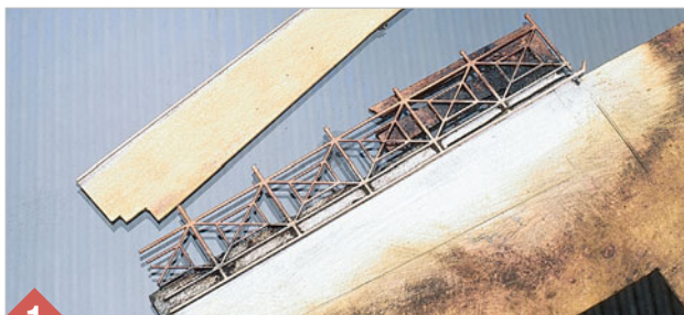
1 Der Kohlenkastenaufbau wird mit Messingblech erhöht. Für die Verstärkungs-kante nimmt man ein Stück Geländer.
