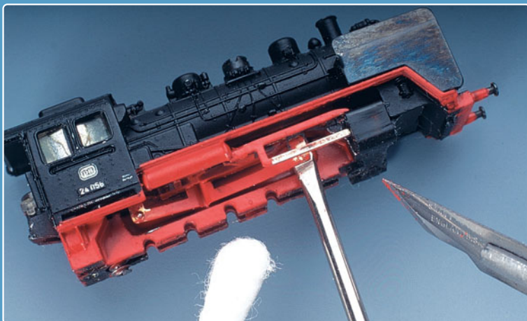
3 Die Stromkontaktstreifen werden rot bemalt. Anschließend befreit man die Kontaktpunkte wieder von der angetrockneten Farbe.
