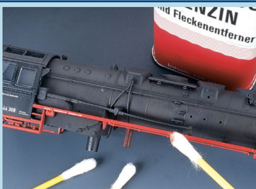
Zur Reinigung des Umlaufs von den Spuren der Alterung kommen erneut Wattestäbchen zum Einsatz.
