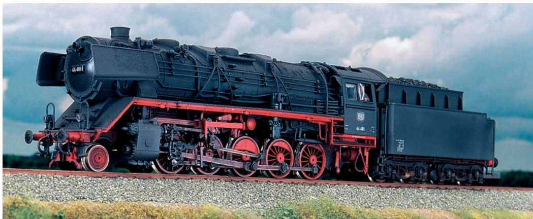
Das gleiche Modell wurde im Fahrwerk zusätzlich gealtert und anschließend mit Verdünnung gesäubert.
