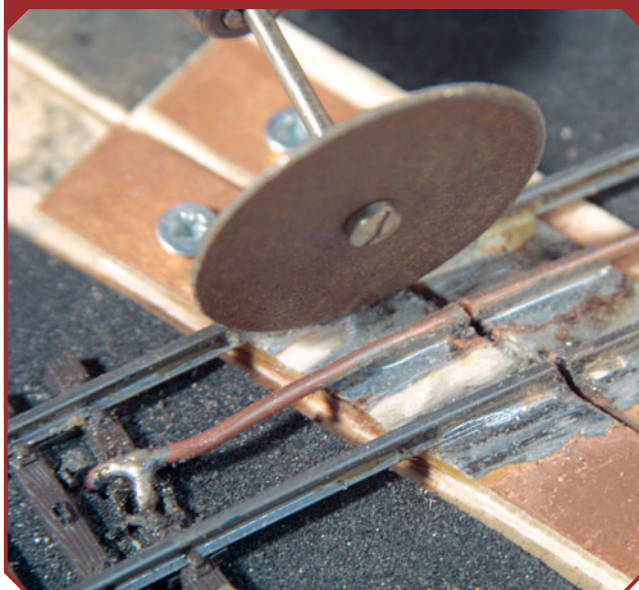
Kupferkaschierte Pertinaxstreifen werden mit einer nicht allzu kleinen Trennscheibe elektrisch getrennt.
