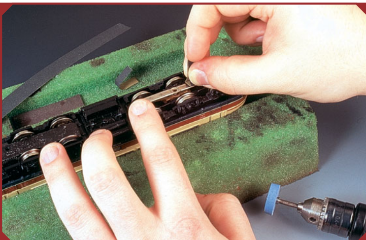
Die Skischleifer von Wechselstromfahrzeugen werden mit feinem Nassschleifpapier gereinigt. Eine Lokliege erweist dabei gute Dienste.
