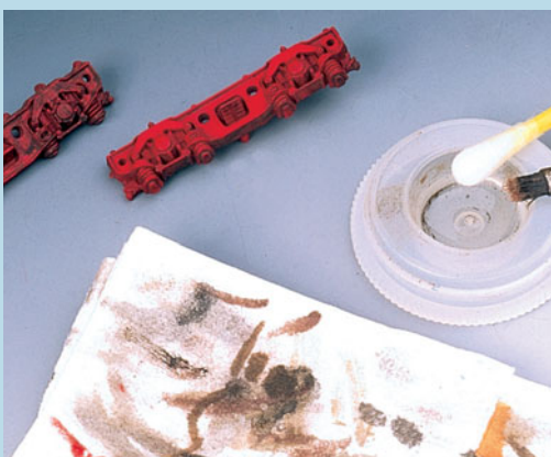
Die gealterten Tenderdrehgestellblenden werden mit Feuerzeugbenzin und Q-Tip gezielt gereinigt.
