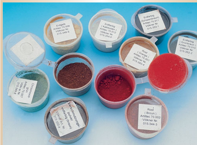
Die untereinander mischbaren Pulverfarben eignen sich zur Fahrzeugalterung nur bedingt. Sie sind nicht abriebfest.
