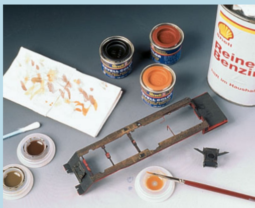
Eine etwas übertrieben wirkende Rostfärbung lässt sich mit Reinigungsbenzin wieder abmildern.
