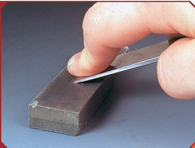
An einem Schleifstein werden stumpf gewordene Klingen, etwa eines Stechbeitels, nachgeschliffen.
