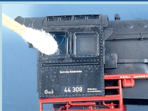
Mit einem Wattestäbchen werden die Fenster und Lokschilder am Führerstand wieder gereinigt.
