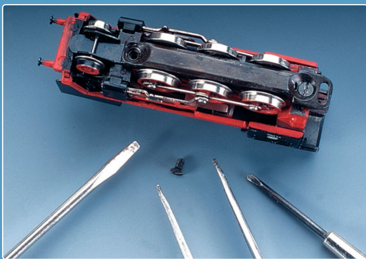
4 Die dicke Bodenplatte des Modells der BR 24 von Märklin wird zum Schluss unlackiert wieder an das Fahrwerk montiert.
