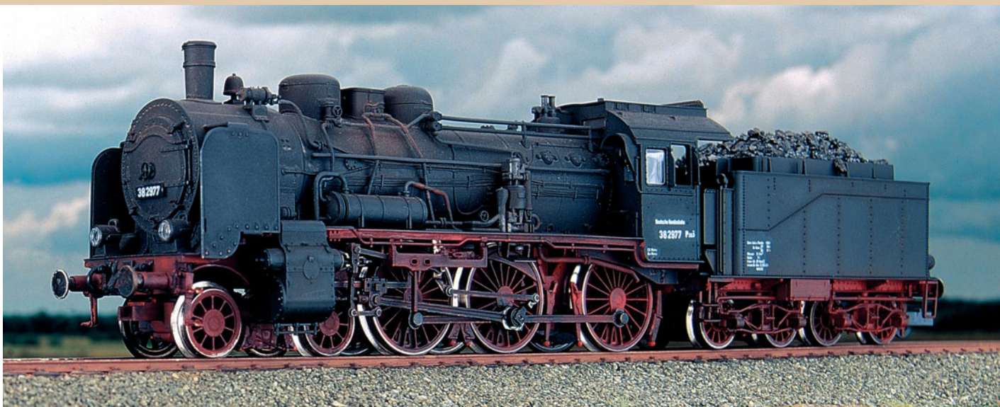
Negatives Beispiel: Der Lokkessel ist undifferenziert gealtert worden. Puffer und Fahrwerk sind fleckig, zu viele Rotstellen schimmern durch.
