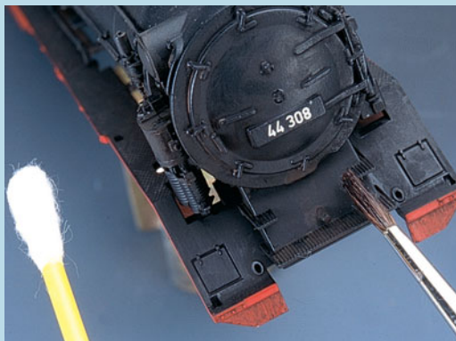
Während die Rauchkammertür etwas gereinigt wird, verbleibt auf der Schürze viel Dreck.
