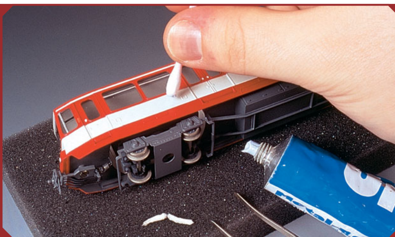
Für die Entfernung kleiner Lackunebenheiten eignen sich am besten Watte-stäbchen, auf die Schleifpaste aus der Tube aufgetragen wird.
