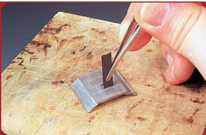
Bei feindetaillierten Bauteilen, etwa aus Lokbausätzen, hat sich eine Briefmarkenpinzette mit eingeklemmtem Schleifpapierstück bewährt.
