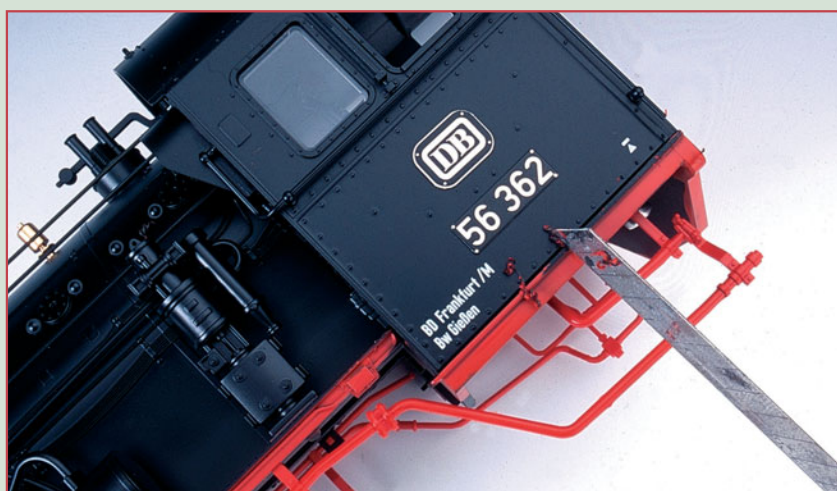
Bei serienmäßig rot lackierten Kanten kann man statt des Bemalens die Farbe mit einer scharfen Messerklinge durch vorsichtiges Schaben wieder entfernen.
