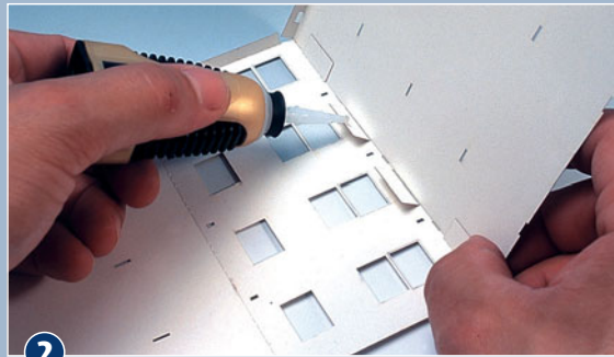
2 Mit Sekundenkleber werden die Verbindungs-laschen an ihrem endgültigen Platz fixiert.
