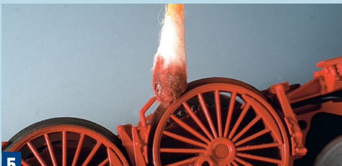
5 Ist der Lackauftrag gut angetrocknet, reinigt man die Radlaufflächen mithilfe eines Wattestäbchens von überschüssiger Farbe.
