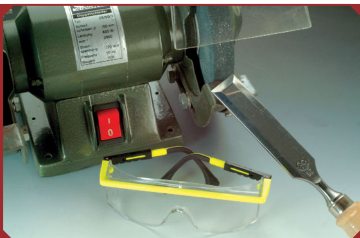
Bei Schleifarbeiten an einem Schleifbock sollten grundsätzlich die Augen mit einer Schutzbrille vor Funkenflug geschützt werden.
