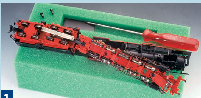
1 Als erster Arbeitsschritt wird das Fahrwerk vom Kesselaufbau getrennt, damit alle Bereiche zugänglich sind.
