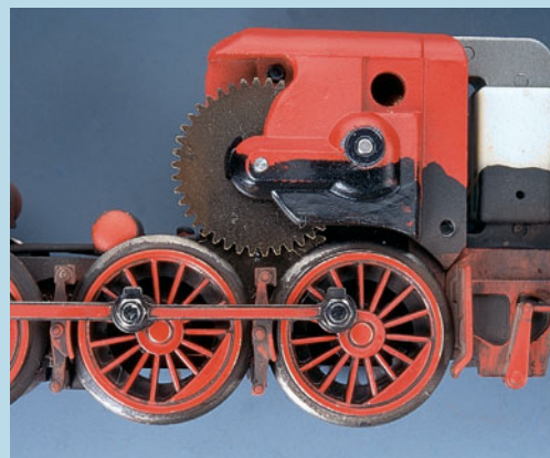
Auch dem Getriebeblock verpasst man etwas schwarzen Lack, damit er nicht mehr durchscheint.
