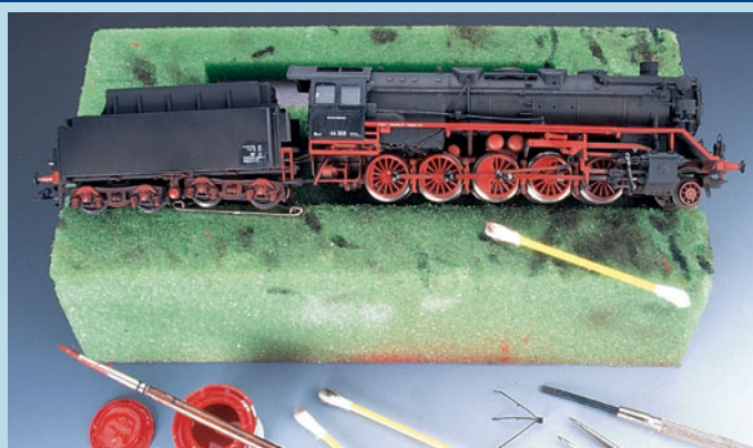
Zum Abschluss der Arbeiten werden noch fehlende Zurrüsteile angebracht. Auch die Griffstangen können nun gesäubert werden.
