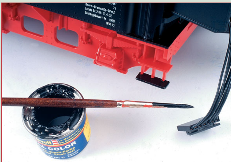
Wie bei kleinen Modellen werden aus Kostengründen die Trittstufen nicht farbig abgesetzt. Der Griff zum Pinsel schafft auch hier wieder Abhilfe.
