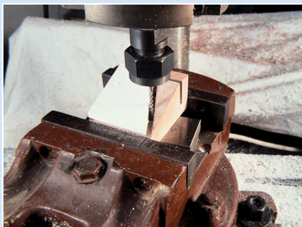
Die Wände des maßstäblichen Gebäudeanbaus bestehen aus einem speziellen Modellbau-Kunststoff.
