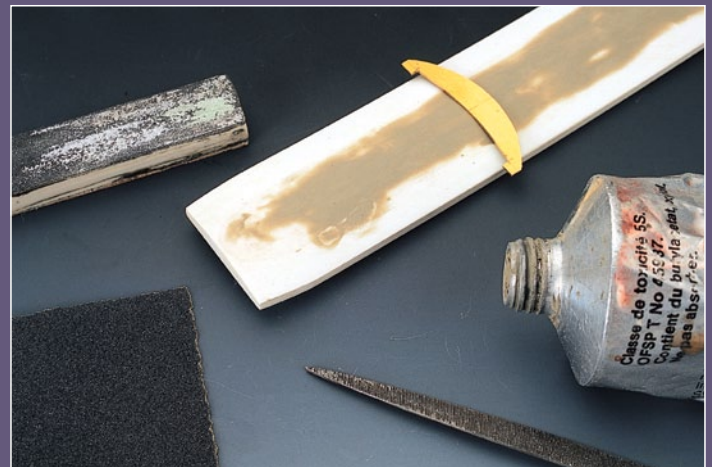
Zum Überprüfen der angespachtelten Rundung kann beim Schleifen eine Radienschablone sehr hilfreich sein.
