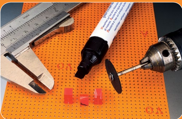
Die LED werden exakt abgemessen und mit der Trennscheibe in passende Form gebracht.
