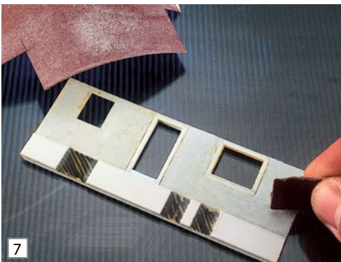
7 Mit in U-Form gefaltetem Schleifpapier der Körnung 150 entfernt man gröbste Unebenheiten.
