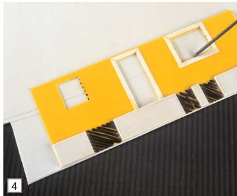
4 Die Wand- und Fenstermaße überträgt man mit der Reißnadel auf eine weitere Polystyrolplatte.
