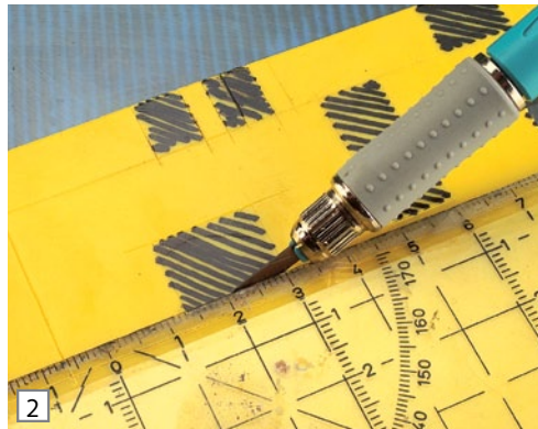
2 Die schraffierten Öffnungen für Fenster und Türen trennt man mit dem Skalpell heraus.
