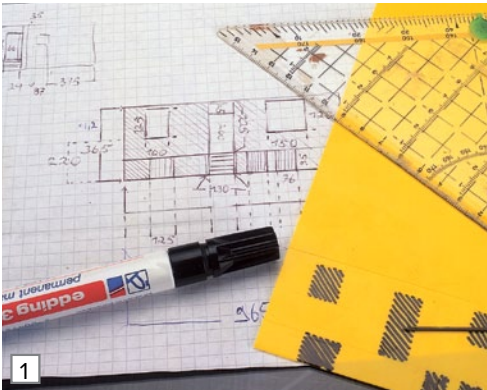
1 Die ermittelten Maße werden mit der Reißnadel auf gelbe Busch-Polystyrolplatten übertragen.
