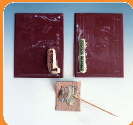
Mit Zweikomponentenkleber werden die LED rückseitig genau positioniert.
