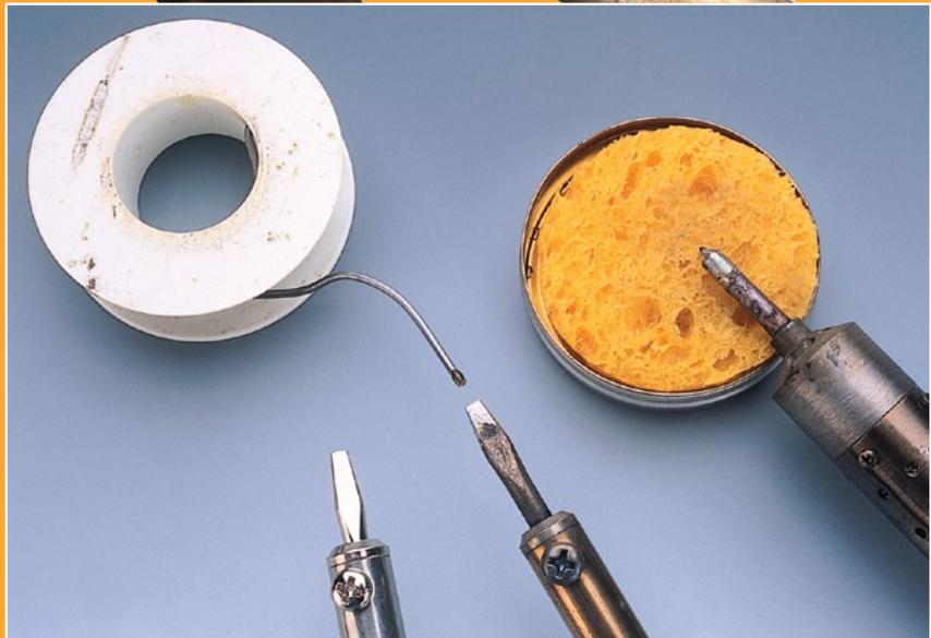
Zur Pflege sollte die warme LötKolbenspitze regelmäßig an einem leicht angefeuchteten Schwämmchen abgewischt werden. Anschließend verzinnt man sie neu.
