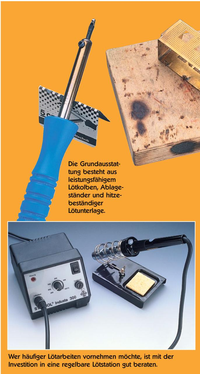
Die Grundausstattung besteht aus leistungsfähigem LötKolben, Ablageständer und hitzebeständiger Lötunterlage.
