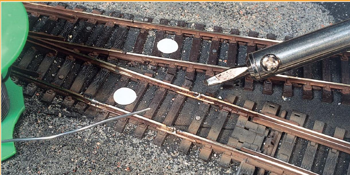
Größere Schienenstoß­blöcke und -verbinder sollten verlötet werden, da Lacke eine isolierende Schicht bilden können.
