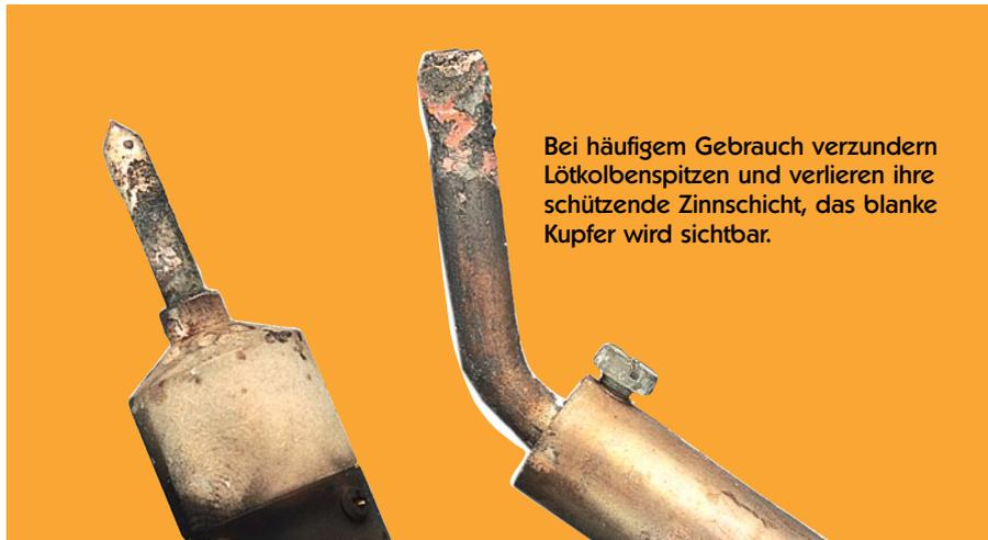
Bei häufigem Gebrauch verzundern LötKolbenspitzen und verlieren ihre schützende Zinnschicht, das blanke Kupfer wird sichtbar.
