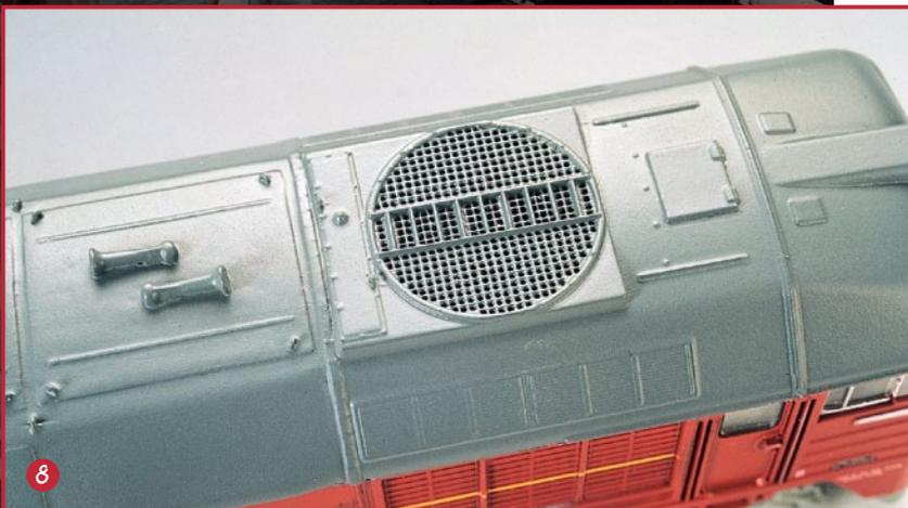
8 Einige Details der umgerüsteten Dachpartie zeigt diese Aufnahme. Die veränderte Wirkung des Lüftergitters wird hier besonders deutlich.
