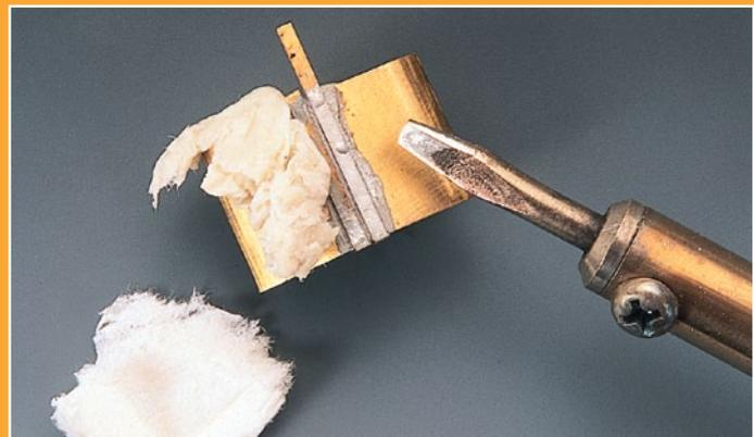
Angefeuchtete Watte oder Kühlpaste verhindern, dass sich eng beieinander liegende Lötstellen durch die erneute Erhitzung lösen.
