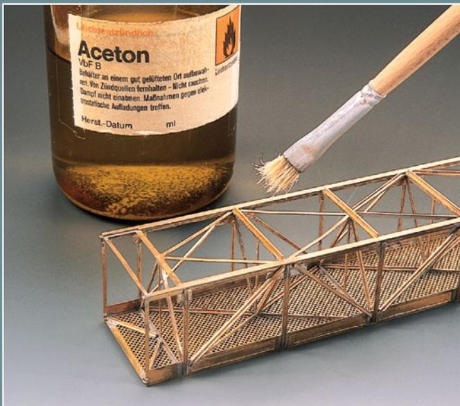
Mittels eines Borstenpinsels und Acetons können Flussmittelreste abgewaschen werden. Die Oxidation wird so gestoppt.
