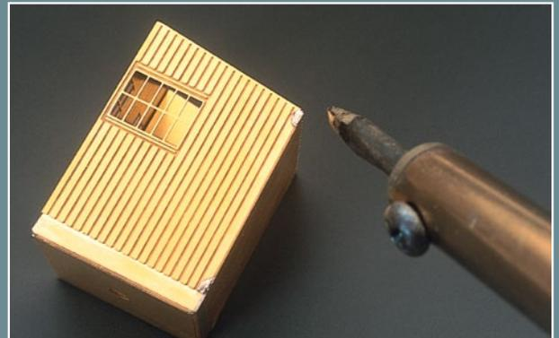
Lange Löt Nähte verlötet man niemals in einem Zug. Durch Punkte werden die Teile fixiert, ohne sich wieder zu lösen.
