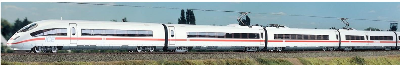
Der ICE 3 ist das Flaggschiff der ICE-Flotte und hebt die Trennung von Waggon und Triebkopf auf. Für Schnellfahrten sind spezielle Strecken nötig.
