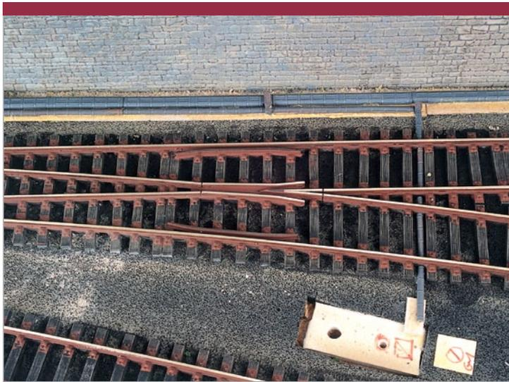
**6** Natürlich erhalten auch Schienenstühlchen, Zwangsschienen und Weichenherzstücke den gleichen Rostton. Jetzt ist das Gleis bereit für die Einschotterung.
