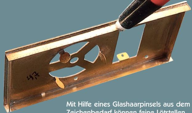
Mit Hilfe eines Glashaarpinsels aus dem Zeichenbedarf können feine Lötstellen von überschüssigem Lötzinn und dem aggressiven Flussmittel gereinigt werden.
