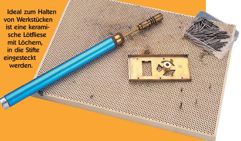
Ideal zum Halten von Werkstücken ist eine keramische Lötfliese mit Löchern, in die Stifte eingesteckt werden.
