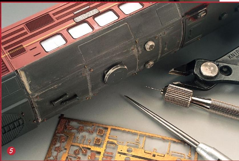
5 Feine Nachbildungen der Hebeösen aus einem Güterwagenzurüstset bereichern das neue Lokdach. Sie werden vor dem Grundieren angebaut.
