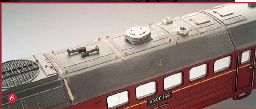
6 Typhone und Dachlüfter stammen vom originalen Dachsegment. Lediglich bei Zerstörung ist ein Ersatz notwendig.
