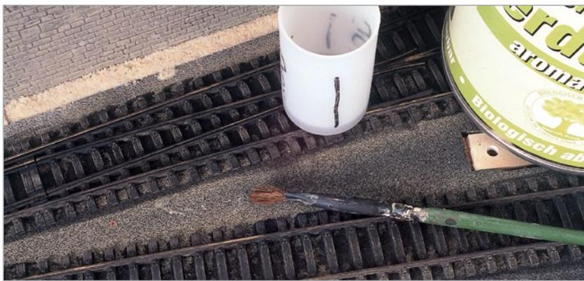
Nachdem die Gleise fest verlegt und elektrisch angeschlossen sind, bemalt man die Gleisprofile seitlich mit einer matten, selbstgemischten Rostfarbe.
