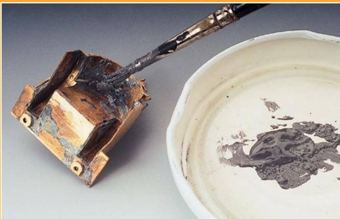
Mit einem alten Pinsel kann man bei weniger diffizilen Lötstellen die Lötpaste auch einfach flächig auftragen.
