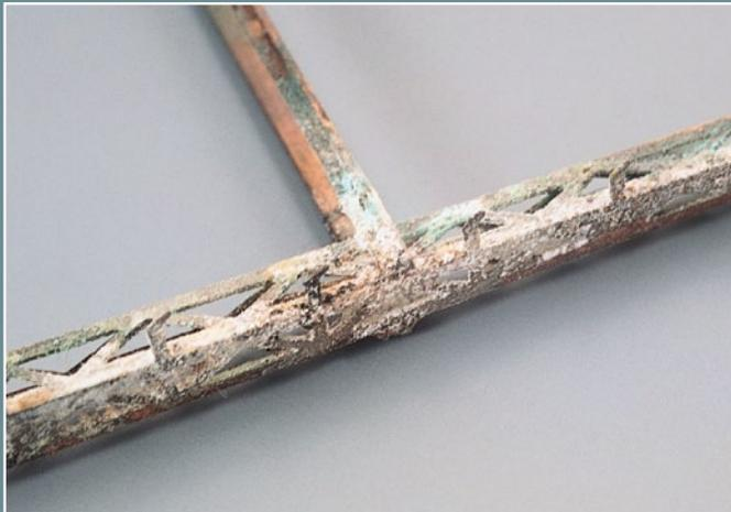
Nicht gereinigte Lötstellen korrodieren im Laufe der Zeit. Dadurch besteht die akute Gefahr, dass das Material unbrauchbar wird.
