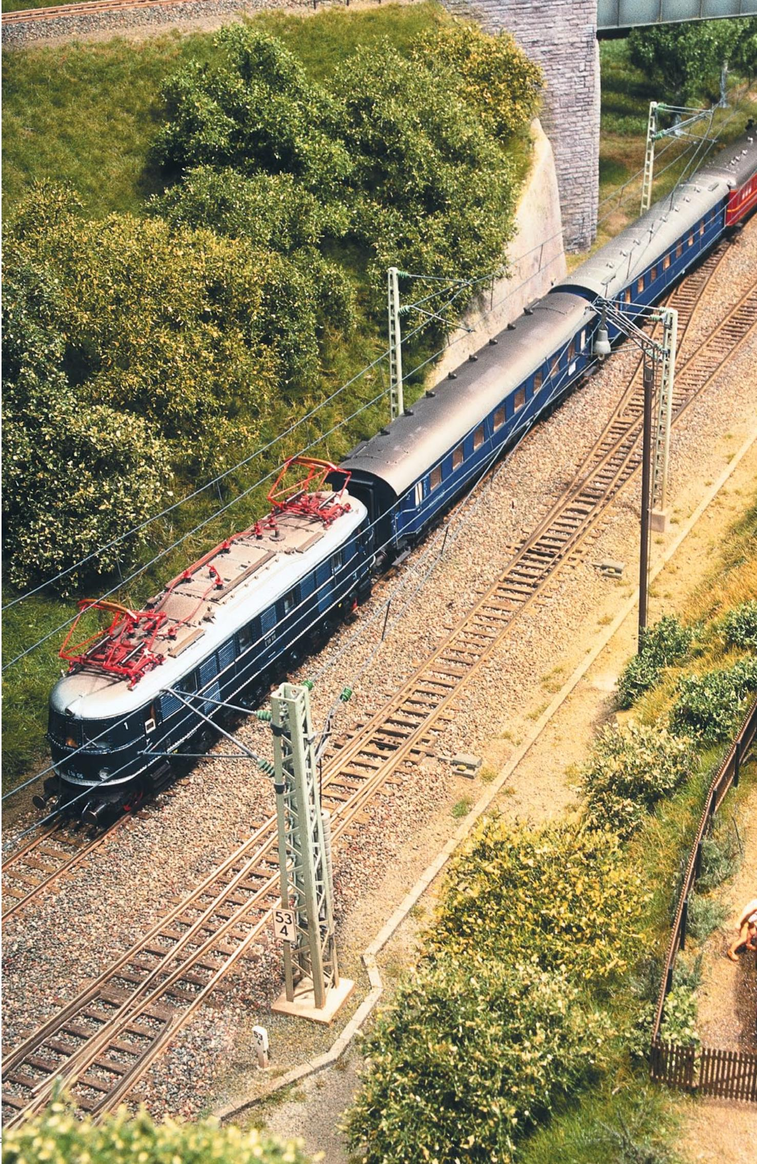
Die Altbau-E-Lok E 18 ist mit zwei Pantographen ausgestattet, die mit Einfachschleifstück ausgerüstet sind. Daher sind beide Stromabnehmer am Fahrdrabt.
