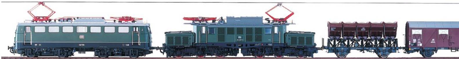
Beide Lokomotiven des Güterzuges haben Doppelschleifstücke, daher werden die am weitesten voneinander entfernten Bügel benutzt.
