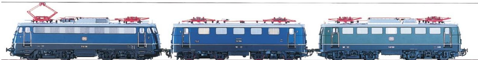
Finden Überführungsfahrten mehrerer Lokomotiven statt, so arbeiten nicht alle Maschinen. Die führende legt den vorderen Bügel an.
