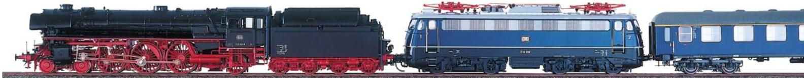
Zur Weiterbeförderung eines liegengebliebenen Zuges wird eine andere Lok vorgespannt, die defekte Ellok läuft dahinter abgebügelt mit.
