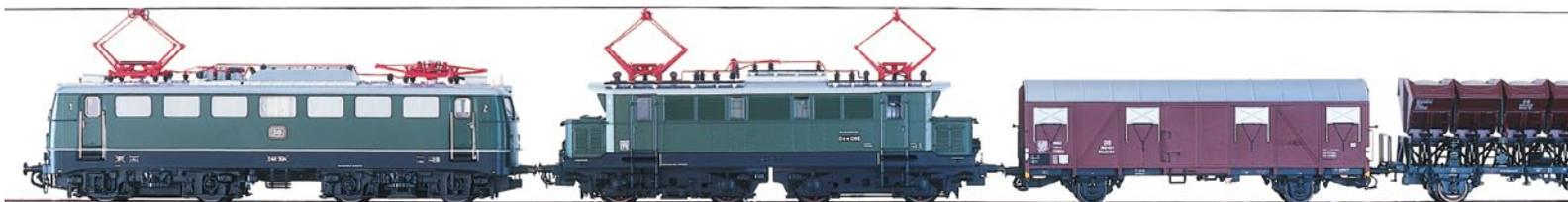
Die E 44 als Zuglokomotive hat Einzelschleifstücke und benutzt daher beide Pantographen, die Vorspannlokomotive stets nur den vorderen.
