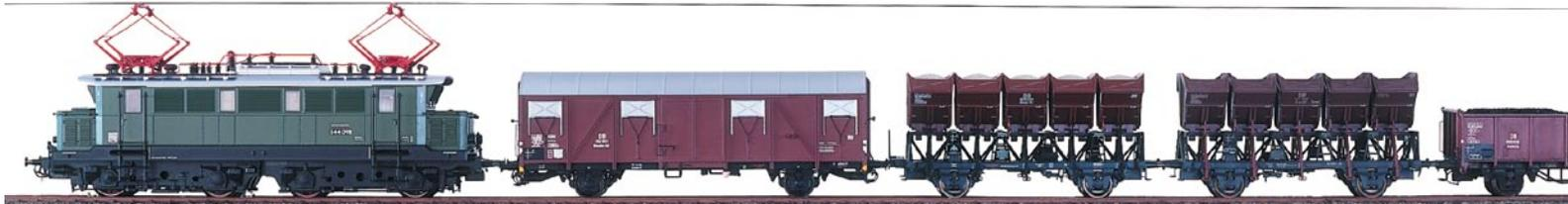
Die Altbauelktrolok der Baureihe E 44 hat nur Stromabnehmer mit Einzelschleifstück, daher benutzt sie stets beide Bügel.
