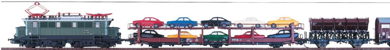
Funkenflug gefährdet den Autolack, daher ist auch bei Altbaueloks mit Einzelschleiferpantographen nur der vordere Stromabnehmer oben.
