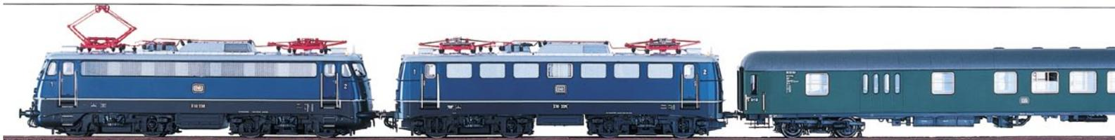
Dient eine Elektrolokomotive als Schleppfahrzeug vor einem lokbespannten Zug, so hat sie den vorderen Stromabnehmer anzulegen.
