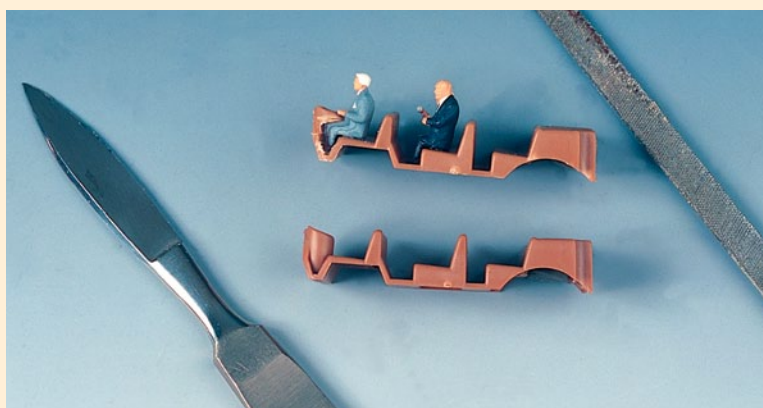
2 Durch kleinere Nacharbeiten wie Feilen und partielles Ausschneiden der Sitze wird Freiraum für die Fahrzeuginsassen geschaffen.
