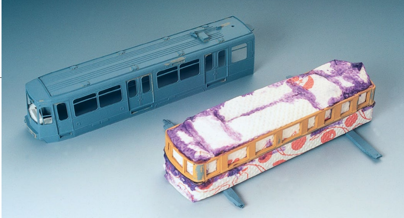
Bei der mehrfarbigen Lackierung eines Fahrzeuges gilt es, dieses nach dem Grundieren sorgfältig abzukleben.
