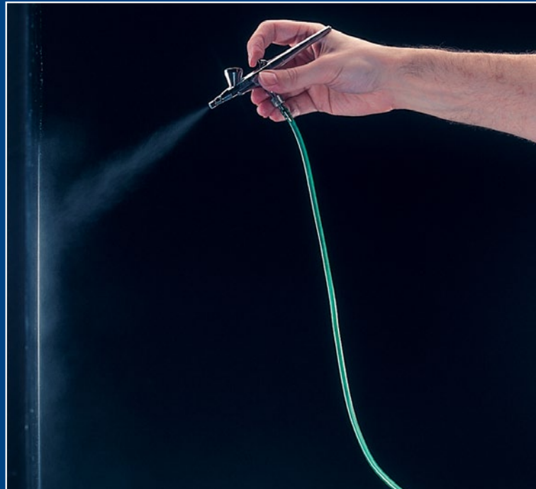
Ein schräger Sprühstrahl verursacht eine ungleichmäßige Farbverteilung, die eventuell eine raue Oberfläche verursacht.
