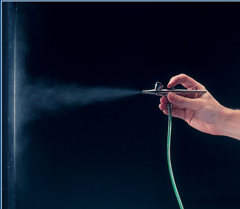
Der im rechten Winkel auftreffende Sprühstrahl bildet einen kleinen, gleichmäßigen Farbnebelring rund um die mit Farbe besprühte Fläche.
