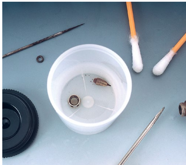
Nadel und Düse der Spritzpistole lassen sich am besten in einer lösungsmittelresistenten Schale gründlich reinigen.
