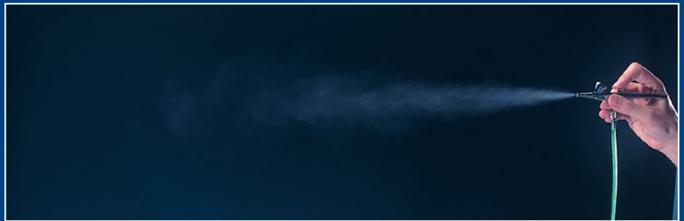
Der Sprühstrahl einer Double-Action-Spritzpistole mit feiner Nadel ist recht schlank.
