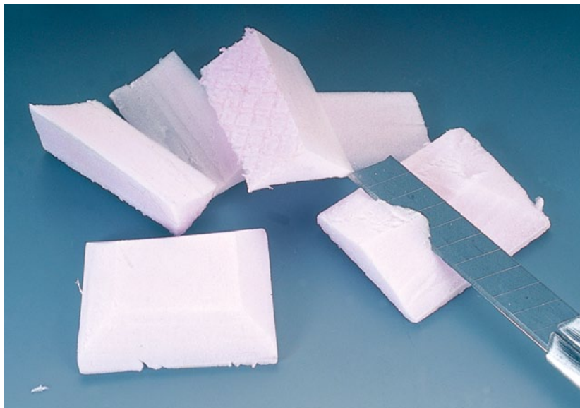
Mit einem Cuttermesser wird die Hartschaumplatte in der für den jeweiligen Güterwagentyp benötigten Einsatzgröße zurechtgeschnitten.
