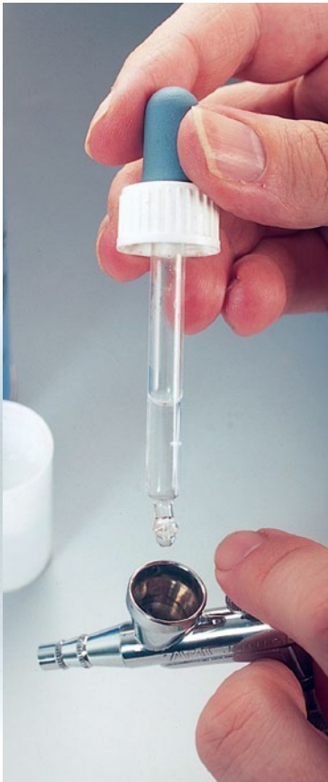
Beim Durchblasen der Spritzpistole mit Verdünnung wird diese mit einer Pipette wohldosiert in den Farbnapf geträufelt.
