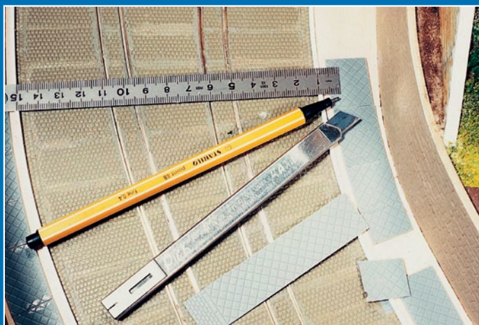
1 Die Polystyrolplatten mit Betonplattenstruktur werden Stück für Stück dem Radius der Straße angepasst.
