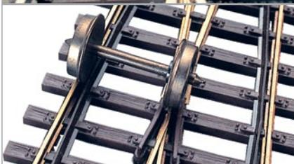
einen störungsfreien Zugbetrieb, da sonst schnell eine Lok mit niedrigem Spurkranz an einer unsauber verlegten Stelle aus den Gleisen gerät. Darum bieten die Großserienhersteller keine Gleise mit dieser Profilhöhe an und alle ihre Fahrzeuge weisen zumeist höhere Spurkränze auf – ein Zugeständnis an die Spielbahner.
