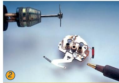
2 Die Motorplatte muß isoliert und der Widerstand entfernt werden.
