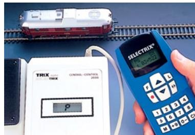
Die Programmierung bei Selectrix erfolgt mit dem Handregler.
