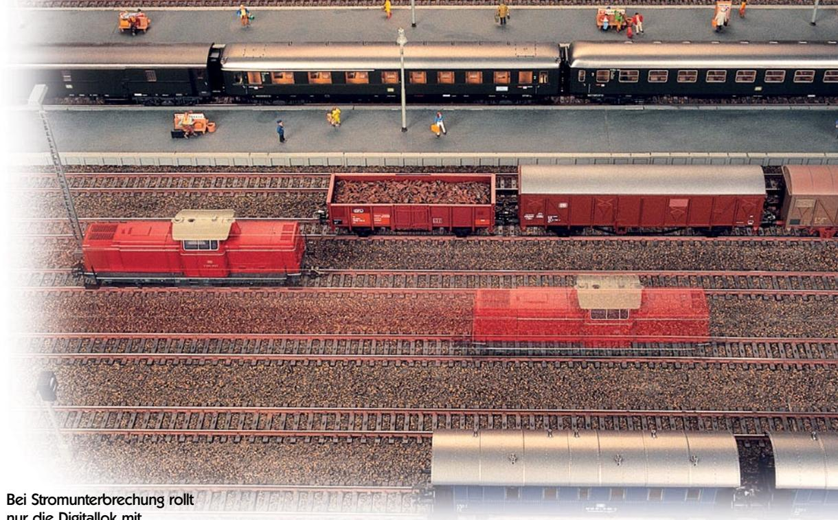
Bei Stromunterbrechung rollt nur die Digitallok mit Schwungscheibe und gutem Getriebe langsam aus.
