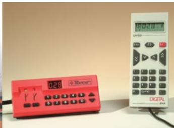
Nicht nur Gleisbesetztzustände können an die Zentrale gemeldet werden. Auch die realen Stellungen von Weichen lassen sich auf dem Lenz-Handregler LH100 und dem Roco-Keyboard ablesen, wenn diese an das Lenz-Digitalsystem angeschlossen sind.
