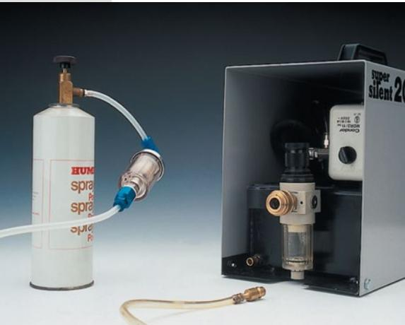
Luft für Spritzpistolen kommt entweder aus der Dose oder dem Kompressor. Ein Wasserabscheider ist dringend zu empfehlen.
