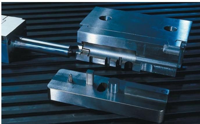
Die Formteile der momentan im Formenbau befindlichen neuen BR 22 zeigen, dass Lokkessel mehrteilige Spritzgussformen erfordern.
