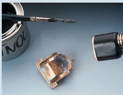
Das Lötens mit der Flamme erleichtert den Zusammenbau vor allem bei Lokbausätzen, die sich in erster Linie aus geätzten Messingblechen zusammensetzen lassen.
