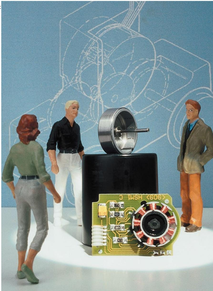
tet die Bürstenlosigkeit den Vorteil, dass keine Abrissfunken mehr entstehen. So kann auch auf zusätzliche Entstörbauelemente verzichtet werden.
