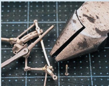
An der Steuerung der ELNA wird mit einer präzisen Flachzange das Ende der Niete vorsichtig zusammengedrückt.
