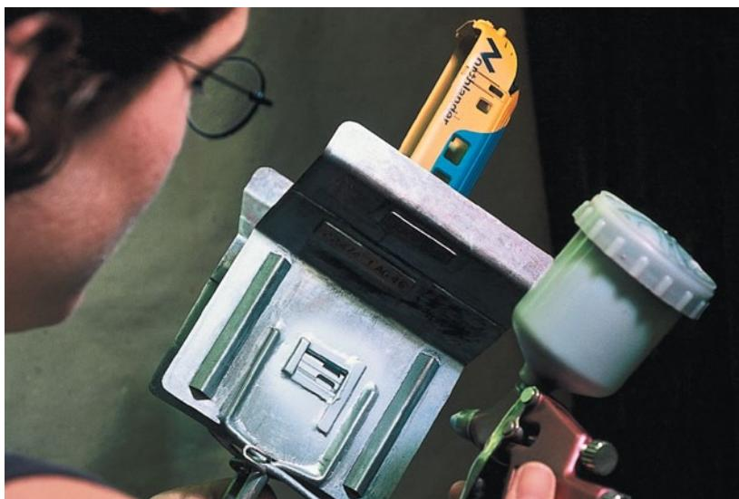
Mehrfarbige Gehäuselackierungen erfolgen mit hochwertigen Lacken, das Modell ist dabei in einer Schablone teilweise abgedeckt.
