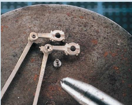
Mit einem kleinen Körner wird der Nietkopf ganz präzise aufgeweitet. Ein leichter Schlag mit einem kleinen Hammer reicht bereits.
