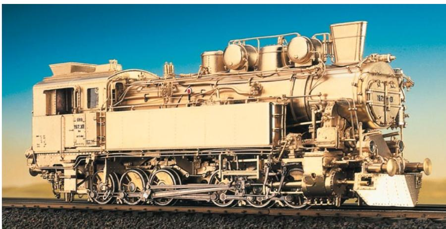
Während der Lokaufbau aus Messing besteht, werden die Radreifen aus Edelstahl gefertigt.
