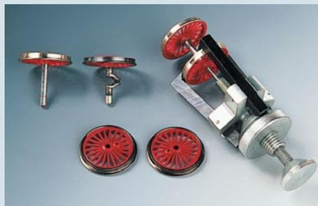
Mit einer Radabziehklau können Räder problemlos demontiert werden. Für die Montage benötigt man ein anderes Werkzeug.
