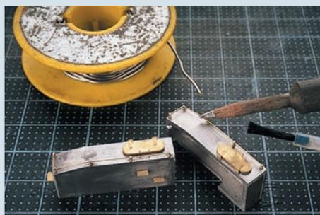
Griffstangen aus Messingdraht sollten generell verlötet werden. Statt Messing eignet sich auch Stahldraht, der zudem stabiler ist.
