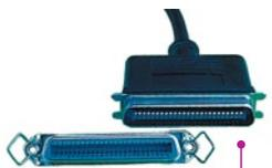
Beim Centronix wird der Stecker durch Drahtbügel beidseitig am Sockel fixiert. Im Bild eine Type mit 50 Polen in drei Reihen.
