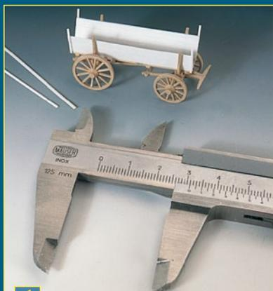
**1** Der H0-Kastenwagen von s.e.s. erhält einen höheren Kastenaufbau aus 0,5-mm-Polystyrol-Platten und -leisten.
