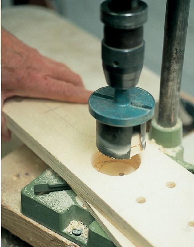
3 Beim Kreisbohrer hebt sich der ausgesägte Kreis mit heraus.
