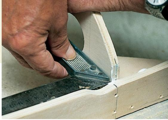
7 Der Einbau des Spantes wird mit dem Anschlagwinkel kontrolliert.
