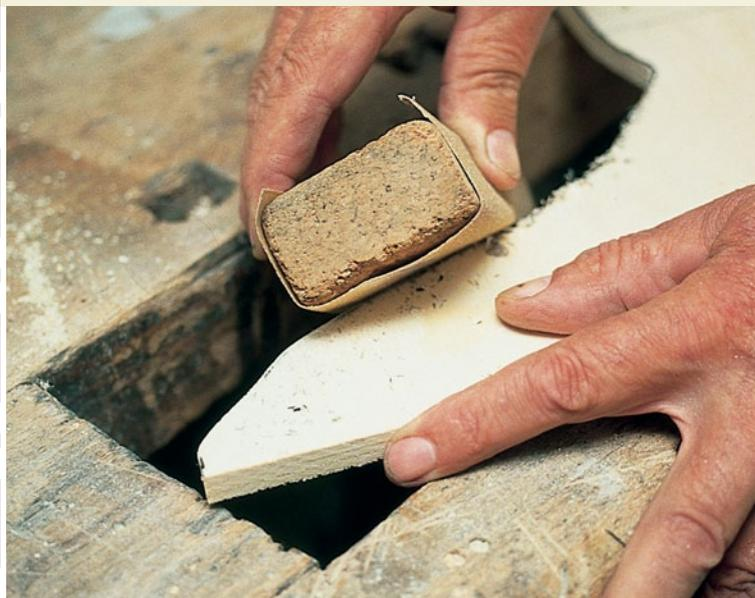
4 Die Sägekanten sollten durch Schleifen unbedingt gebrochen werden.
