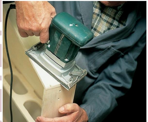
8 Mit einem elektrischen Schwingschleifer lassen sich größere Flächen abschleifen und glätten.
