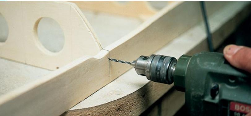
6 Die Bohrmaschine ist beim Bohren möglichst gerade zu halten.
