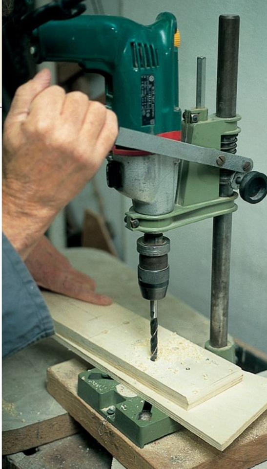
1 Exakt vertikale Bohrungen gelingen mit einem Bohrstander. Hier lassen sich auch mehrere Bretter gemeinsam bohren. Es empfiehlt sich beim Durchbohren die Verwendung einer schützenden Unterlage.
