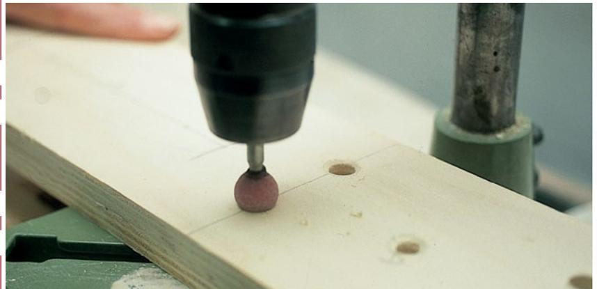
2 Die Bohrlöcher sollte man im oberen Bereich erweitern, damit sich Schraubenköpfe versenken lassen. Hier übernimmt ein steinerner Kugelfräser die Arbeit.
