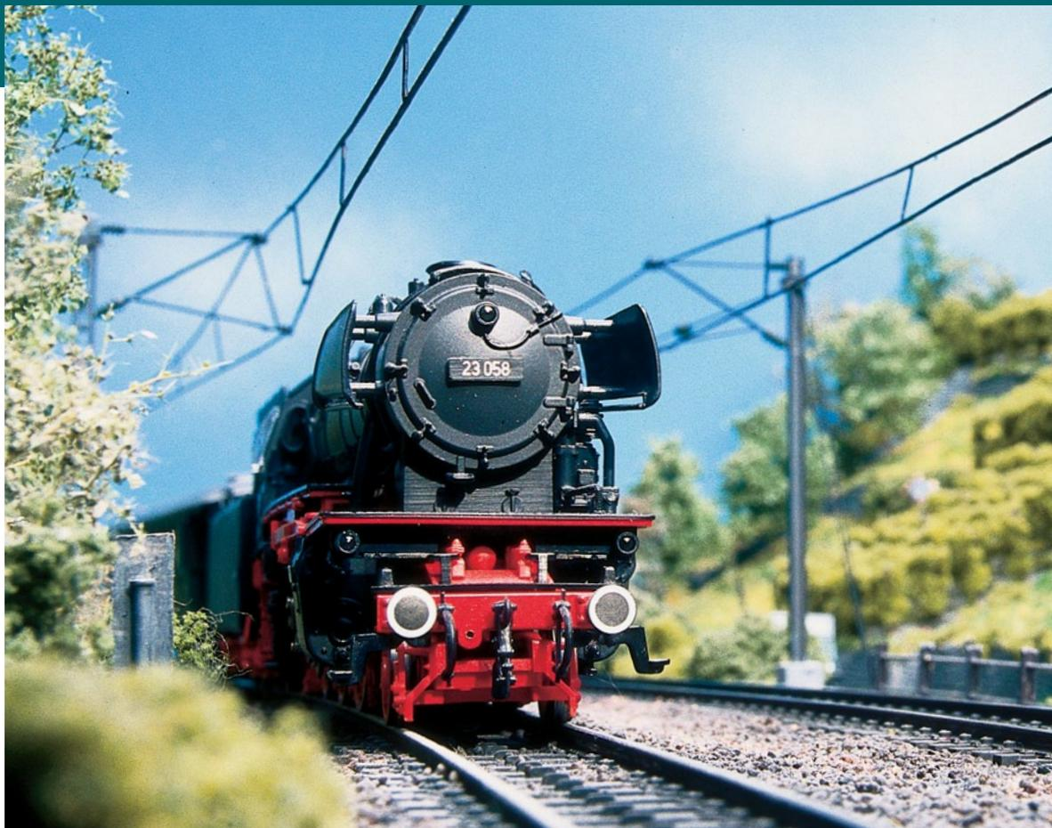
Eine Grundsatzentscheidung betrifft das Stromsystem. Hier die Dreileiter-Wechselstrom-Bahn.
