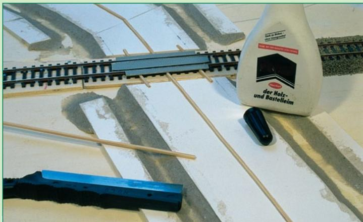
**2** Dünne Holzleisten, die mittig unter die Straße geklebt werden, bilden die Grundlage für die Straßenüberhöhung (Wölbung). An Bahnübergängen führt man die Straße eben an das Gleis.
