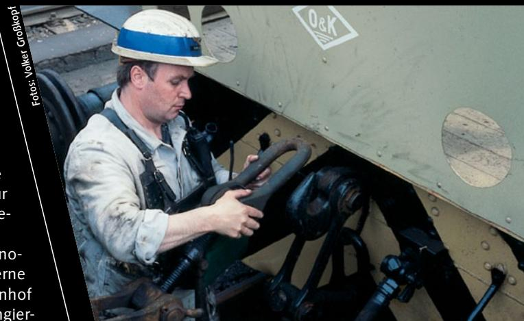
An einer Dummy-Lok demonstriert ein Funklokführer das Einhängen der Kupplungsöse.
