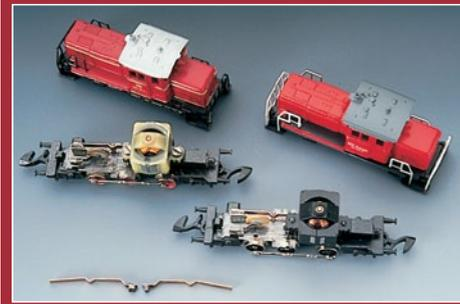
Bei der neu roten V 60 steckt unter der Haube ein neuer Motor mit fünf Ankern.
