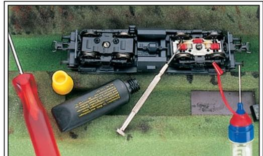
Zur Schmierung erhalten die Achslager einen Tropfen Öl aus einem Mikro-Öler und das Getriebe etwas Spezialfett.
