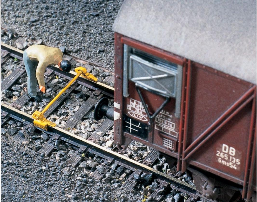
Doppelhemmschuhe dienen ausschließlich zur Sicherung von stehenden Fahrzeugen.
