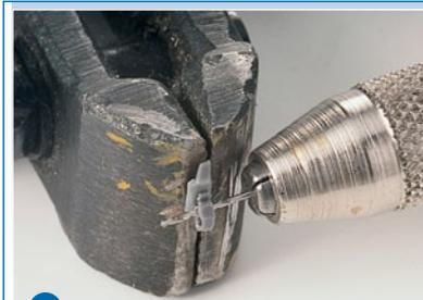
1 Mit einem 0,8-mm-Bohrer wird in jeden Hemmschuh ein Loch für einen 0,8-mm-Draht gebohrt.
