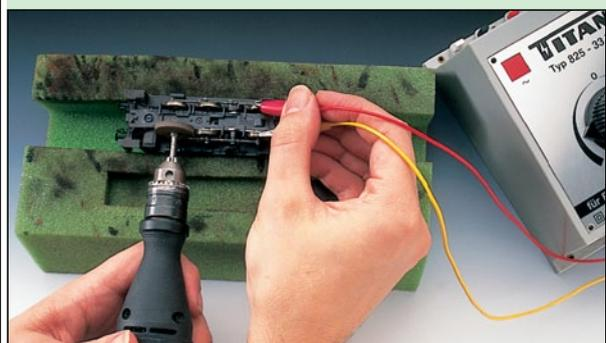
Eine rotierende Gummischleifscheibe entfernt auch eingebrannten Schmutz von den Rädern.
