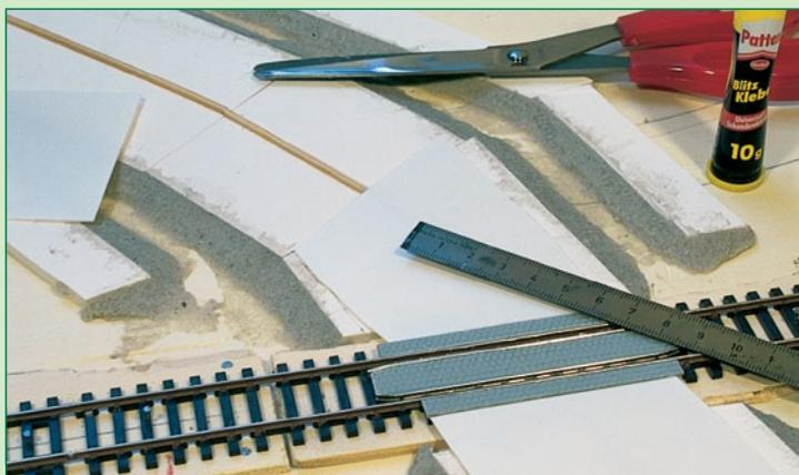
**3** Dünne Kunststoffplatten bilden die Fahrbahn. Sie werden mittig so über die Leiste geklebt, daß eine leichte Wölbung entsteht. Am Gleis paßt man sie an das Schienenniveau an.
