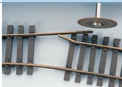
Ein Flexgleis wird sauber getrennt, schräg angeschliffen und gebogen.
