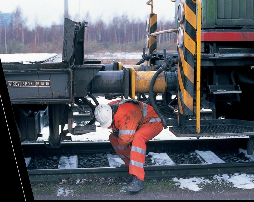
Der Rangierer hat den Kupplungshaken eingehängt und die Bremsschläuche verbunden. Jetzt kann er den Raum zwischen den Puffern wieder verlassen.
