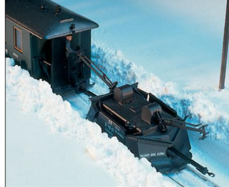
Bei bereits passierbaren Strecken wird die Fahrinne mit diesem gezogenen Spurpflug merklich verbreitert (H0e-GI Modellbau).
