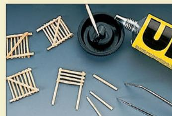
Die Gitter aus senkrechten und waagerechten Latten werden mit einer Diagonalen versteift.
