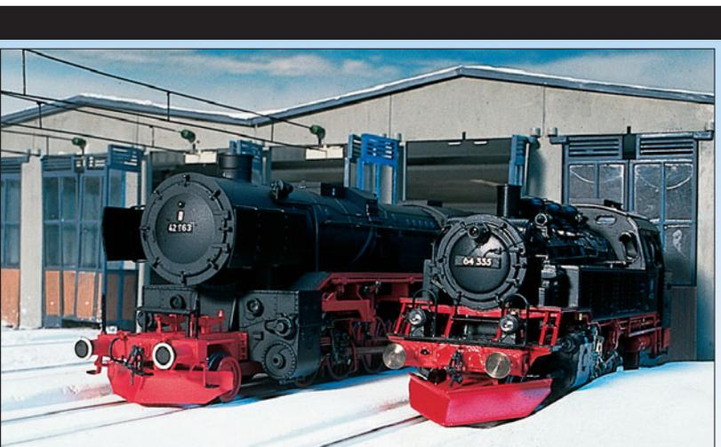
Einige Lokomotiven werden schon im Herbst mit separat montierbaren Schneeräumern ausgestattet (rechts Vorsatz H0-Günther).
