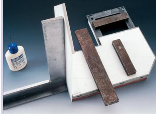
**4** Mit Hilfe eines Anschlagwinkels wird die Giebelwand ausgerichtet und exakt rechtwinklig an die Bodenplatte geklebt.
