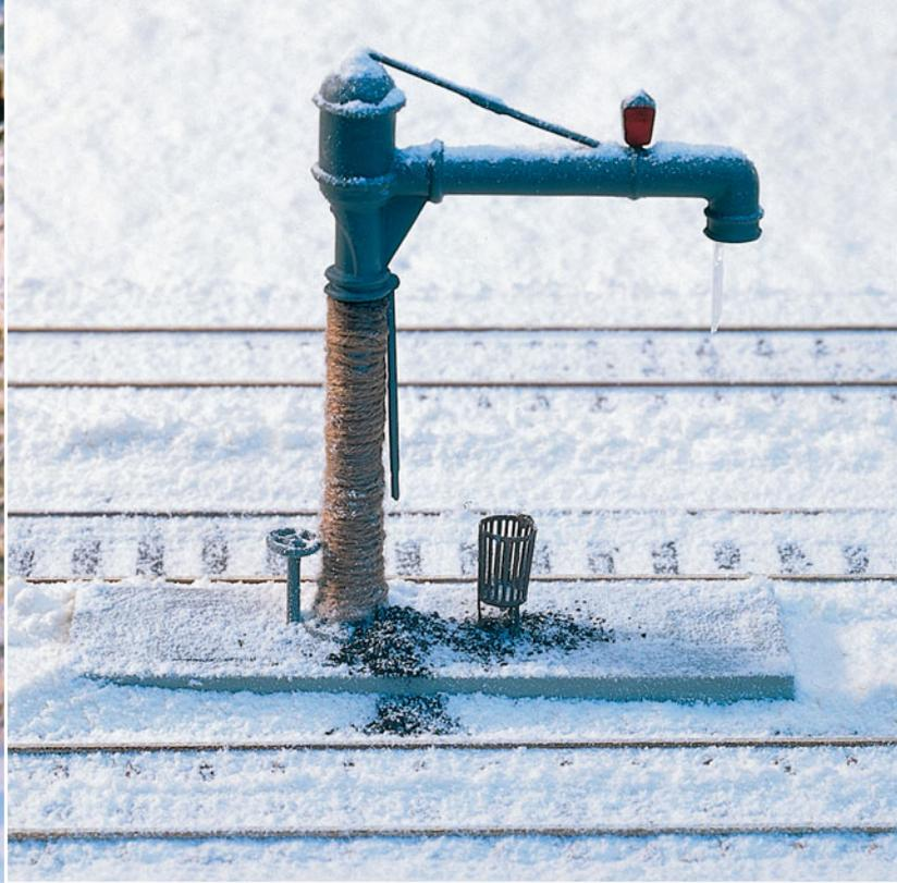
Einsam steht der mit Hanf umwickelte Wasserkran zwischen den Gleisen. Trotz dieses Frostschutzes, und weil der Feuerofen unterhalb des schwenkbaren Auslegers erkaltet ist, hat sich am Auslauf ein Eiszapfen gebildet.
