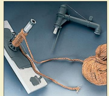
Die Hanfwicklung um das Standrohr eines Wasserkrans läßt sich mit Häkelgarn nachbilden.
