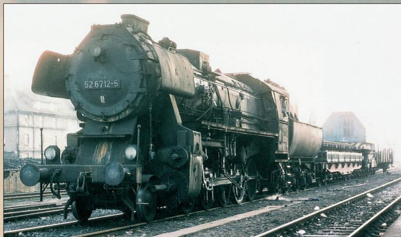
Die Deutsche Reichsbahn in der DDR konnte jedoch aus Mangel an Lokomotiven der Baureihen 44 und 50 auf die 52er nicht verzichten und nahm konstruktive Änderungen vor. Ab 1958 unterzog sie etliche Loks einer sogenannten Generalreparatur, bei der die kriegsbedingten Vereinfachungen und
