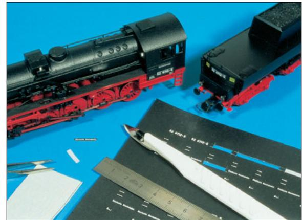
Die Epoche-4-Beschriftungen für die Lokomotive werden am PC erstellt und mit einem Skalpell und einem Stahllineal sauber ausgeschnitten.
