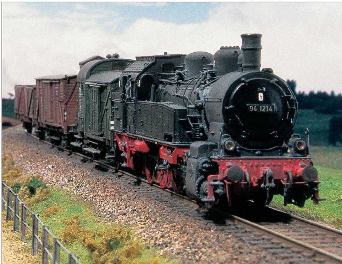
Hersteller aus aller Welt rüsten Fahrzeuge ab Werk mit Rädern nach NEM aus. Dadurch lassen sie sich ohne Anpassungsarbeiten zusammenschließen.
