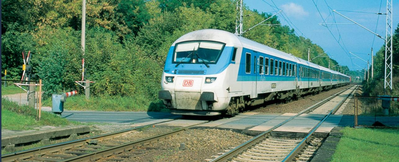
Deutlich ist das rechte, ausgebesserte Gleis zu erkennen. Dagegen liegen unter dem linken Gleis noch Holzschwellen.
