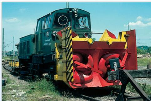
Die Schneeschleudern der Firma Beilhack sind mit zwei kleinen Schneefräsen ausgestattet.
