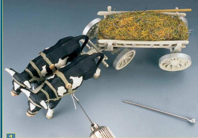
**1** Kleine Löcher sind für das Verspannen der Tiere erforderlich. Mit der Spitze einer Nadel körnt man vor, damit der Bohrer nicht abgleiten kann. Die Löcher für die Drahtösen bohrt man mit einem 0,5-mm-Bohrer.
