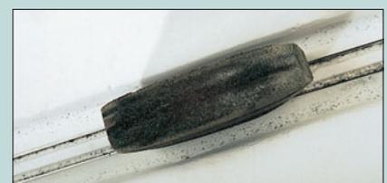
**16** ...und reibt die Schienen zur besseren Kontaktaufnahme mit einem Schienenrubber blank.
