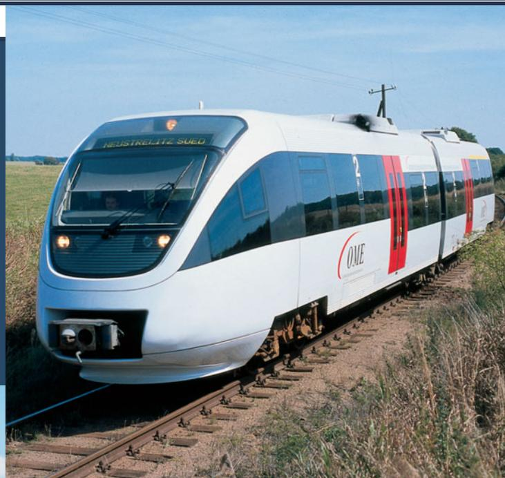
Auf der Nebenbahn zwischen Neustrelitz-Süd und Feldberg lagen auch 1998 noch in Kies verlegte Holzschwellengleise (oben). Im Bahnhof Alt-Hüttendorf liegen Betonschwellen in Kiesbettung (links).
