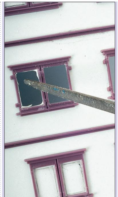
**8** Mit einer Dreikantfeile werden die Bruchkanten bündig am Fensterrahmen begradigt.
