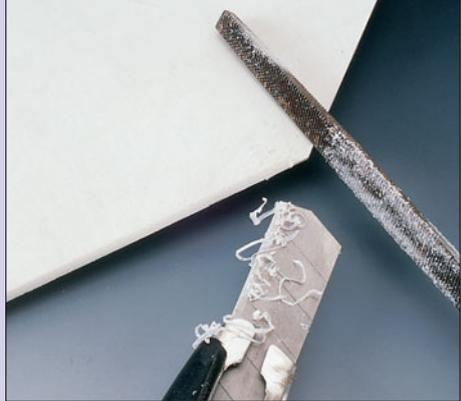
**2** Die Seitenkanten erhalten durch Feilen und Schaben eine 45-Grad-Fase für die Klebung der Seitenwände.
