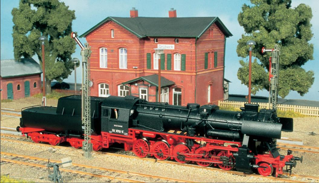
Hauptluftbehälter, Mischvorwärmer und Giesl-Ejektor sind typisch für die generalreparierten Maschinen.
