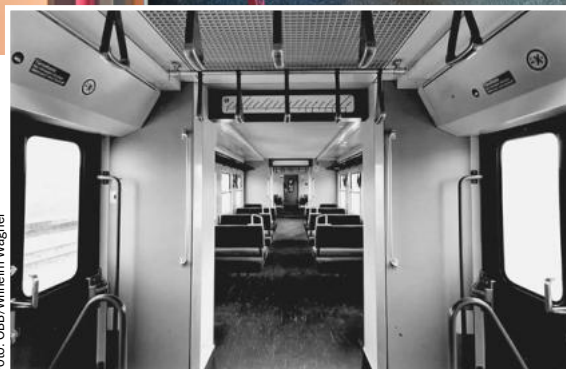
Nur wenig unterscheiden sich die jetzigen 4020 vom Ablieferungszustand. Bis auf die Kopfstützen, die Fenster in den Trennwänden und einem neuen Fußbodenbelag sehen sie aus wie früher. Auch die von der Decke baumelnden Haltegriffe sind nach wie vor vorhanden.
