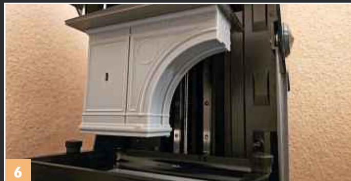
6 Abhängig von der besseren Druckrichtung hängen die Bauteile mal kopfüber, mal richtig herum im Drucker.
