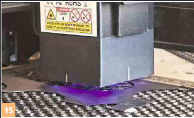
Der Diodenlaser beim Schneiden von 0,25 mm dickem Polystyrol.
