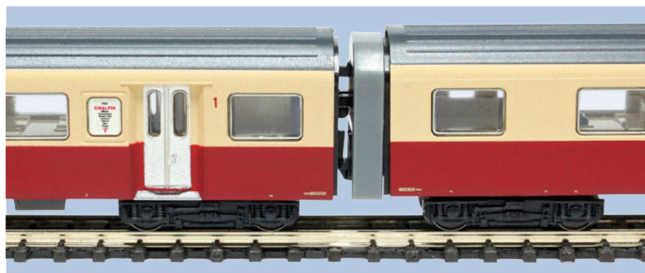
Das Bild zeigt die knifflig zu handhabenden Übergänge, die exakt einrasten müssen.
