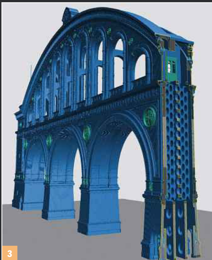
3 Der Schnitt zeigt die wabenartige Struktur des Ostturms.
