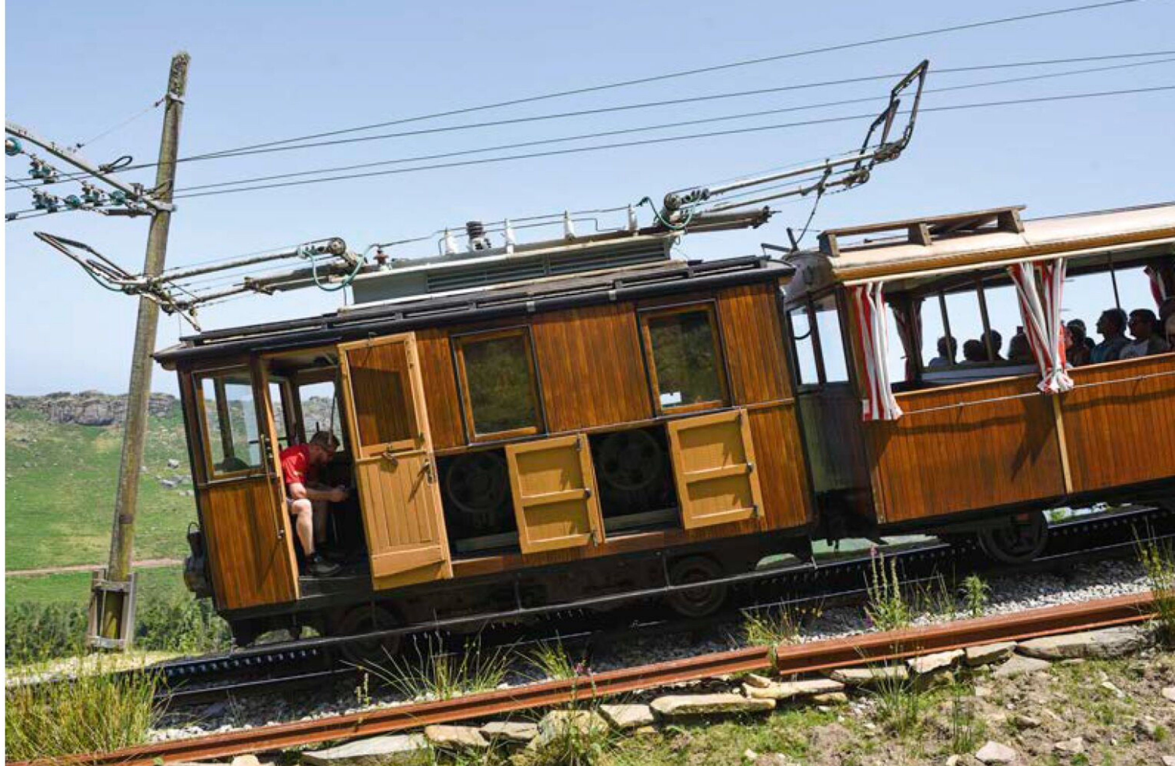
Bei der Bergfahrt übernimmt das Personal vorne auf dem führenden Wagen die Streckenüberwachung. Der Lokführer überwacht die Kühlung durch alle offenen Luken.
