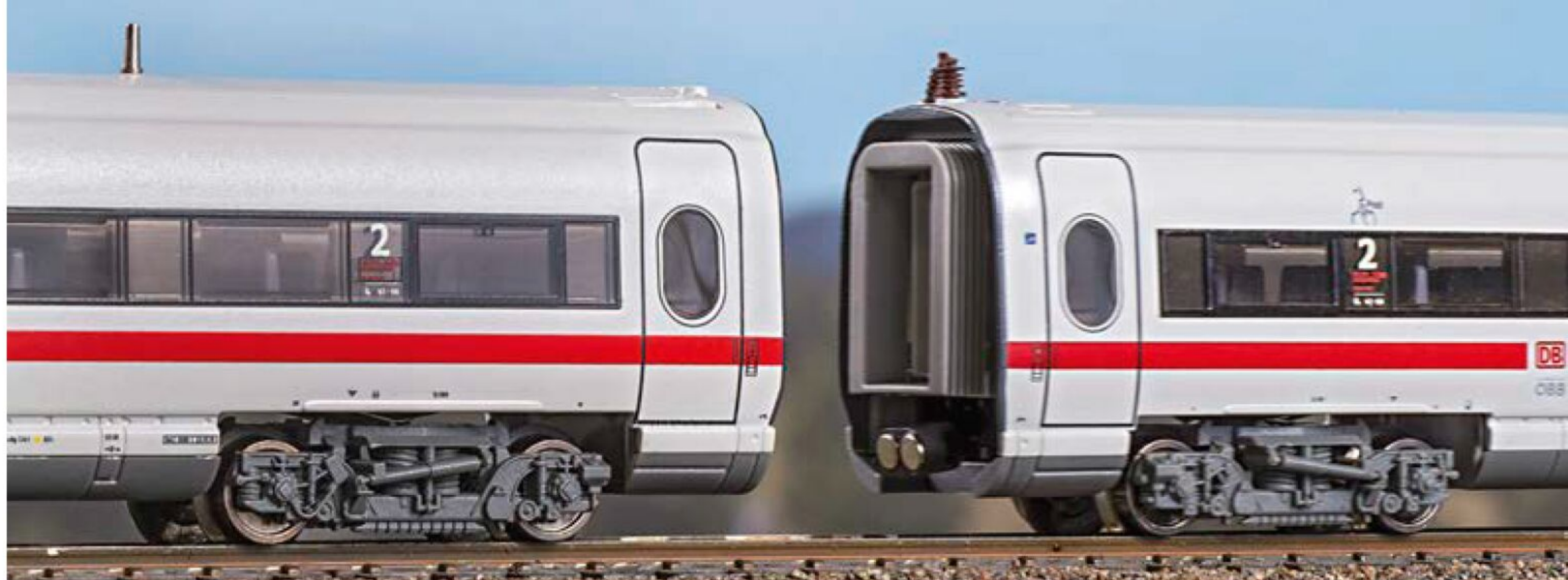
Ab Werk mit Stangenkupplungen ausgerüstete Triebzüge wie der ICE-T von Fleischmann sind für den Einsatz der Magnetkupplungen prädestiniert.
