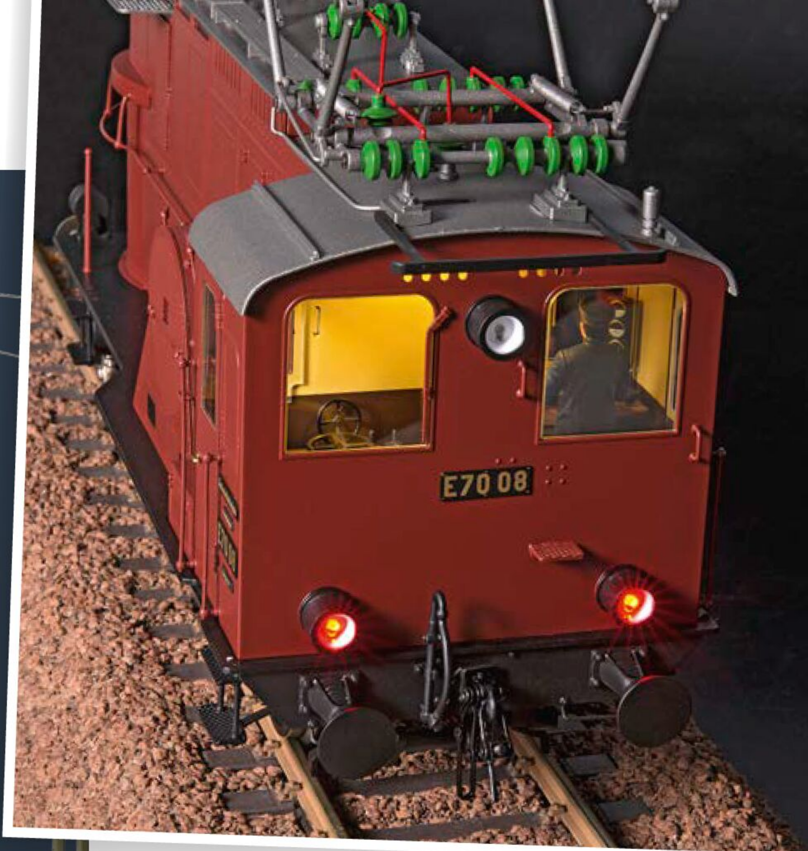
Im Nachtbetrieb überzeugen das Spitzen- und Schlusslicht und die Führerraumbeleuchtung, auch das Fahrpult für den damals noch stehenden Lokführer lässt sich effektiv beleuchten.
