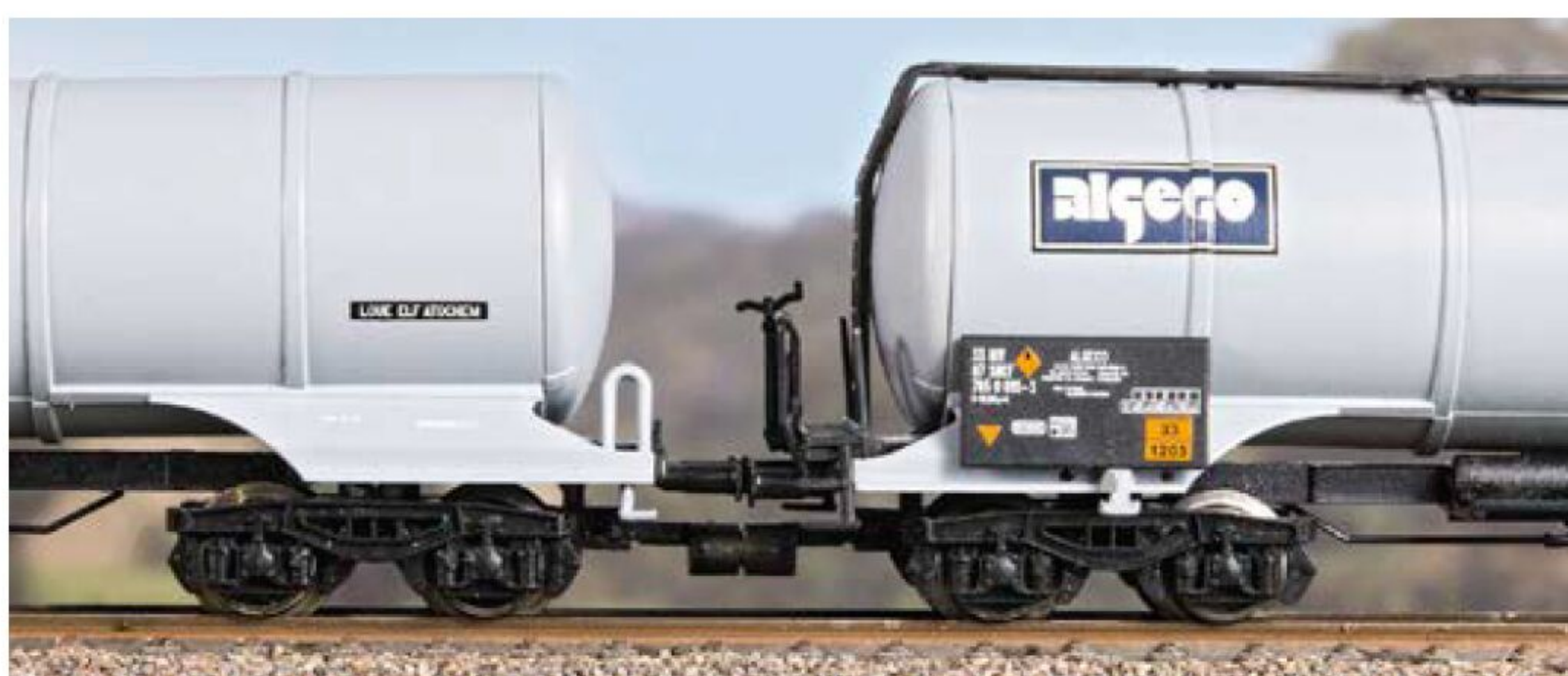
In Abhängigkeit von den auf der Anlage verbauten Radien lassen sich auch sehr enge Kuppelabstände realisieren.
