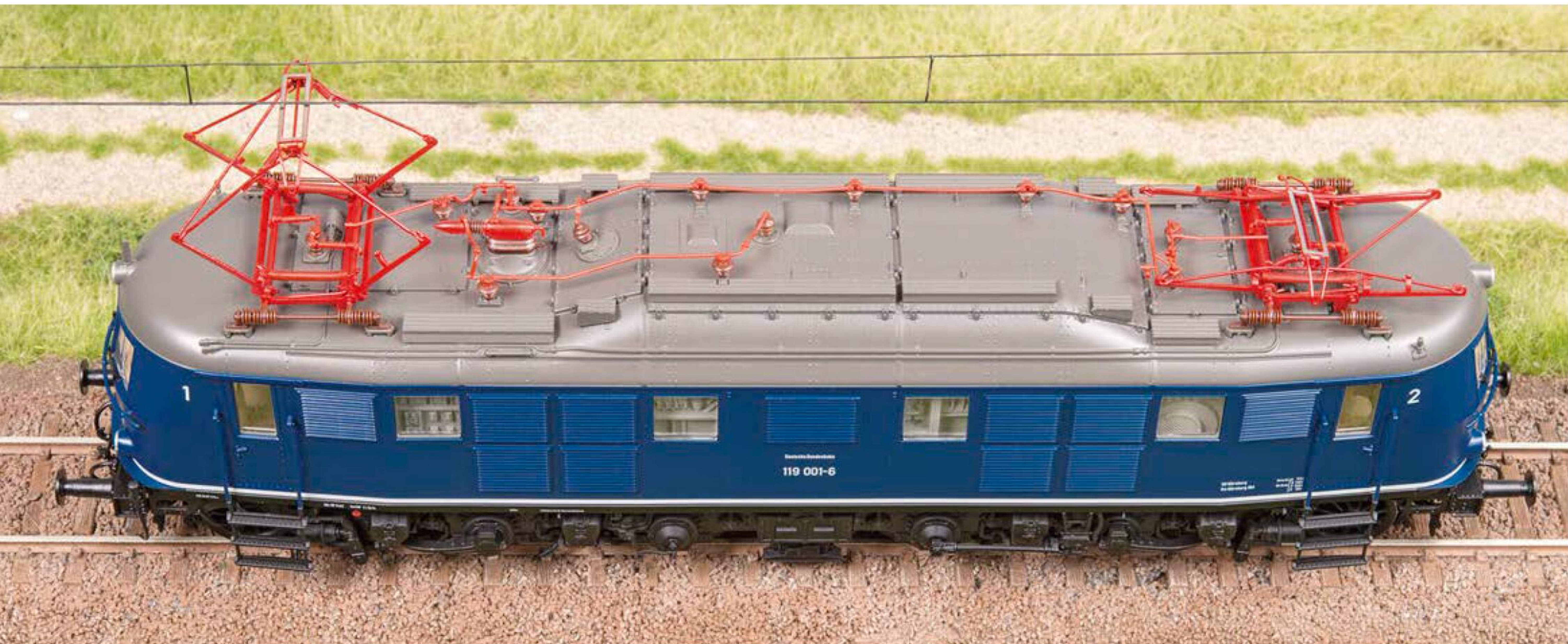
Die Dachausrüstung wird durch die von der DB im Jahr 1965 montierten Stromabnehmer der Bauart SBS 10/54 mit eingezogener Oberschere und Doppelschleifleiste bestimmt. Sie erlaubten das Fahren mit nur einem angelegten Stromabnehmer.
