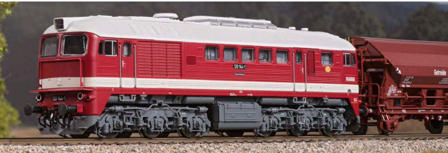
Diese 120 „trommelt“ noch ziemlich, denn auf dem Dach befindet sich der Schalldämpfer aus Luhansker Produktion.
