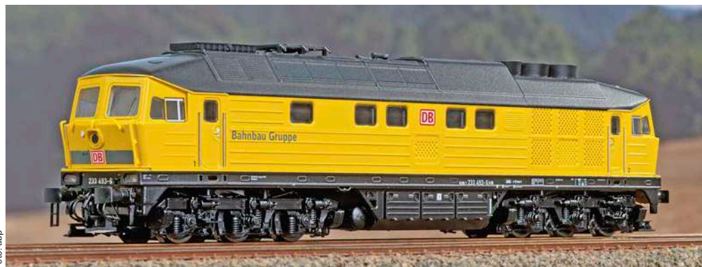
Die Roco-Nachbildung des „Tigers“ 233 493 der Bahnbau Gruppe zeigt die Ausführung vor dem Umbau, die seitlichen MD-Lüftungsgitter fehlen. Auf dem Dach sind hinten im Unterschied zur oben abgebildeten Lok die großen Siemens-Lüfter zu erkennen.
