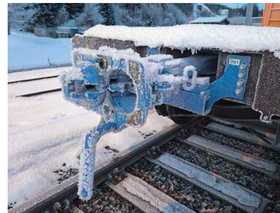
Auch Schnee und Eis konnten den DAK nichts anhaben. Auf dem Bild ist eine Kupplung des Herstellers Dellner zu sehen.
