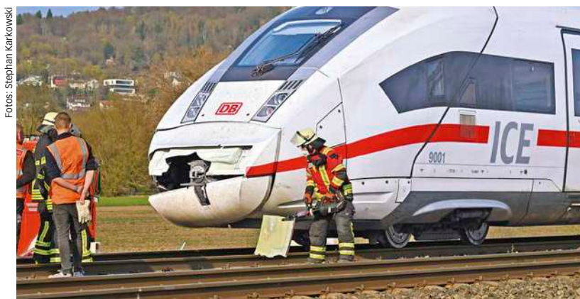
Die Feuerwehr Gelnhausen entfernt mit schwerem Gerät Stück für Stück die Bugklappe, die sich nach der die Kollision nicht mehr öffnen ließ.
