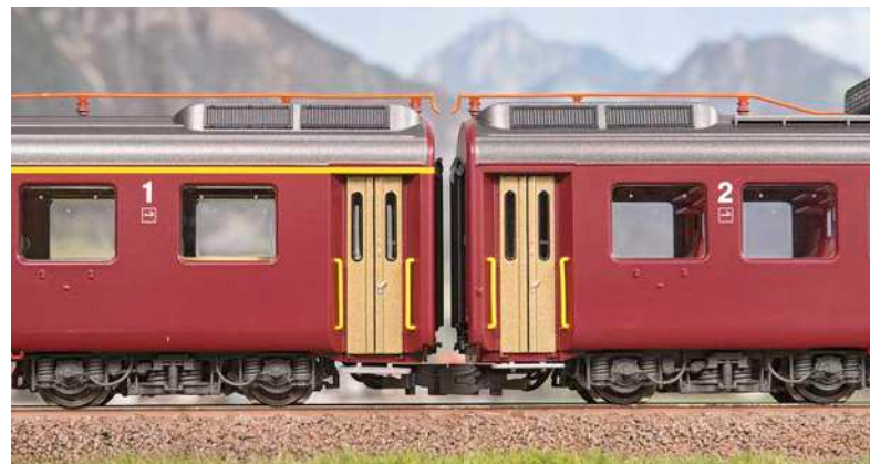
Die Fahrzeuge sind mit einer stromführenden Kupplung schön eng verbunden. Besonders die markanten Einstiege überzeugen.
