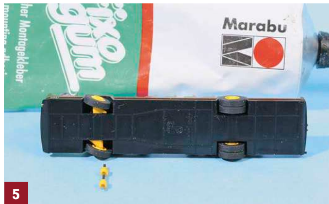
5 Die Vorderachse kann in Geradeausfahrt oder nach rechts oder links abbiegend montiert werden. Verwendet man Fotokleber, lässt sich deren Einstellung später noch verändern.
