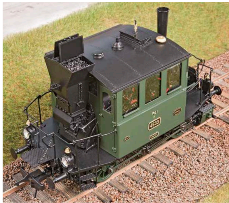
Auch die Klappen für Kohle, Wasser und Sand können geöffnet, die Übergangsbleche zum Zug heruntergeschwenkt werden.
