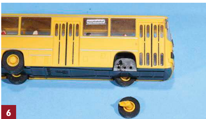
6 Das Chassis weist drei Befestigungen für die Vorderachse auf. Für die Starrachse ist die mittlere Bohrung vorgesehen, die anderen Löcher dienen der Montage für einen Kurveneinschlag.
