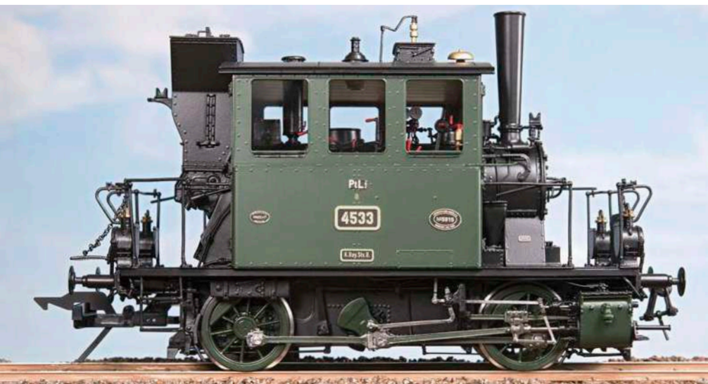
Die typische Blindwelle besaßen nur die 23 Loks des ersten Bauloses von 1908, zu der auch Maschine 4533 gehörte. Das Farb- und Beschriftungsfinish entspricht dieser Zeit.
