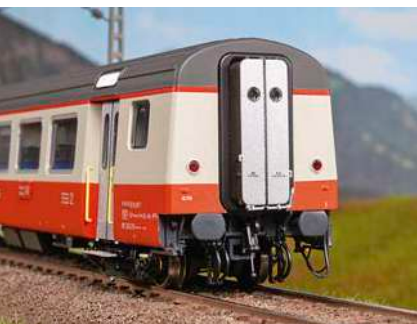
Am Zugschluss wurden die Tunnelübergänge mit einem Deckel verschlossen.
