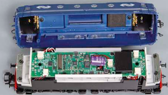
Beim Blick auf die Platine ist der Pufferspeicher gut zu erkennen.
