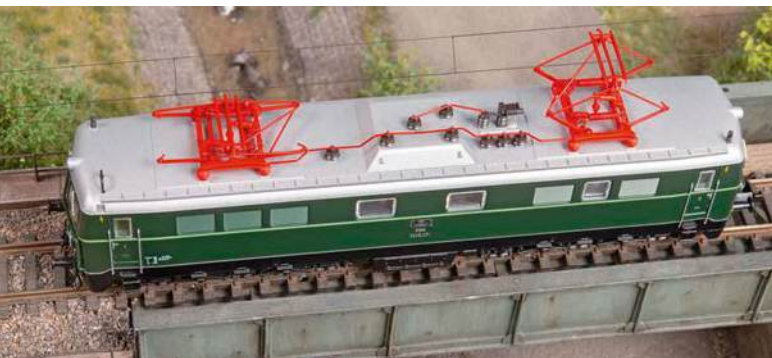
Das Dach ist mit filigranen Details und neu konstruierten Stromabnehmern der Bauart V ausgestattet.
