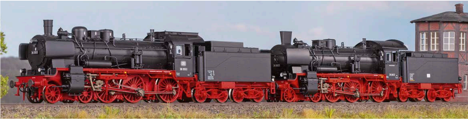
Links 38 3553 der Bundesbahn mit dreidomigem Kessel , rechts 38 2833 der Reichsbahn mit Giesl-Ejektor, beide für die Epoche III.
