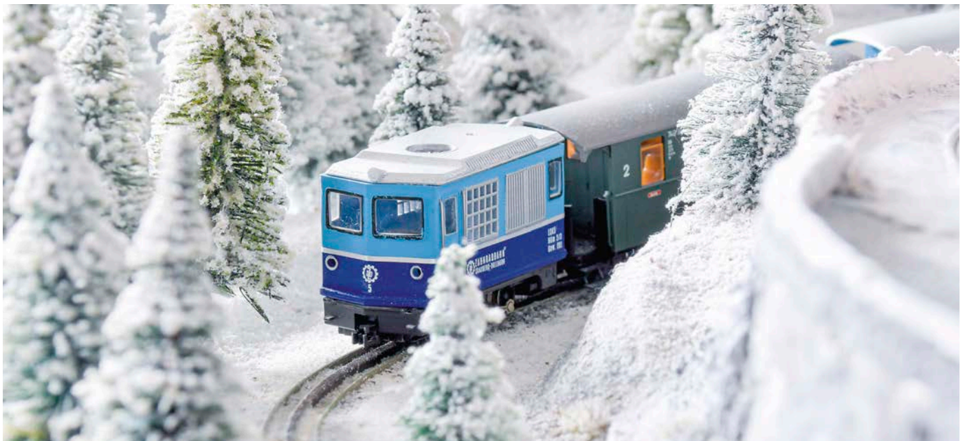
Am Bahnhof „Sandberg“ startet auch die Zahnradbahn zum Dullhorn. Die Lok ist selbst entworfen und mit dem 3D-Drucker produziert.
