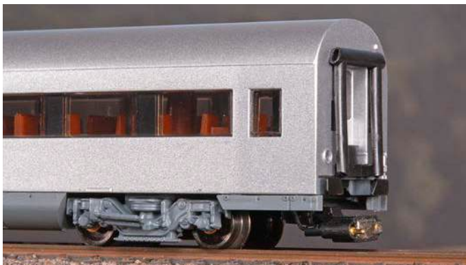
Gut gelöst: Die Stromversorgung läuft über eine Magnetkuppelung. Auch die Zuglok ist einseitig mit dieser ausgestattet.
