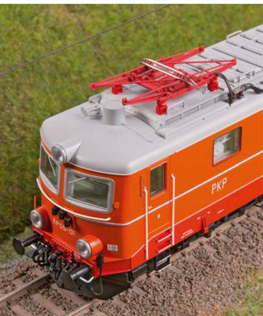
Ein Blick von oben zeigt den sehr feinen und von Roco neu konstruierten Stromabnehmer. Die Zurüstteile werten das Modell zusätzlich auf.
