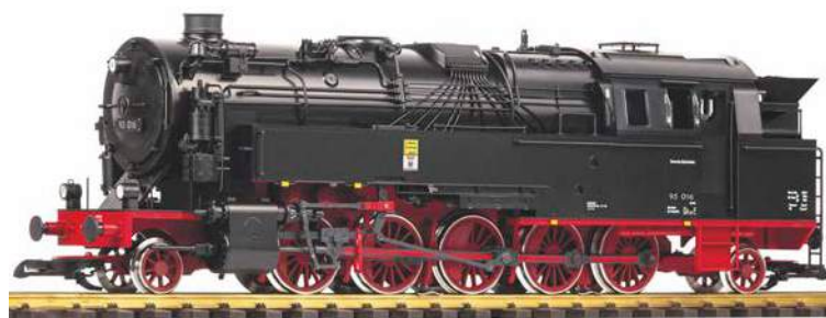
Die Baureihe 95 für die 45-mm-Gleise wird als kohlegefeuerte DR-Maschine der Epoche III mit zweidomigem Kessel aufgelegt.
