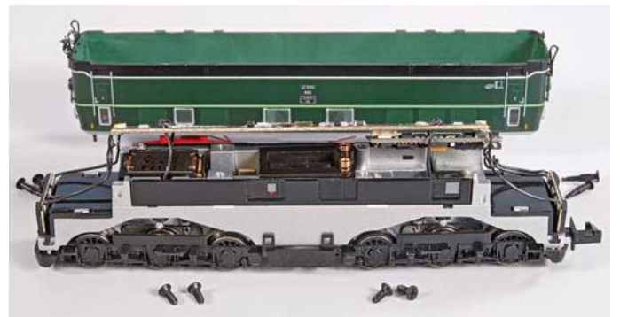
Unter dem Gehäuse befindet sich die mit Schrauben gehaltene Platine. Darunter liegt der Glockenankermotor mit Schwungmasse.
