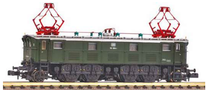
Das N-Modell der Baureihe 116 kommt als Lok der 1970er-Jahre mit dunkel lackierten Rädern und SBS 9/54-Stromabnehmern.
