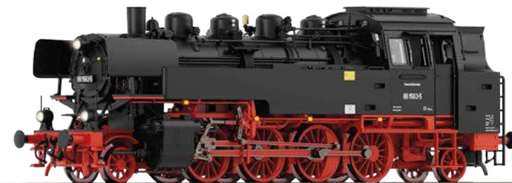
Ebenfalls nach DR-Vorbild: eine 86 mit den typischen kleinen Usedom-Windleitblechen, die vorbildgetreu montiert sind.
