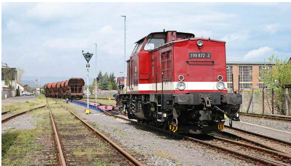
Für den modernen Rollbockverkehr des Systems „Vevey“ zwischen Nordhausen Nord und dem Schotterwerk Unterberg wurden 199 872 und 874 mit Klapppuffern ausgerüstet. 199 872 rangierte am 29. April 2008 an der Rollbockgrube in Nordhausen.
