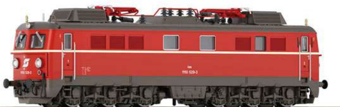
Wichtige Formvariante der ÖBB 1110: 1110.5 mit Dachaufbauten.
