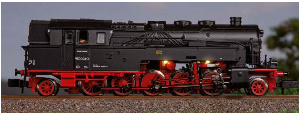
Im Dunkeln ist die neue Triebwerksbeleuchtung gut zu erkennen. Leider fällt aus dieser Perspektive das ganz leicht nach vorn geneigte Lokgehäuse auf.
