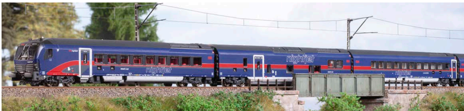
Auch in der anderen Fahrtrichtung sind die unterschiedlichen Ausführungen der Schlaf- und Liegewagen zu erkennen. Hinter dem Steuerwagen mit der typischen Vectron-Formgebung läuft an zweiter Stelle der Multifunktionswagen.
