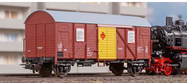
Im DR-Glms [1354] (Modell in H0) wird das hochgiftige Tetraethylblei, das früher weitverbreitete Antiklopfmittel für Benzin, transportiert. Die weißen „Tanktainer“ sind hingegen harmlos, Gefahrguthinweise fehlen jedenfalls auf dem Ladegut des Sggmrs 747 in TT.
