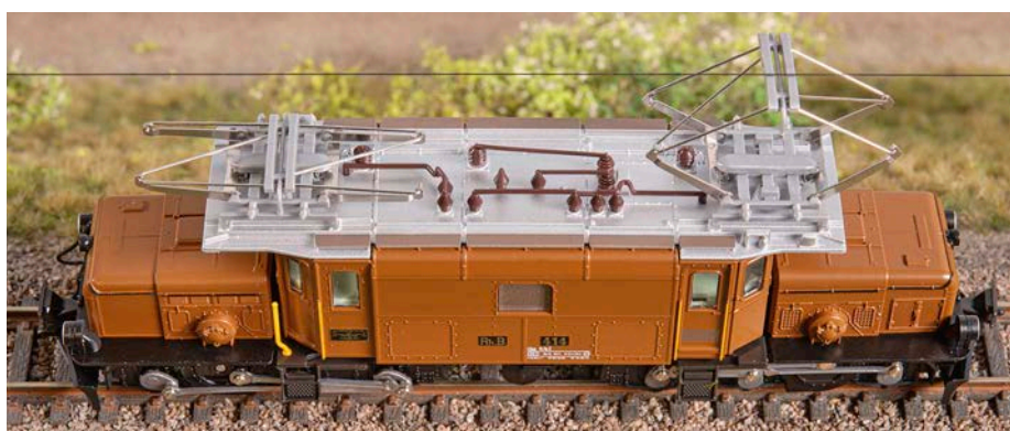
Die Stromabnehmerhöhe lässt sich justieren, das sorgt für problemfreien Betrieb.
