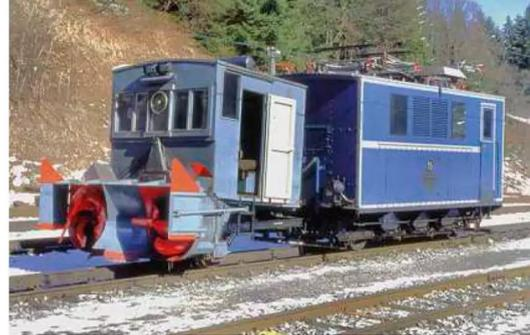
Die erste Anwendung der Beilhack-Hohlschaufelschleuder im Bahnbereich war die Montage an dem aufgesattelten Einachs-Vorstellgerät G 7 der Zugspitzbahn (Räumwerk HB 2 F-Nr.: 21/1952).
