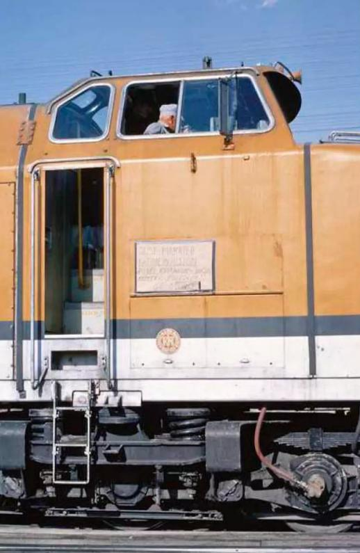
Ein Schild weist auf den Umbau der Steuerung hin, der eine Mehrfachtraktion mit DH- und DE-Loks möglich machte.
