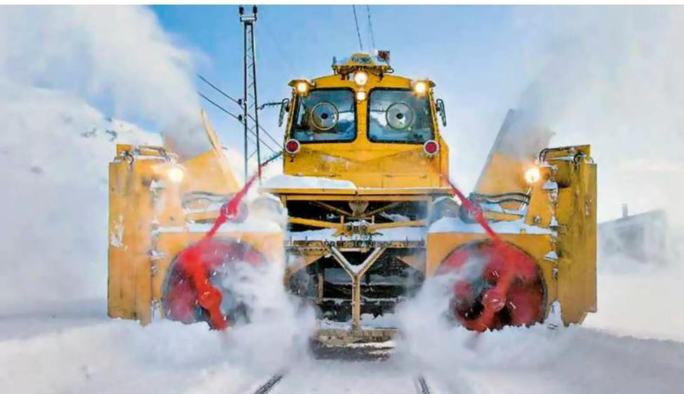
Bei einer Demonstration im Jahr 2007 mit der erneuerten NSB/JBV-Schleuder 0395011 zeigt diese, wie in einem zweiten Räumdurchgang mit seitwärts ausgefahrenen Schleuderhälften die von den Lokpflügen aufgehäuften Randwälle abgetragen werden und der Spurkanal wieder für künftiges Auspflügen verbreitert wird.
