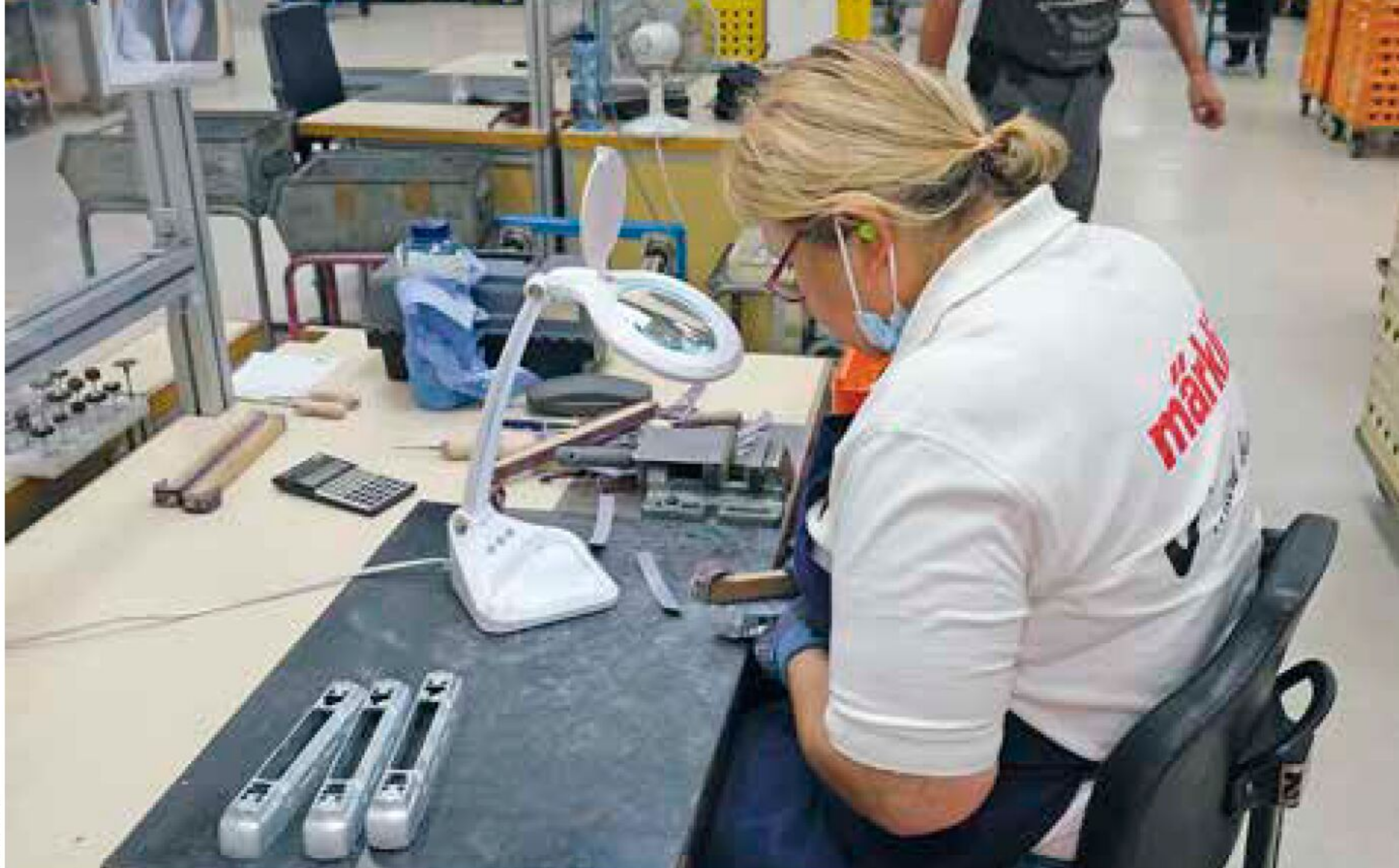
Diese Märklin-Mitarbeiterin beseitigt manuell die Formtrennkanten am Rohling, bevor die Gehäuse zum automatischen Bürsten weitergereicht werden.
