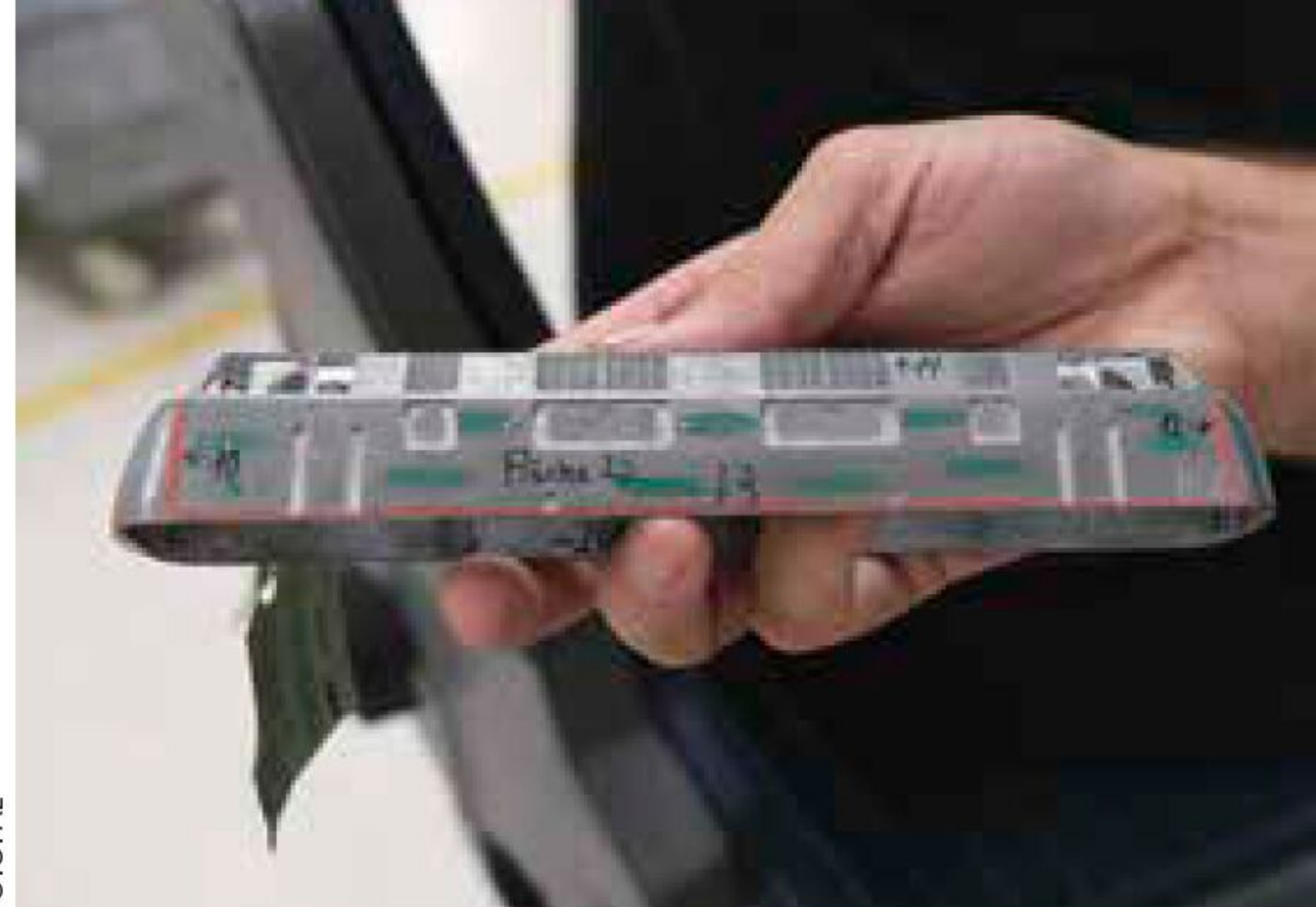
Auf diesem Muster sind die Stellen markiert an denen die unten abgebildete Maschine den Rohling polieren muss.
