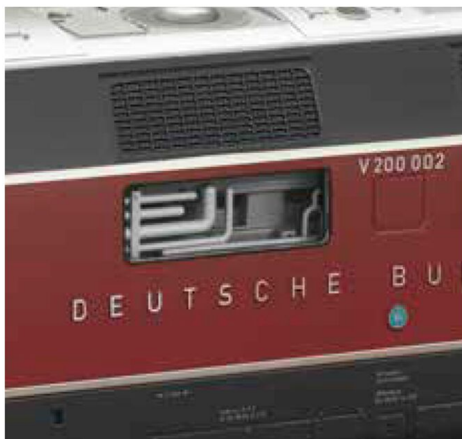
Die erhabenen Buchstaben und das KM-Logo sind in der Gehäuseform integriert. Der Maschinenraum ist plastisch nachgebildet.
