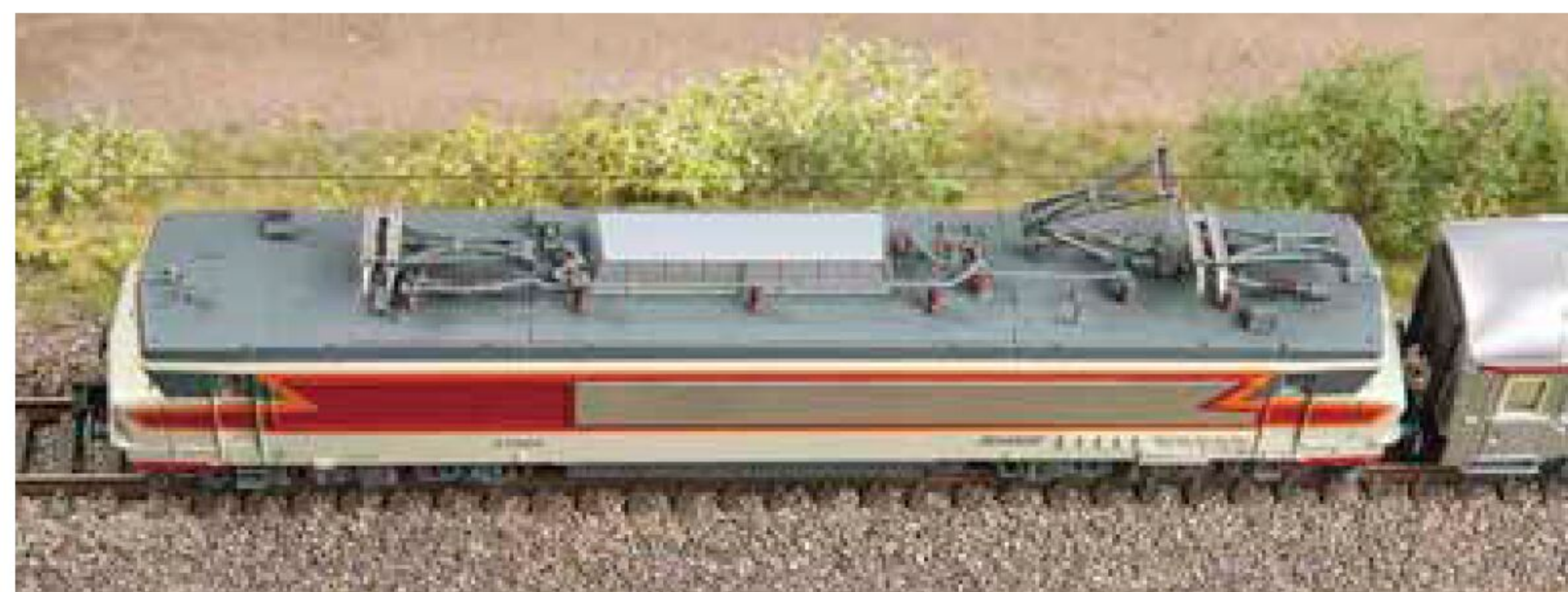
Drei filigrane Stromabnehmer (zwei für DC, einer für AC), feine Dachleitungen und eine Antenne zieren das Dach der CC 21004.
