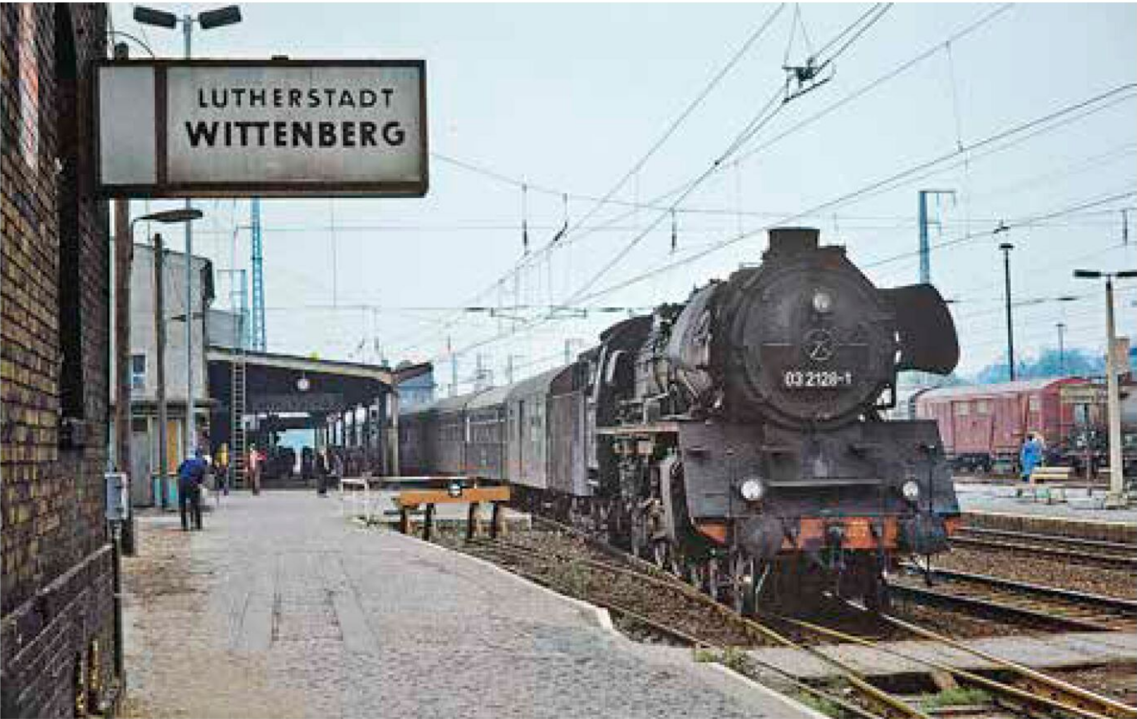
Sieht mit Mischvorwärmer und kleinen Windleitblechen (fast) so aus wie eine Reko-03, ist aber keine: Die „Umbaulok“ 03 2128 gastiert am 18. Mai 1978 im Bahnhof von Wittenberg.
