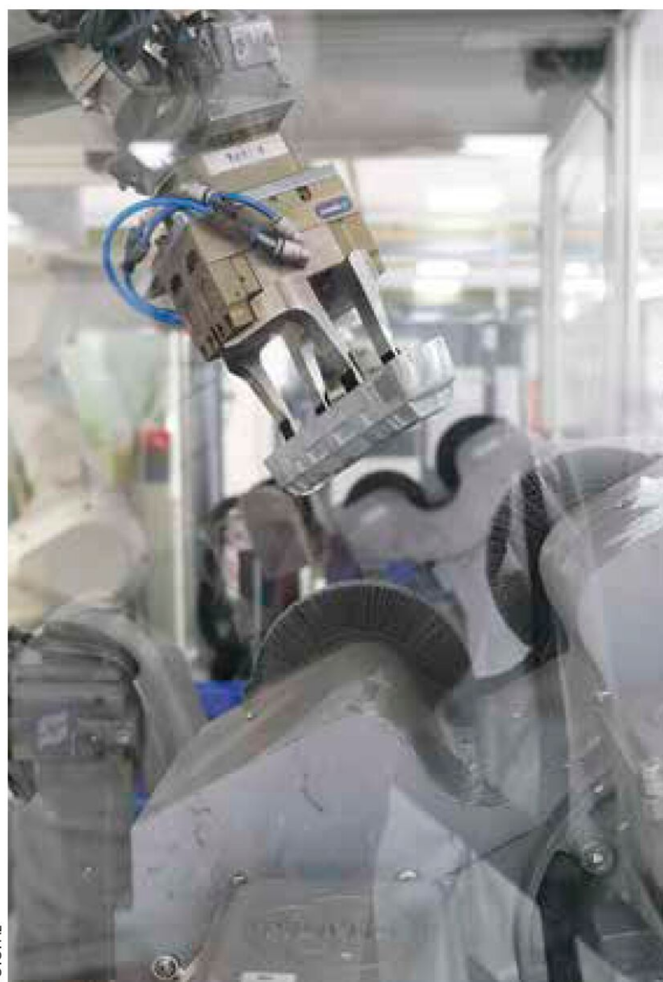
Nachdem zuvor die neuralgischen Stellen aufwendig einprogrammiert wurden, bürstet und poliert der Automat selbständig.
