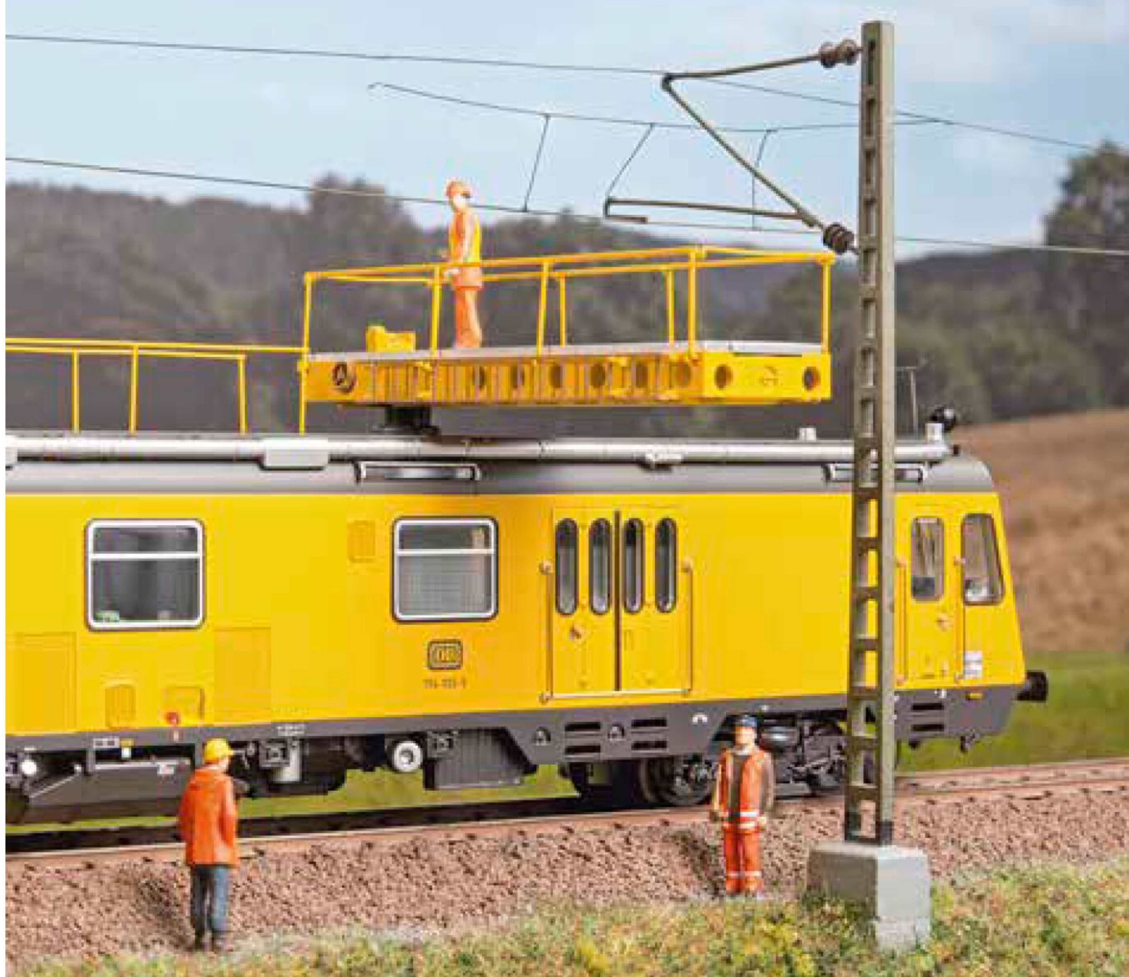
Die Arbeitsbühne ist ausziehbar, nach allen Seiten drehbar und wurde zudem mit klappbaren Geländern ausgerüstet. Das Herausziehen erfordert jedoch etwas sanfte Kraft.
