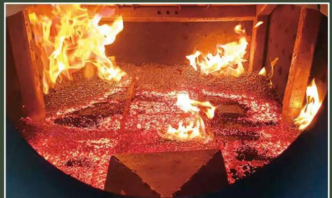
Über den Sommer 2023 führte das Dampftechnik-Startup „Steam Technologies“ Versuche mit Pelletfeuerung auf Dampfloks durch.
