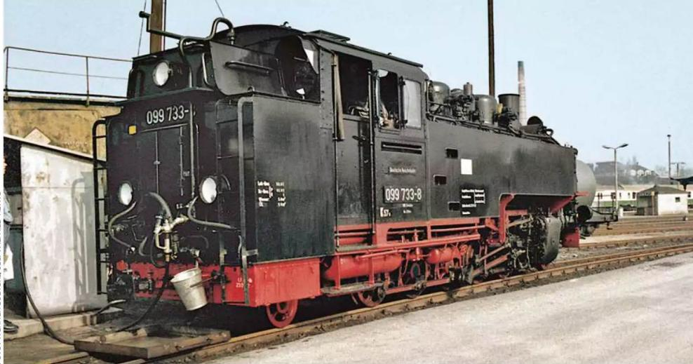
Die frühere 99 760 war 1991 die erste der großen 1'E1'-Schmalspurloks für 750 mm Spurweite, die – fortan als 099 733 bezeichnet – im Raw Görlitz eine Leichtöl-Feuerung erhielt.
