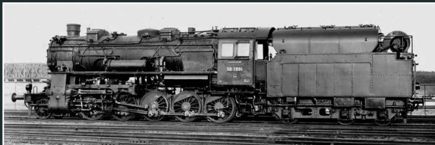
58 1894 erhielt 1930 als sechste Lok ihrer Baureihe eine Braunkohlenstaubfeuerung nach dem System AEG. Zwei Jahre zuvor begannen die Feldversuche mit der Staubfeuerung.
