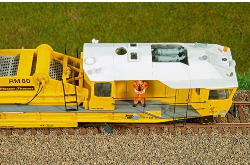
Selbstverständlich ist eine RM 80 motorisiert – zu sehen an der Auspuffanlage. Die Motorleistung von 696 kW wird für den Fahrbetrieb (maximal 80 km/h) und die Hydraulik-Aggregate benötigt.
