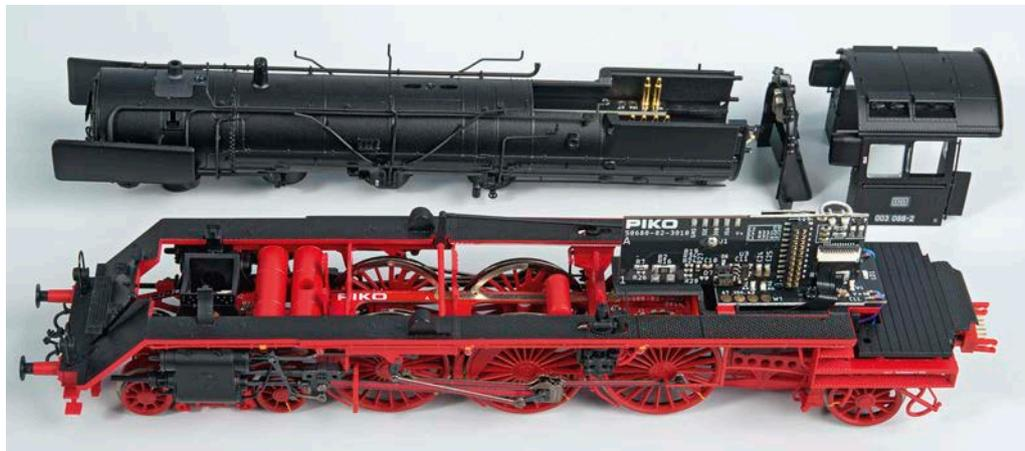
Wie aus Sonneberg gewohnt, ist die Konstruktion wartungsfreundlich ausgelegt: Nach dem Lösen dreier Schrauben ist die PluX22-Digitalschnittstelle im Stehkessel zugänglich.
