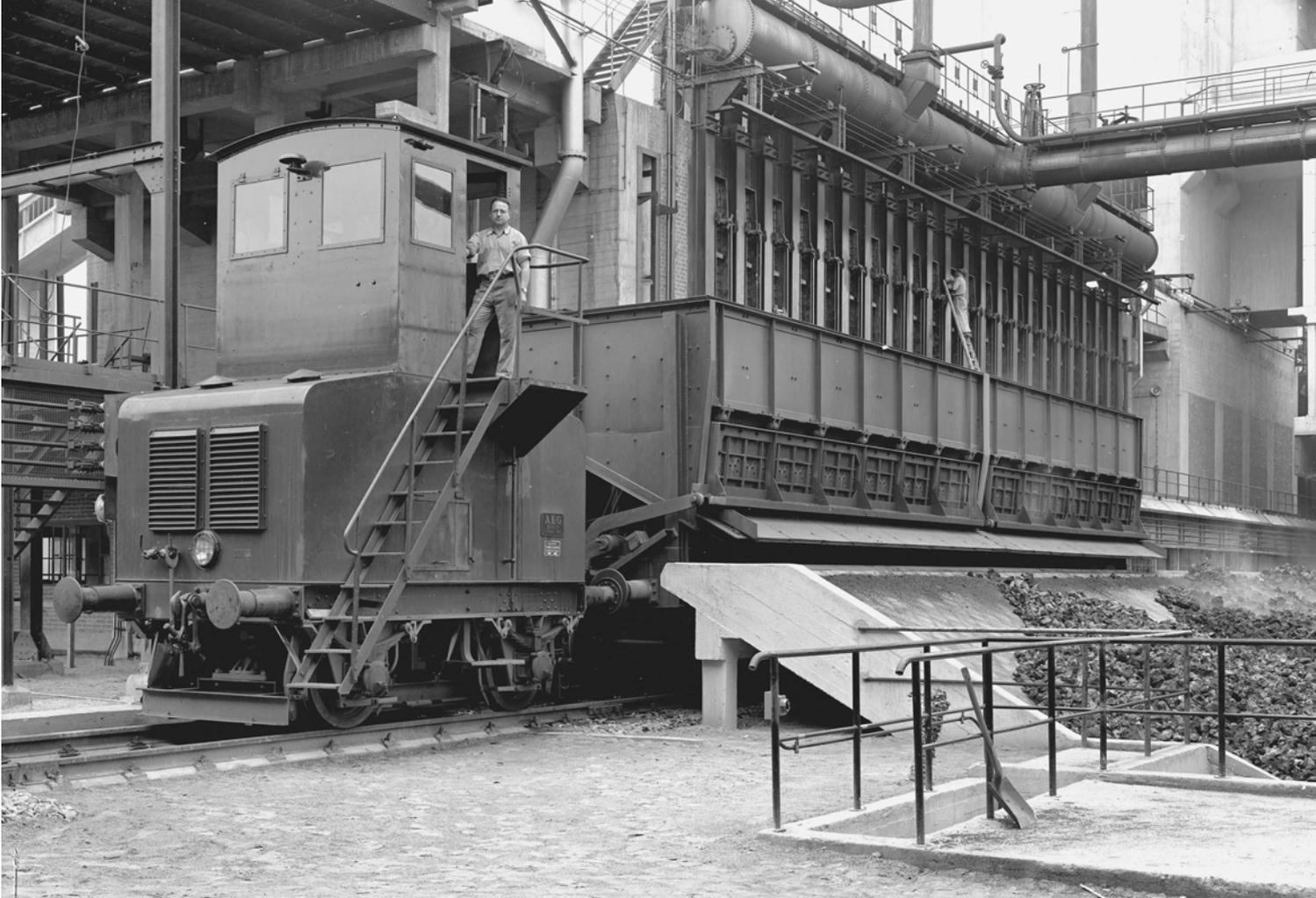
Diese AEG-Kokslöschlokomotive, die ebenfalls 16 Tonnen auf die Waage brachte, ist ein Nachkriegs-Produkt und wurde mit 380V/50Hz Drehstrom betrieben. Sie zieht hier zwei Kokslöschwagen vor den Koksofen der Gaswerke Berlin-Mariendorf (AEG-Werkfoto um 1955).
