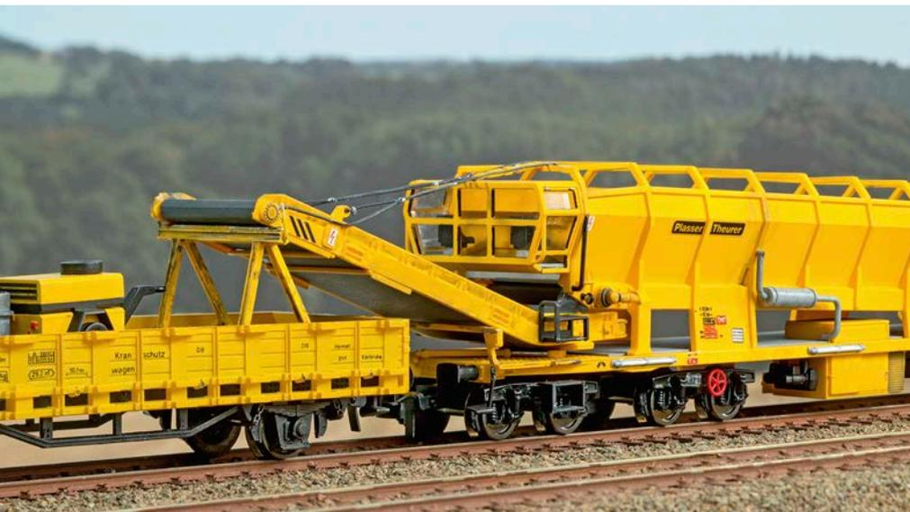
Am Ende des Bauzuges ist ein Zwischenwagen notwendig, um das Förderband des letzten MFS-Wagens ablegen zu können. Der Nachbau basiert auf einem Roco-Modell.
