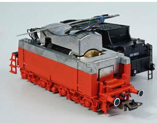
Der mit zwei sehr großen Schwungmassen versehene Motor sitzt im Tender und treibt die beiden äußeren Radsätze an.
