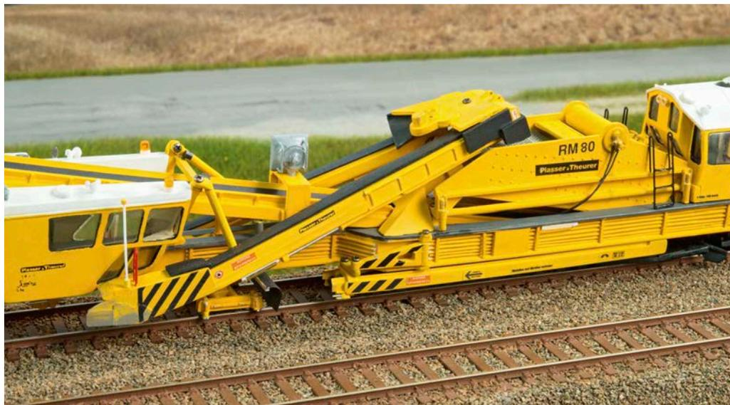
Im zentralen Bereich der RM 80 sind die Förderarme zu erkennen, die den Abraum zu der großen Siebeinheit fördern. Von dort führt ein Förderband nach hinten.
