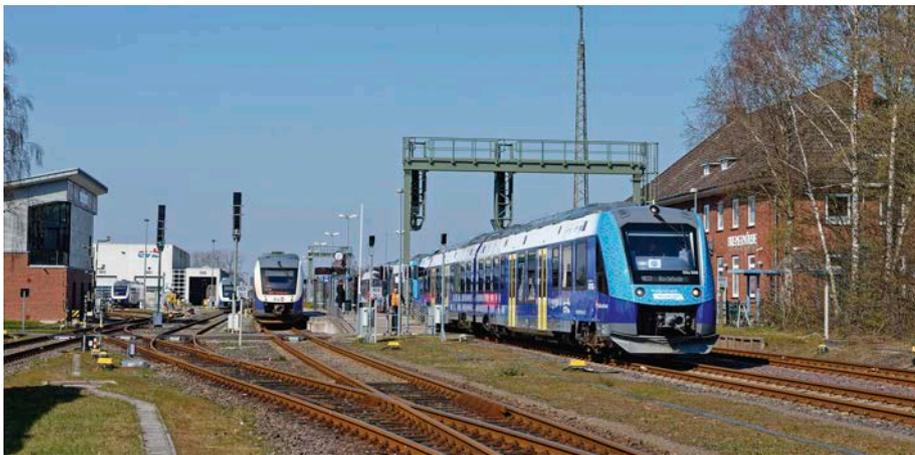
Generationen-Begegnung am Bahnhof BremerVörde: Dieseltriebwagen des Typs Alstom-Lint41 (links) und Wasserstoffzug Alstom-Coradia-iLint (rechts).
