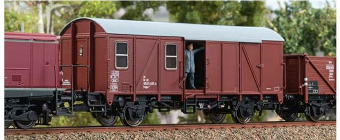
Der Epoche IV-Wagen (Art.-Nr. MU-H0-G55013) besitzt schon Rollenachslager. Die Türen lassen sich bei allen Ausführungen öffnen.
