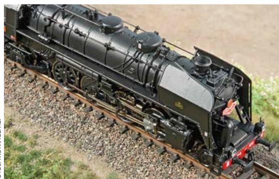
Mit Boxpok-Kuppelradsätzen und Scheiben-Laufrädern entspricht das Modell dem typischen Erscheinungsbild der Baureihe. Das Fahrwerk ist insgesamt bestens gelungen.
