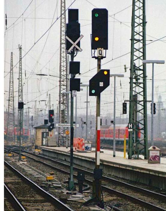
2003 wurden die HI-Lichtsignale der DR-Versuchsbauart auf dem Hauptbahnhof gegen neue Ks-Signale ausgetauscht.
