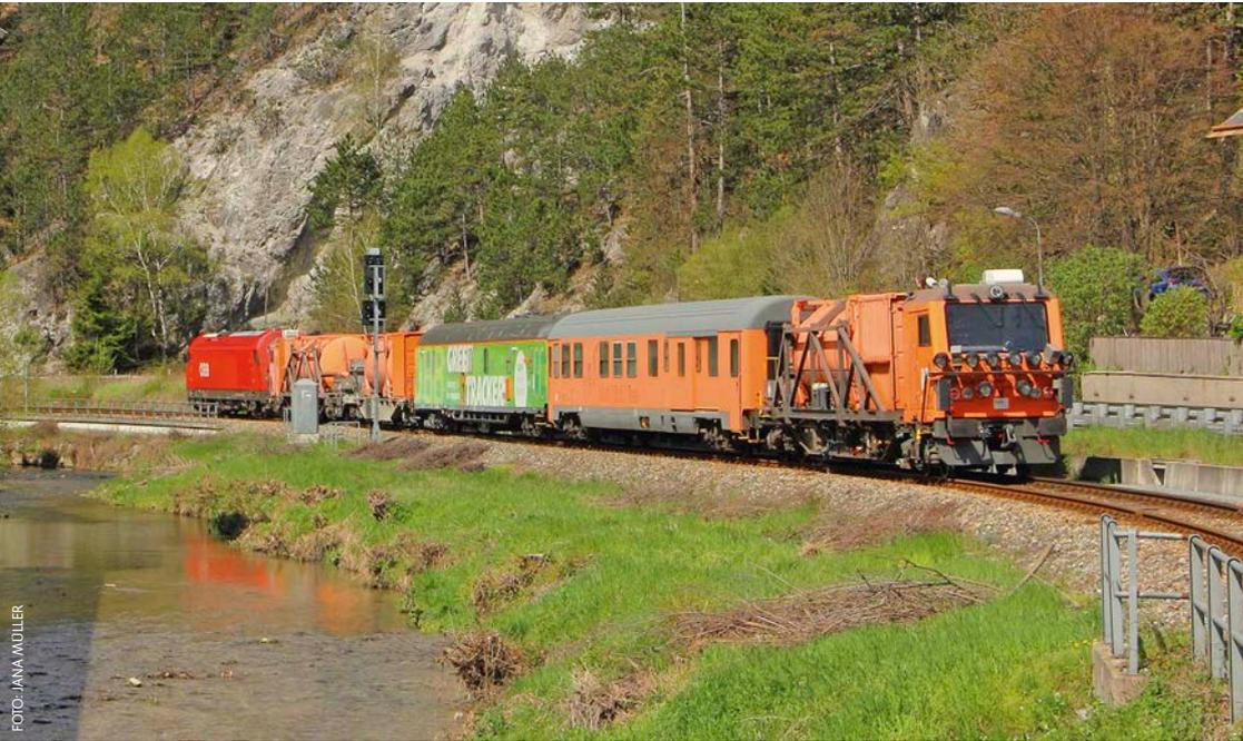
□ Seit 2022 sind die ÖBB bei der Vegetationskontrolle ohne Glyphosat unterwegs. Am 25. April befuhr der „GreenTracker“, der Unkrautvernichtungszug der Österreichischen Bundesbahnen, die Strecken um Wiener Neustadt. Als Zuglokomotive kam 2016 020 zum Einsatz. Der Zug ist wendenzugfähig, so dass das Umsetzen an den Endbahnhöfen von Nebenbahnen entfallen konnte. Mitte Mai war der Zug entlang der Weststrecke und im Raum Amstetten unterwegs.
