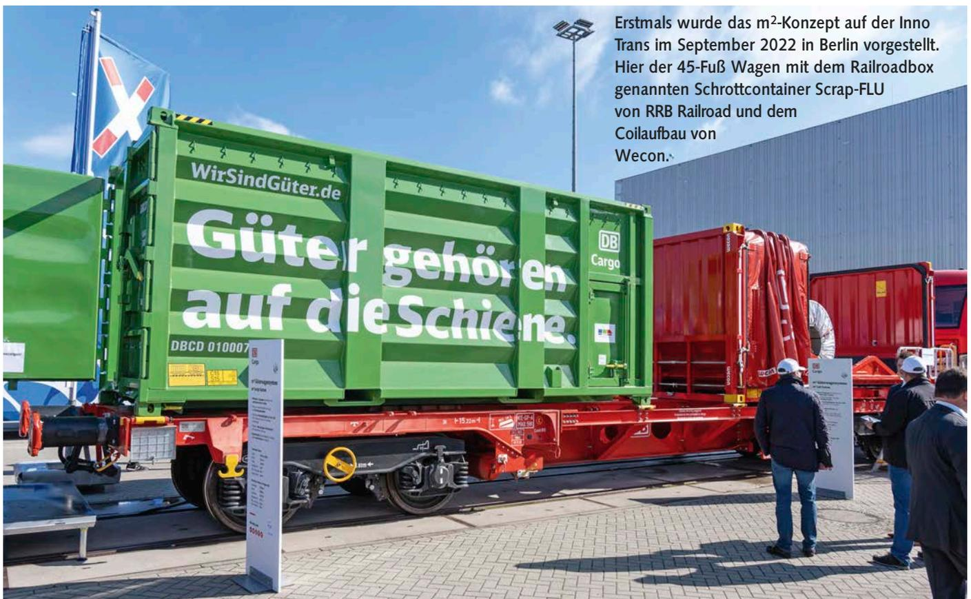
Erstmals wurde das m<sup>2</sup>-Konzept auf der InnoTrans im September 2022 in Berlin vorgestellt. Hier der 45-Fuß Wagen mit dem Railroadbox genannten Schrottcontainer Scrap-FLU von RRB Railroad und dem Coilaufbau von Wecon.
