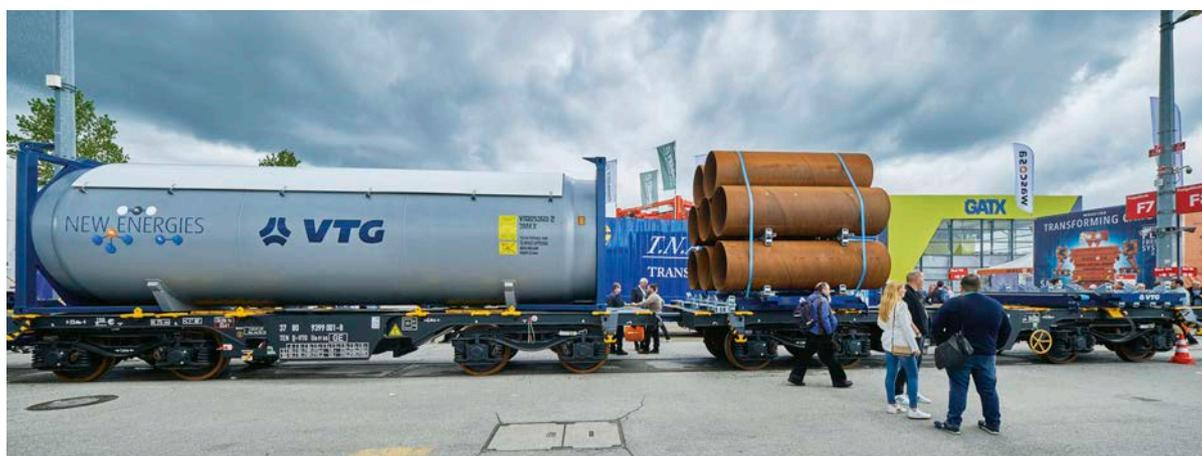
Auf der Messe „transport + logistic“ 2023 zeigte VTG zwei festgekuppelte m<sup>2</sup>-Wagen mit jeweils 35 Fuß. Der Tankaufbau kann auch durch einen Röhrentransport-Aufsatz ersetzt werden, um längere Röhren zu transportieren.
