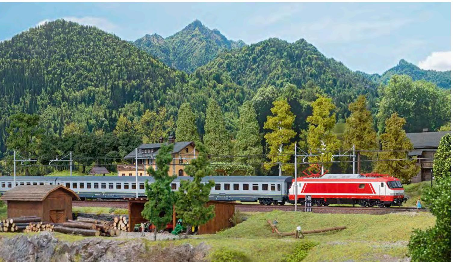
Die E.402A mit windschnittigeren Fronten (Modell von Rivarossi) waren die ersten Serien-Drehstromloks der FS und für 3000V Gleichstrom ausgelegt. Inzwischen wurden alle Maschinen zur Baureihe E.401 mit nur einem Führerstand umgebaut.
