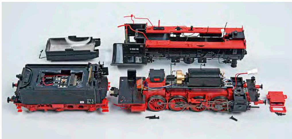
Das sollten Sie keinesfalls versuchen: Die einfache Demontage des Kessels und vor allem der Wiederausbau ohne Zerstörungen scheitert an vielen verklebten Leitungen.
