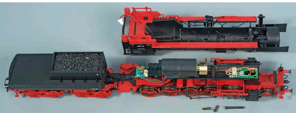
Ein Anblick, der täuscht: Zwar werden Kessel und Rahmen nur von drei Schrauben zusammengehalten, aber die De- und Remontage der Lok fällt dennoch nicht gerade leicht.
