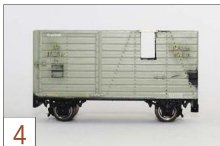
4 Für die Fenster wird aus den Seitenwänden jeweils ein großes Stück entfernt.
