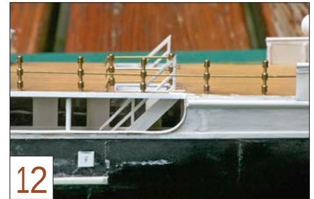
12 Auch beim Bau der Reling helfen Bauteile aus dem Schiffsmodellbau.
