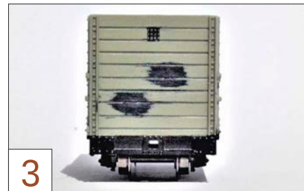
3 Die kleine Stirnfensteröffnung wird erst vorgebohrt und anschließend aufgefeilt.
