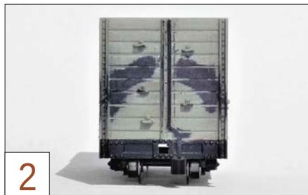
2 Nach dem Entfernen einiger angespritzter Details werden die Flächen versäubert.
