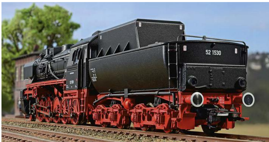
Der Wannentender der Standard-Bauart 2'2'T30 ist vielleicht das Schönste an der neuen Baureihe 52, denn er ist nahezu makellos in den Maßstab 1:87 übertragen worden.
