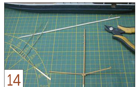
14 Nun folgt die Montage der Masten aus Schaschlickstäbchen und Messingresten.
