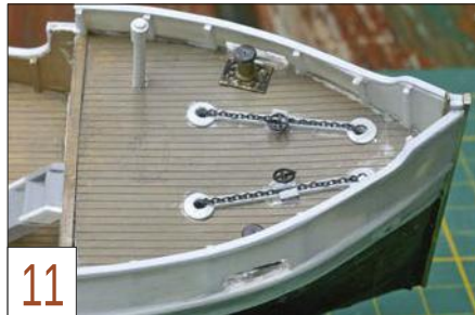
11 Das Vordeck ist mit Ankerketten und den sogenannten Kettenkneifern ausgestattet.
