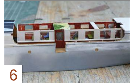
6 Vor den weiteren Aufbauten wird der Salon in den Rumpf eingesetzt.
