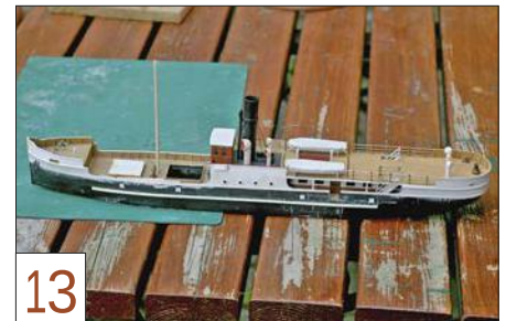
13 Die Aufbauten und die wichtigsten Teile der Ausstattung sind fertig montiert.
