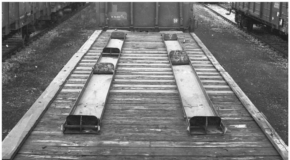
Auf den Bodenplanken der HDL-Pendel-Flachwagen wurden U-Profile aus Stahl montiert, auf denen die Reifen der zu transportierenden Automobile sicheren Halt finden sollten.
