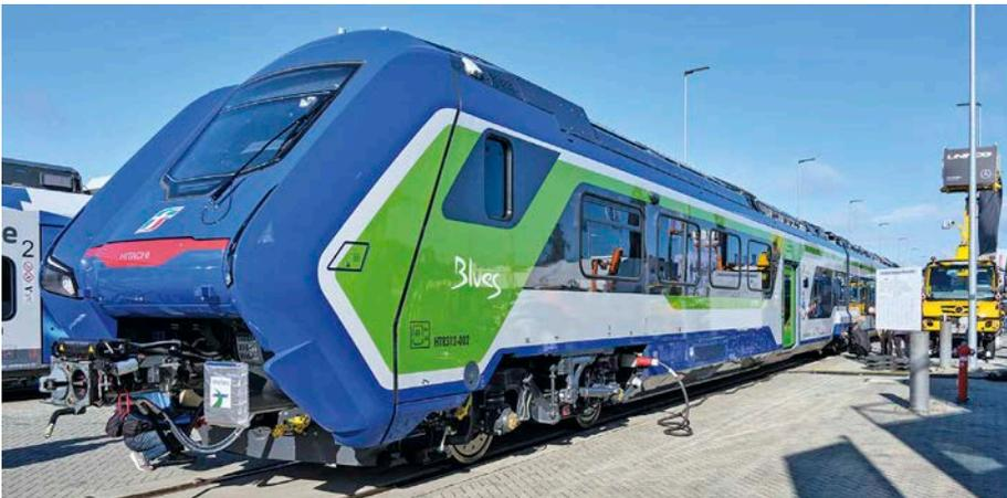
Gleich drei Energiequellen unterstützt der „Blues“-Triebzug von Hitachi für Trenitalia: Batterie, Dieselmotor und Oberleitungsbetrieb.
