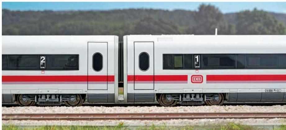
Die Kulissenführung der Kupplungsstangen ermöglicht einen relativ engen Wagenabstand. Die Drehgestelle sowie die Lackierung und Bedruckung sind ansprechend ausgefallen.
