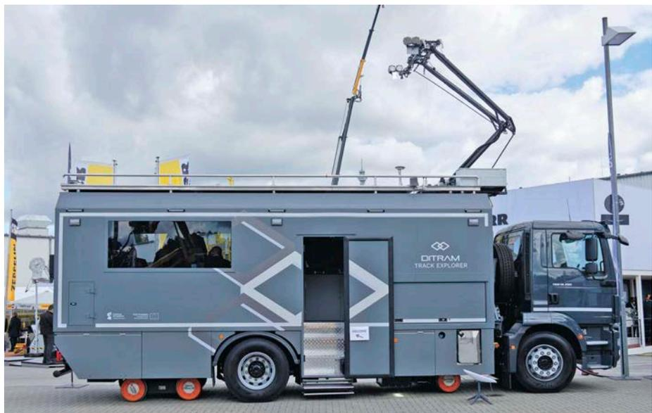
Ditram stellte ein innovatives Messsystem zur Analyse der Gleis- und Netzinfrastruktur und zur Schadenserkenkung in Städten vor.
