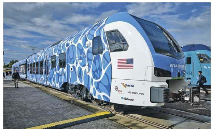
Der Flirt H2 von Stadler für Kalifornien unterscheidet sich von anderen Wasserstofftriebzügen durch das mittig angeordnete – und damit von den Fahrgästen getrennte – Power-Modul.
