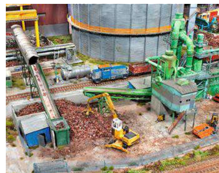
Ein mobiler Bagger füllt mit seinem Hydraulikgreifer den Trichter des Förderbandes.
