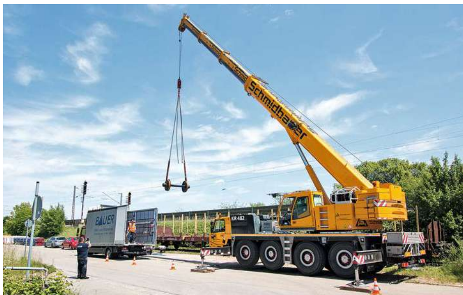
Zum Entladen wird praktischerweise gleich der ohnehin bereitstehende Autokran verwendet. Der Lastwagen nimmt im Anschluss auch die defekten Radsätze wieder mit.
