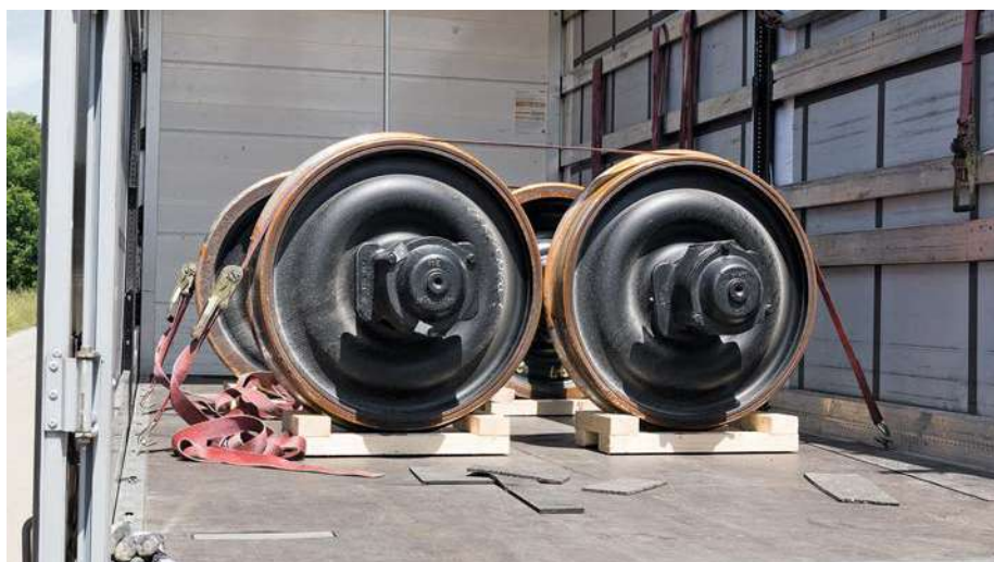
Sauber verzurrt warten die neuen Radsätze, die heute sehr begehrte und nicht eben günstige Ersatzteile sind, auf der Ladefläche des Kleinlasters auf ihren Einbau.
