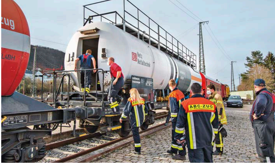
Über eine Tür können das Innere sowie das Dach des Armaturenwagens betreten werden. Er basiert auf einem 1987 gebauten Druckgaskesselwagen Typ Zaggk.
