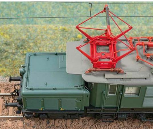
Der Blick von schräg oben zeigt, dass bei der Konstruktion der Stromabnehmer Stabilität vor Filigranität im Lastenheft stand.
