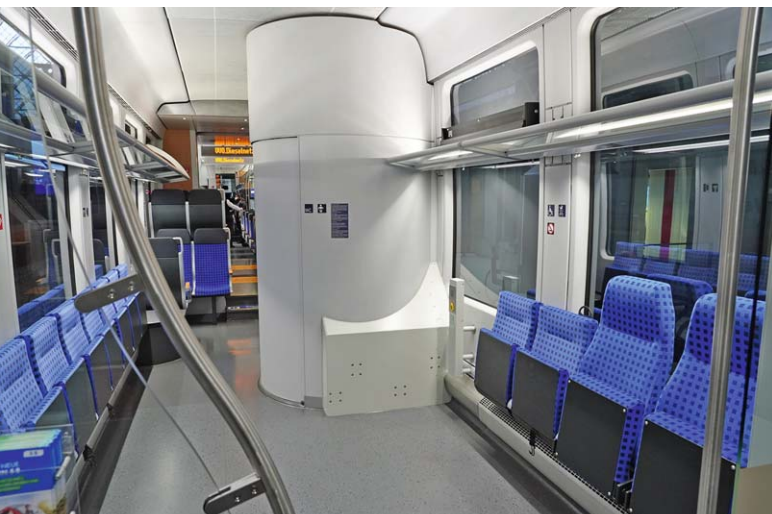
Das Mehrzweckabteil für Rollstühle, Kinderwagen und Fahrräder ist gut zu erreichen. Die Toilette ist behindertengerecht gestaltet.
