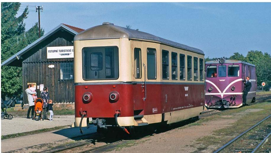
Die einst als Triebwagen-Beiwagen gedachten Balm/ú besitzen keine Steuerabteile. Daher ist an den Endpunkten Umsetzen angesagt, wie in Nová Bystrice am 5. Oktober 2021.
