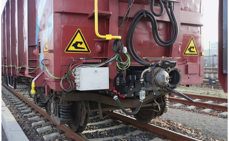
Für die Versuche ist so manches Kabel erst einmal provisorisch angebracht. Deutlich ist bei dem Scharfenberg-Kupplungskopf von Voith das Funktionsprinzip erkennbar.
