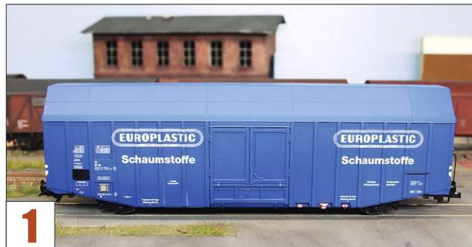
So kommt das charakteristische Güterwagenmodell aus der Packung – in einem leuchtenden Mittelblau. Vor der weiteren Bearbeitung genügt es, das Gehäuse durch Spreizen vom Fahrgestell abzunehmen.
