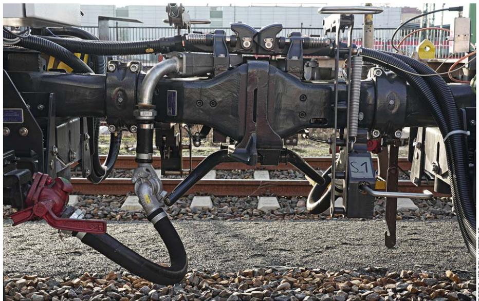
Gekuppelt sieht die Voith-Konstruktion so aus. Die elektrischen Datenleitungen sind oben automatisch verbunden.
