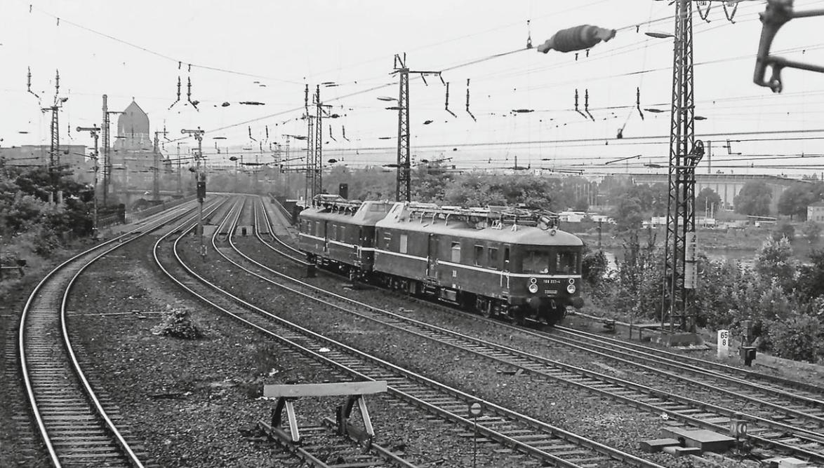
Nicht nur Dampflokomotiven gab es zu sehen: Hier fahren zwei Oberleitungsrevisions-triebwagen der Baureihe 188 nach Dresden Hauptbahnhof und werden vor der Kulisse der Tabakfabrik Yenidze so-gleich die Elbe überqueren.
