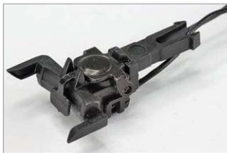
Mit der Digital-Kupplung können auch Fahrzeuge anderer Hersteller ausgerüstet werden.
