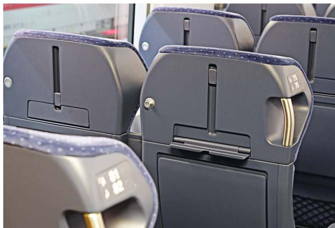
Unscheinbar, aber sehr nützlich: die Tablet-Halter. Sie sind in die Rückseite der Sitzlehnen oberhalb der Klappische integriert. Ist das eigene Endgerät in einen Halter eingehängt, können Reisende sich von Filmen aus dem Bordprogramm unterhalten lassen.
