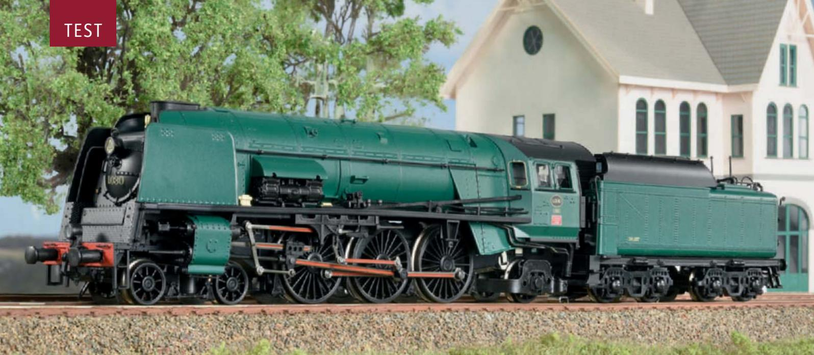
Der Lokführer steht auf der belgischen Dampflokomotive links – daher zeigt das Bild die schräg am Kessel verlaufende Steuerstange.
