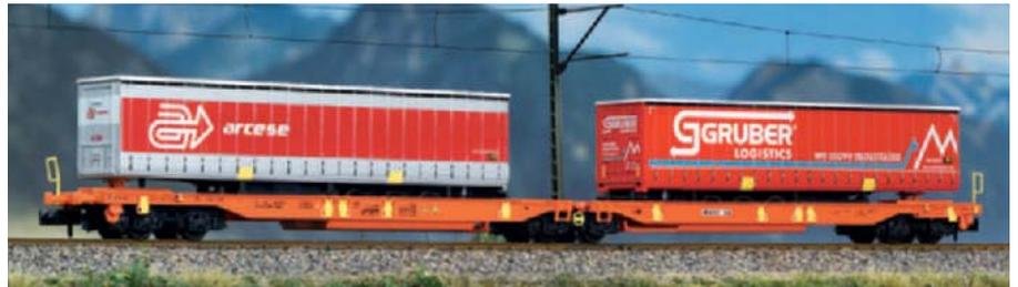
Angesichts der Beladung mit zwei typischen Sattelauflegern ist das Modell des Doppeltaschen-Gelenkwagens der Gattung Sdgmrs/T2000 eher dem Brenner-Verkehr zuzuordnen. Der in den Farben der Wascosa lackierte Waggon ist im Metalldruckguss gefertigt.
