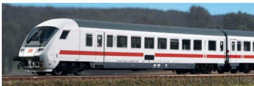
Der IC-Steuerwagen ist eine leicht verkürzte Neukonstruktion, die Schürze lässt sich zurüsten, aber auch demontieren.
