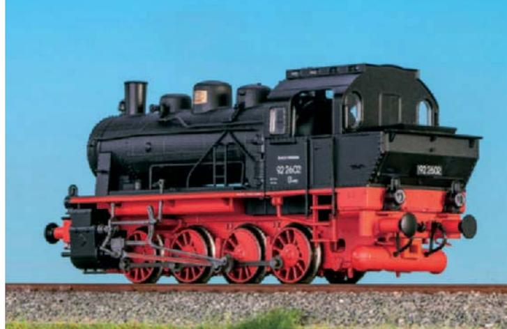
Das Fahrwerk ist gut gelungen. Die Radsätze sind fein mit niedrigen Spurkränzen und die Treibstangen sind angenehm zierlich ausgefallen.
