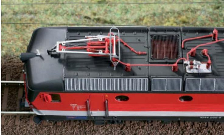
Das macht den Unterschied zu älteren Modellen: Ein fein geätztes Gitter wie auf dem Dach der 1044 ist ein echter Hingucker.
