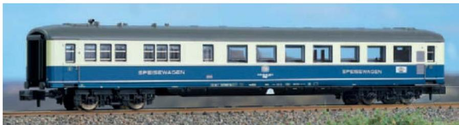
Dem mit MD-Drehgestellen ausgerüsteten WRügh 152 fehlen die Trittstufen.
