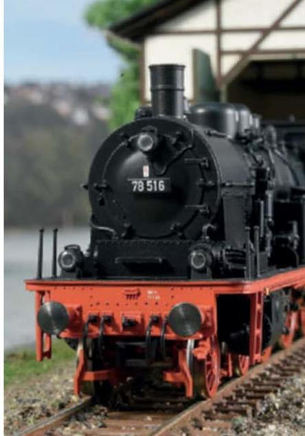
Der Pufferträger lässt sich mit Zurüstteilen komplettieren, nur für den rudimentären Kupplungshaken findet sich kein Ersatz.
