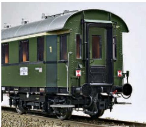
Die Stirnseite mit kurzem Faltenbalg wurde mit Schluss Scheiben und Bremsschläuchen ergänzt.
