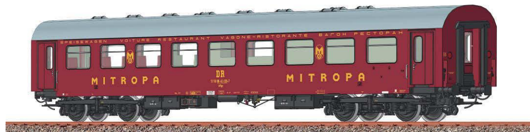
Bei den WRge der späteren Bauserie verbesserten zusätzliche Fenster die Arbeitsbedingungen für die Köche.
