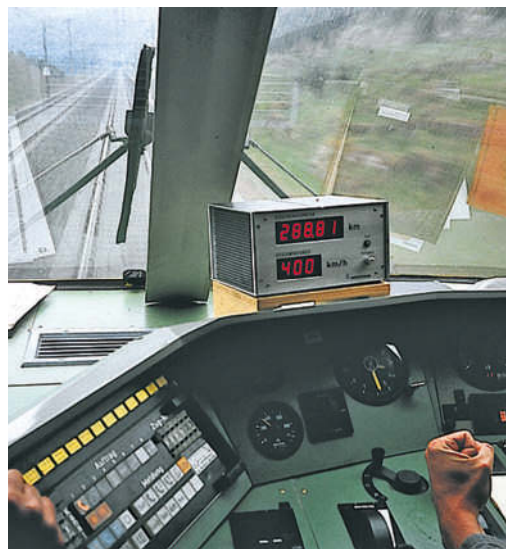
Am 1. Mai 1988 knackte der ICE-V als erstes Rad-Schiene-Fahrzeug die 400-km/h-Marke. Triebfahrzeugführer Ulli Baum freut sich im Führerstand von 410 001 zwischen Hohe Wart und Mottgers auf der NBS Hannover-Würzburg.
