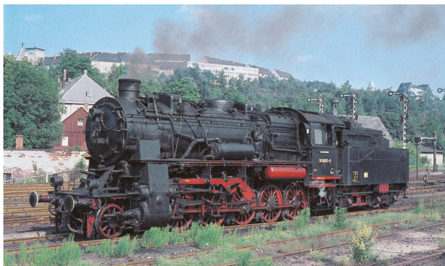
Im Frühjahr 1976 pausierte 58 1800 im Bf Aue (Sachsen). Die Maschine besaß Trofimoff-Schieber, wie am fehlenden Müller-Knorr-Ventil auf dem linken Zylinderblock zu erkennen ist.
