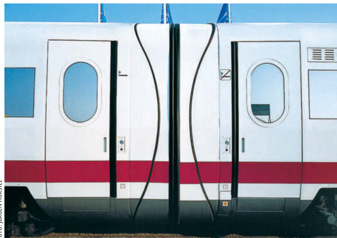
Die aerodynamisch günstigen, bündig mit der Außenhaut abschließenden Wagenübergänge waren ein charakteristisches Merkmal des ICE-V.
