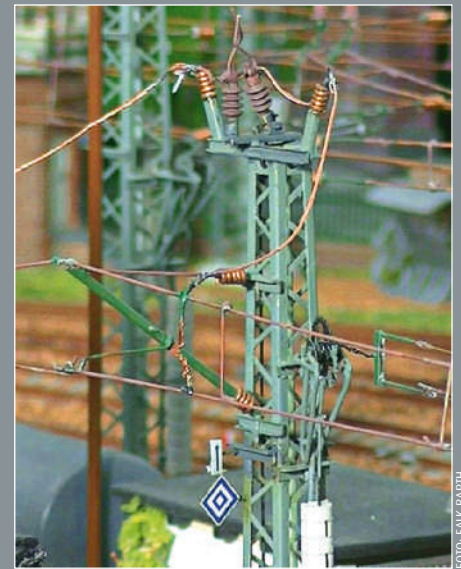
18) Ich mache meine Tochter auf ein Detail aufmerksam: Der Schalter 107 ist mit dem EL6-Signal gekoppelt, das hier fest am Mast angebracht ist. Wenn der bewegliche Pfeil sichtbar ist, verbietet er bei eingeschaltetem Schalter die Weiterfahrt für Fahrzeuge mit Stromzuführung in die Tankstelle. Bei ausgeschaltetem Schalter ist der Pfeil nicht zu sehen und verbietet damit jegliche Weiterfahrt für Fahrzeuge mit Stromzuführung. (Im Modell werden Schalter und Pfeil mit Hilfe eines Servomotors bewegt.)
