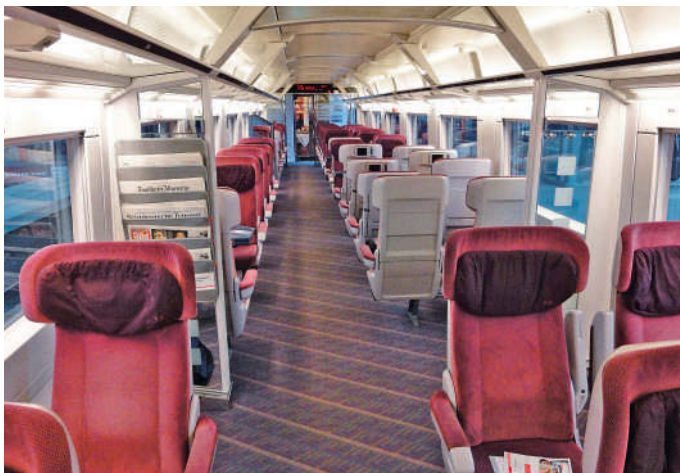
Im ICE2 mussten auch 1. Klasse-Fahrgäste weitgehend auf Abteile verzichten. Die Großraumbestuhlung entwickelte sich zum Standard.
