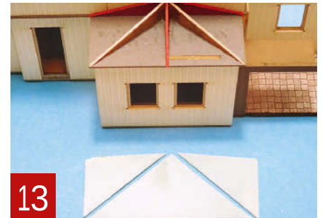
13 Wichtig ist ein exakter Zuschnitt der Dachplatten, damit die Spalte möglichst schmal sind und kaum auffallen.
