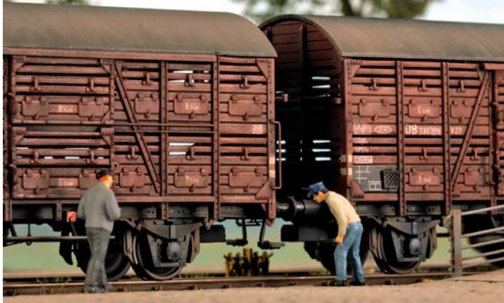
Die Verkleinerung der Lüftungsschlitze ist eine aufwendige Arbeit: Doch sie zeigt deutlich ihre Wirkung.
