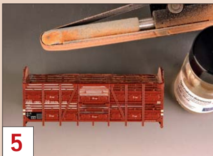
Die Spalten zwischen den Brettern sind zu groß. Dies ist insbesondere durch das Dünnerschleifen der Wände offensichtlich und wird durch feine Kunststoffstreifen korrigiert.
