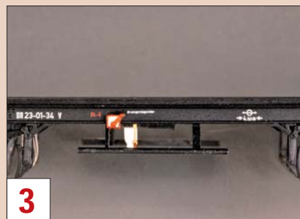
Damit die Tritte unter den Türen filigraner wirken, werden die Halter mit einer Feile vorsichtig dünner gefeilt. Die Bremsumsteller sind bereits ab Werk farbig angelegt.
