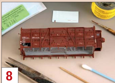
Durch das Einkleben und Schleifen der Kunststoffstreifen leidet die Beschriftung. Gaßner steuert eine neue, sehr fein wirkende Beschriftung aus Nassschiebbildern bei.
