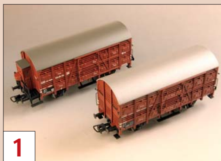
Den Verschlagwagen gibt es in den Versionen mit und ohne Bremserhaus. Schon ab Werk sind die Modelle reich detailliert und mit freistehenden Griffstangen ausgestattet.
