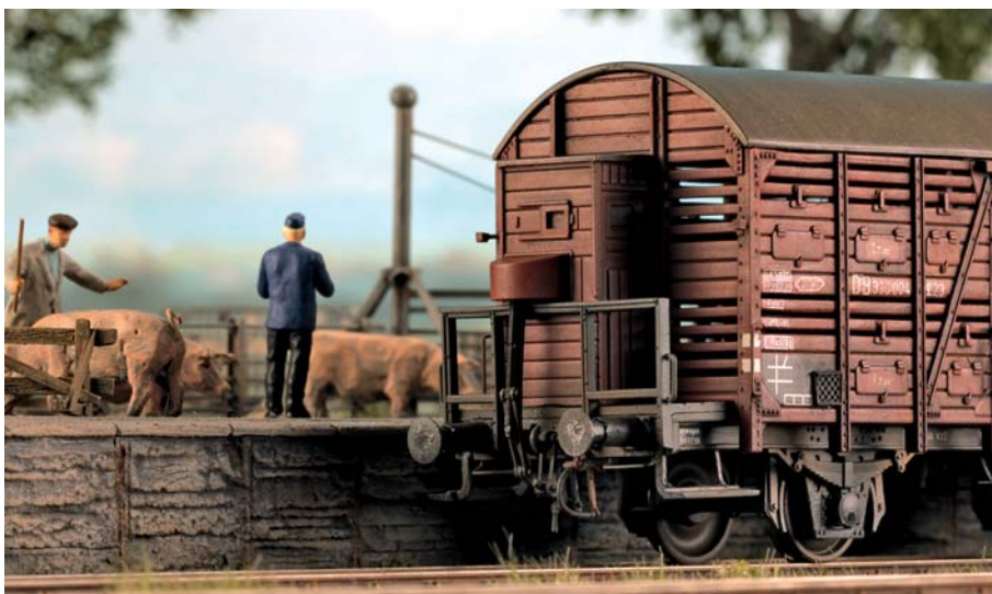
Auch wenn die Nachbildung der drei Nieten an den unteren Enden der Eckprofile nur ein kleines Detail ist, so gehört sie doch zur vorbildgerechten Ausstattung des Wagens.
