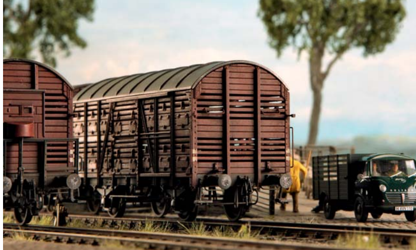
Einige V23 bekamen in den 50er-Jahren ein Stahldach. Dieses wurde hier durch dünne Kunststoffstreifen von Evergreen nachgebildet.
