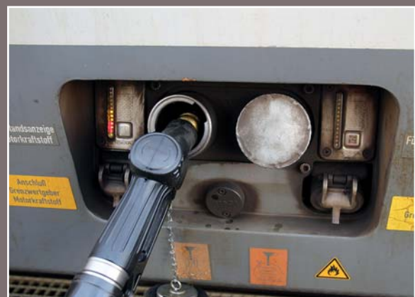
Am Wagenkasten öffnet Olaf Hähle eine Klappe, dahinter kann er den Vorrat an Brauchwasser überprüfen.
