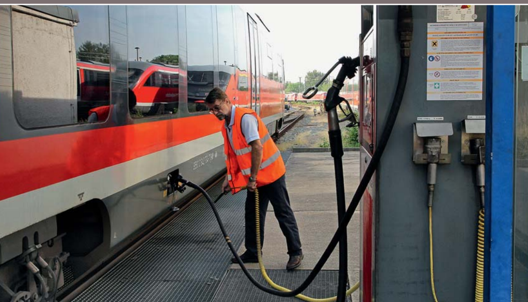
Am Wagenkasten öffnet Olaf Hähle eine Klappe, dahinter kann er den Vorrat an Brauchwasser überprüfen.
