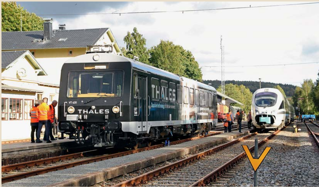
THALES-Laborfahrzeug „Lucy“ VT 420 in Schlettau vor der Präsentation des teleoperierten Fahrens. Im Hintergrund der errichtete 5G-Funkmast, über den der Datenaustausch zwischen dem mobilen Leitstand im Zwei-Wege-Fahrzeug Rail Drive und VT 420 gesendet wird.
