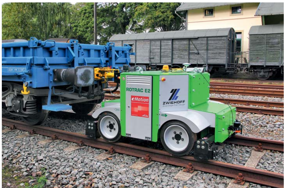
Das zur Präsentation des automatischen Fahrens nach Schlettau gebrachte Fahrzeug von DB Systel GmbH Team AuRa. Auf einem verschlossenen Nebengleis wurden das An- und Abkuppeln, der Verschub eines Wagens und das Erkennen von Hindernissen im Gleis demonstriert.
