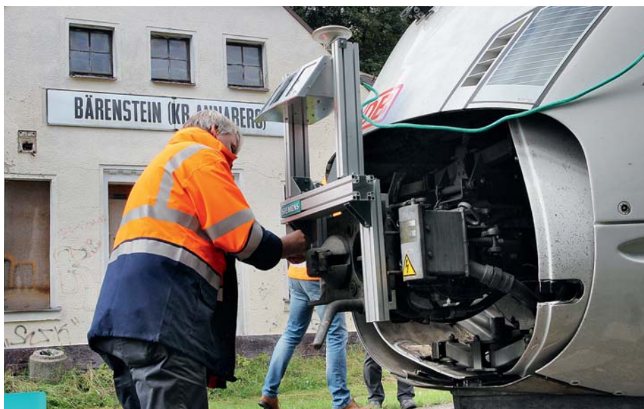
Im Südkopf des Bahnhofs Cranzahl wurden mit dem Laborfahrzeug 605 517 auf EGB-Gleisen Annäherungsfahrten zur Objekt- und Hinderniserkennung auf einen VT 642 unternommen.
