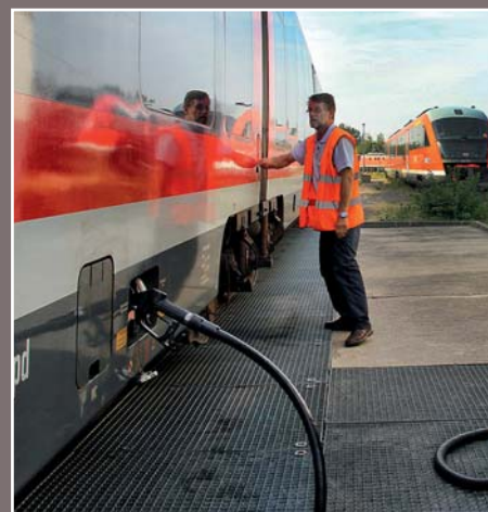
Am Wagenkasten öffnet Olaf Hähle eine Klappe, dahinter kann er den Vorrat an Brauchwasser überprüfen.
