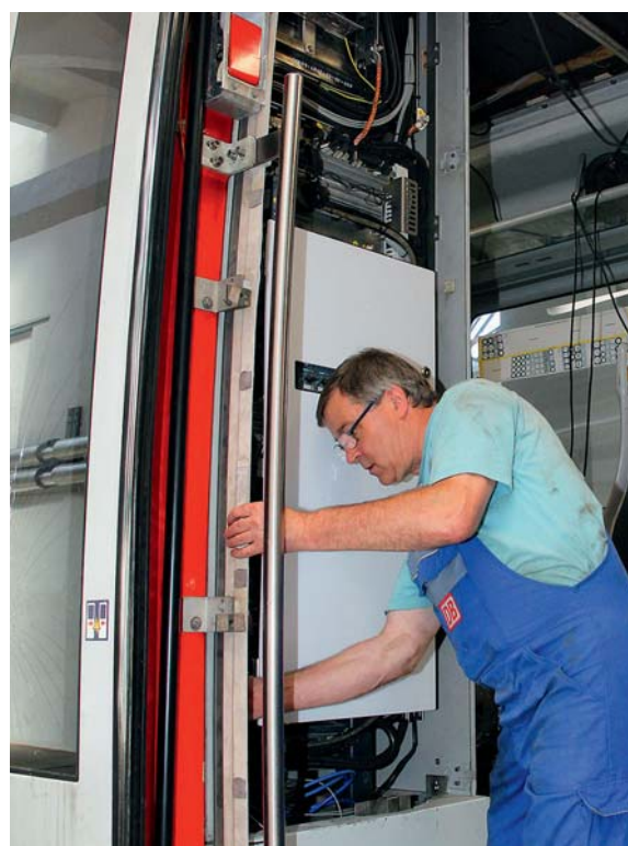
Sarah Künzel und Andreas Albrecht bei Arbeiten am Schaltschrank im Führerstand des VT 642 528/028. Arbeiten am Fahrwerk und im Innenraum laufen parallel dazu ab.
