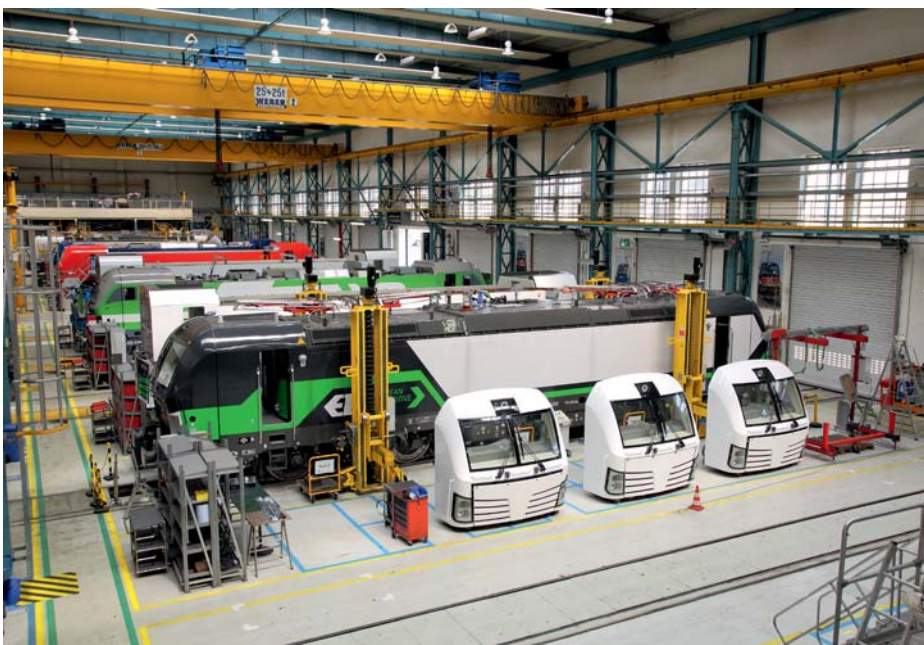
Blick in die Siemens-(Krauss-Maffei)-Werkhalle in München-Allach mit der Vectron-Endmontage im Juni 2016. Eine Lokfront ist heutzutage ein tauschbares Bauteil.
