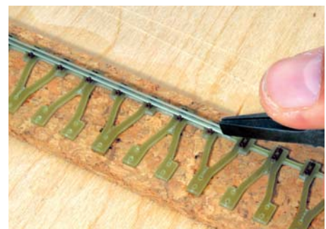
Dann kann das Schienenprofil vorsichtig eingeschoben werden.
