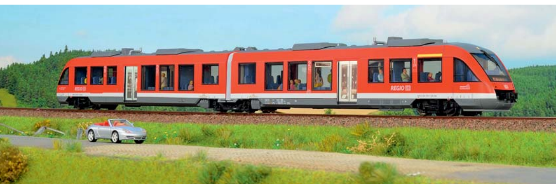
Kurze Zeit nach Fleischmann und Mehano brachte auch Märklin ein H0-Modell des Lint 41 (Baureihe 648) auf den Markt. Sehr gut ist auf der Aufnahme das Jakobsdrehgestell erkennbar.
