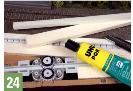
24 Mit passend zurechtgeschnittenen, 8 mm hohen Schaumstreifen werden anschließend sämtliche Zwischenräume ausgefüllt.
