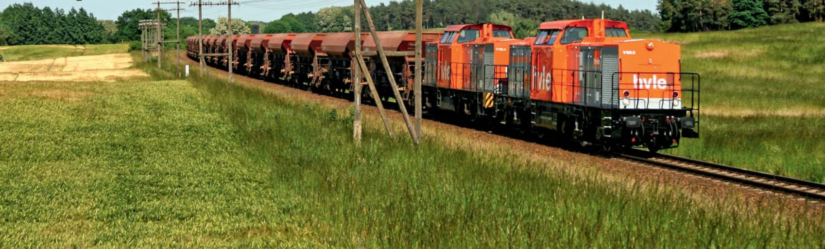
Zwei modernisierte V 100 hatten am 2. Juni 2008 zwischen Trebnitz und Obersdorf auf der Ostbahn einen Bahnbau-Leerzug am Haken. Beladen wog er 1500 Tonnen. Solche Transporte bildeten den Grundstock für die weitere Expansion des Unternehmens HVLE.
