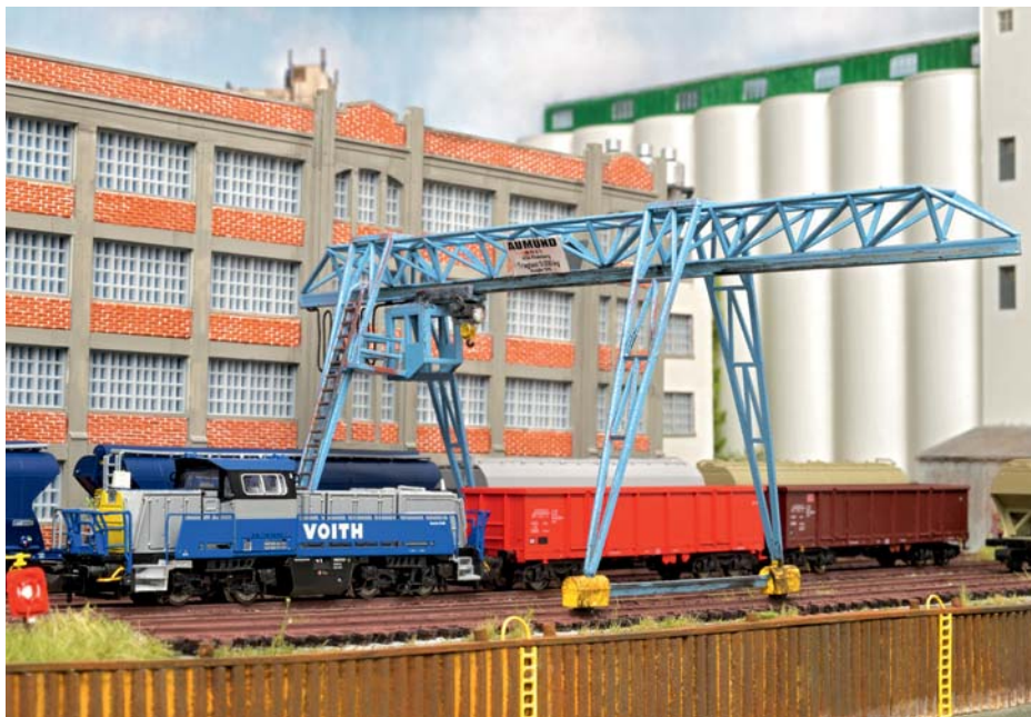
Multifunktional für weniger schwere Umschlaggüter ist der Brückenkran direkt am Kai.
