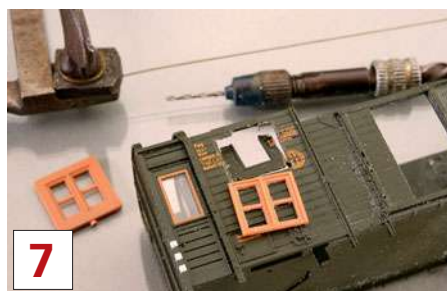
7 Am Zugführerabteil werden doppelte Klappfenster (Kibri-Teile) eingebaut. Das kleine Wagenfenster wird größer ausgearbeitet.
