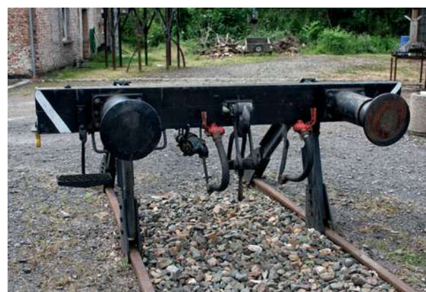
Hergestellt wurden der Übungs-Prellbock vermutlich in der Lehrwerkstatt des Bw Gera.
