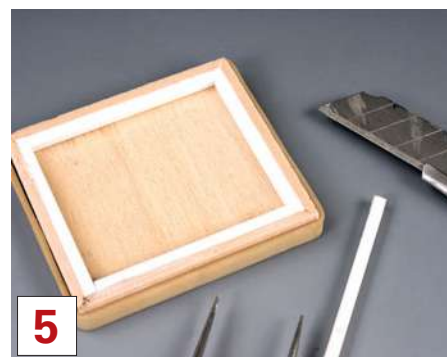
Die etwas zu dünnen Mauerplatten mit Ziegelstruktur füllt man innen mit 2 mm dicken ABS-Streifen auf.
