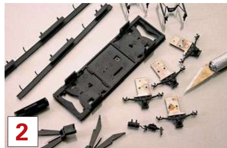
2 Das Chassis wird soweit wie möglich zerlegt. Benötigt wird nur die Grundplatte, alle Fahrwerksteile werden abgetrennt.
