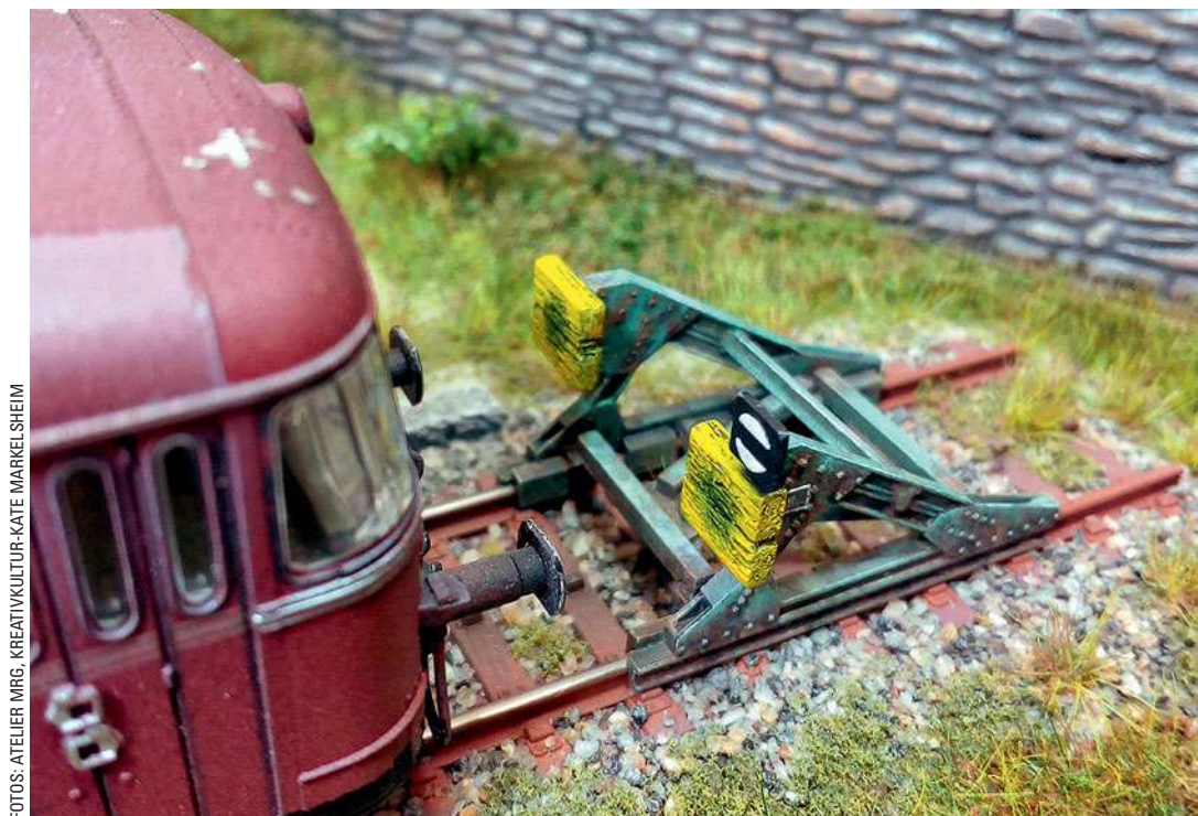
Spuren von Pufferschmiere prägen die geschundenen, meist gelb lackierten Holzklötze. Auch die Signaltafel Sh 0, beim Vorbild mit Reflektormaterial bestückt, wurde gewissenhaft bemalt.
