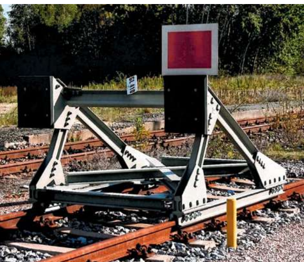
Zwickau. Ein Bremsprellbock in seiner ursprünglichen Ausführung mit Sh2-Tafel.
