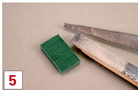
5 Nachdem die umlaufende Kontur entfernt ist, folgt das Versäubern mit Feile und Schmirgellatten.
