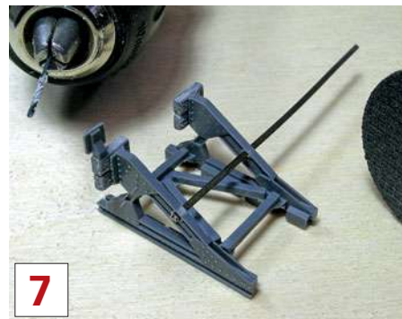
7 Ein Rest brünierten Messing-Schienenprofils wird als Querverstrebung eingebaut und später mit Zweikomponentenkleber befestigt.
