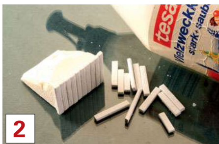
Dann folgt das Verkleben der bereits strukturierten und abgelängten Leisten mit lösungsmittelfreiem Vielweckkleber.
