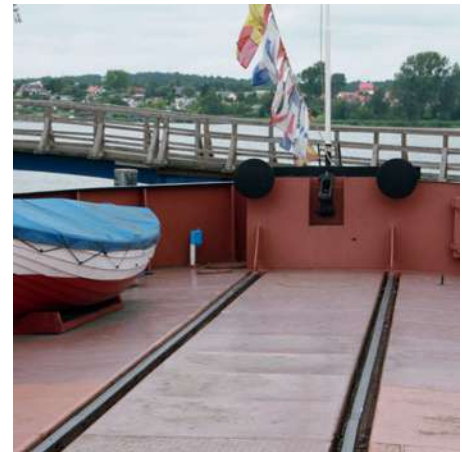
Auch beim Trajektieren von Eisenbahnfahrzeugen auf Schiffen sind Sicherungseinrichtungen erforderlich. Das ehemalige Fährschiff „Stralsund“ besaß deshalb einen Prellbock mit Kupplungshaken.
