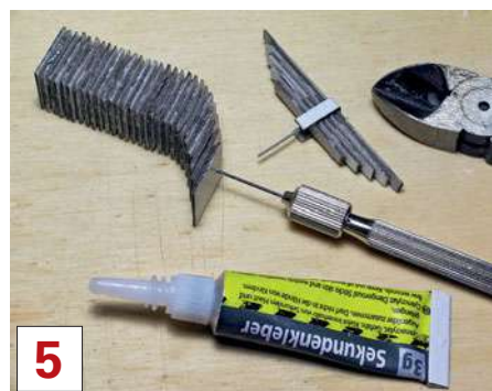
5 Das Flügelsymbol wird mittels eines Stücks Stahldraht mit dem Sockel verdübelt. Stabilisierend und verbindend wirkt Sekundenkleber.
