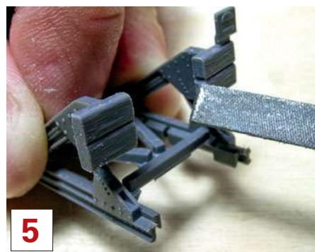
5 Überall dort, wo die Trennscheibe wütete, feilt man die verschwundene Holz-Fuge anschließend wieder neu in den Kunststoff.
