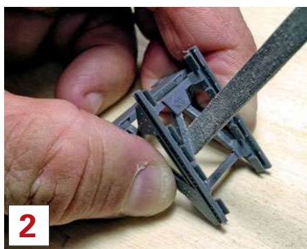
2 Die Verschraubungs-Hülse wurde zuerst entfernt, einfach mit dem Messer. Anschließend versäubert man die Kanten mit einer Feile.
