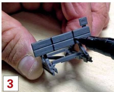
3 Aus der durchgängigen breiten Bohle sollen zwei hölzerne Einzelpuffer werden. Der Bastler zeichnet am besten an, was weg muss.
