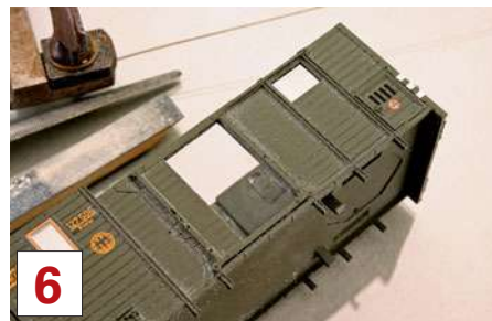
6 In exakt denselben Abmessungen schneidet man das Material aus der Laderaumtüre heraus und befeilt die Öffnung.
