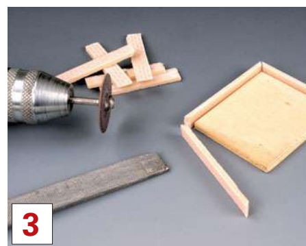
Die zugeschnittenen Ziegelwand-Streifen erhalten mit Schleifscheibe und Feile 45-Grad-Gehrungen.
