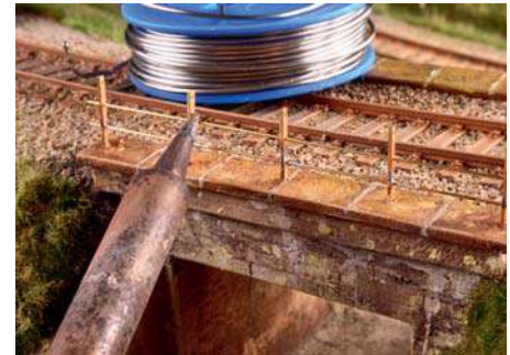
Sind die Pfosten senkrecht ausgerichtet und verklebt, kann man die Querstreben auch vor Ort einfädeln und verlöten.
