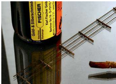
Schwarze Geländer lassen sich direkt mit „Pariser-Oxyd“ brünieren, ansonsten ist eine Grundierung mit Metallhaftgrund nötig.
