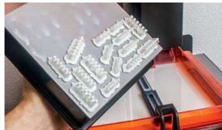
Ist der Druck abgeschlossen, hängen die Teile der Läutewerke an der Montageplattform. Sie müssen nun noch gereinigt werden.
