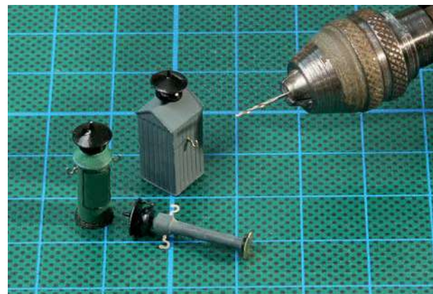
Den Bausätzen liegen je zwei geätzte Isolatoren bei, für die an den bereits angesenkten Stellen Bohrungen nötig sind.
