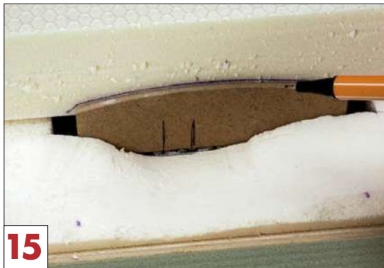
Aus der Abdeckplatte wird der Bogen der Kellerdecke herausgearbeitet. Als Schablone dient eine Kopie der Frontmauer.
