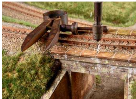
Sind die exakten Abstände mit einem Anreißzirkel markiert, folgt das Bohren im Durchmesser der Haltezapfen.
