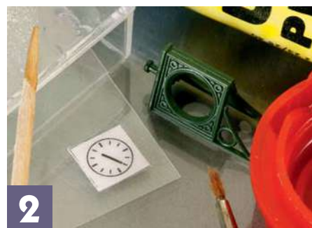
2 Die Zifferblätter werden mit dünner Kunststoff-Folie beklebt.
