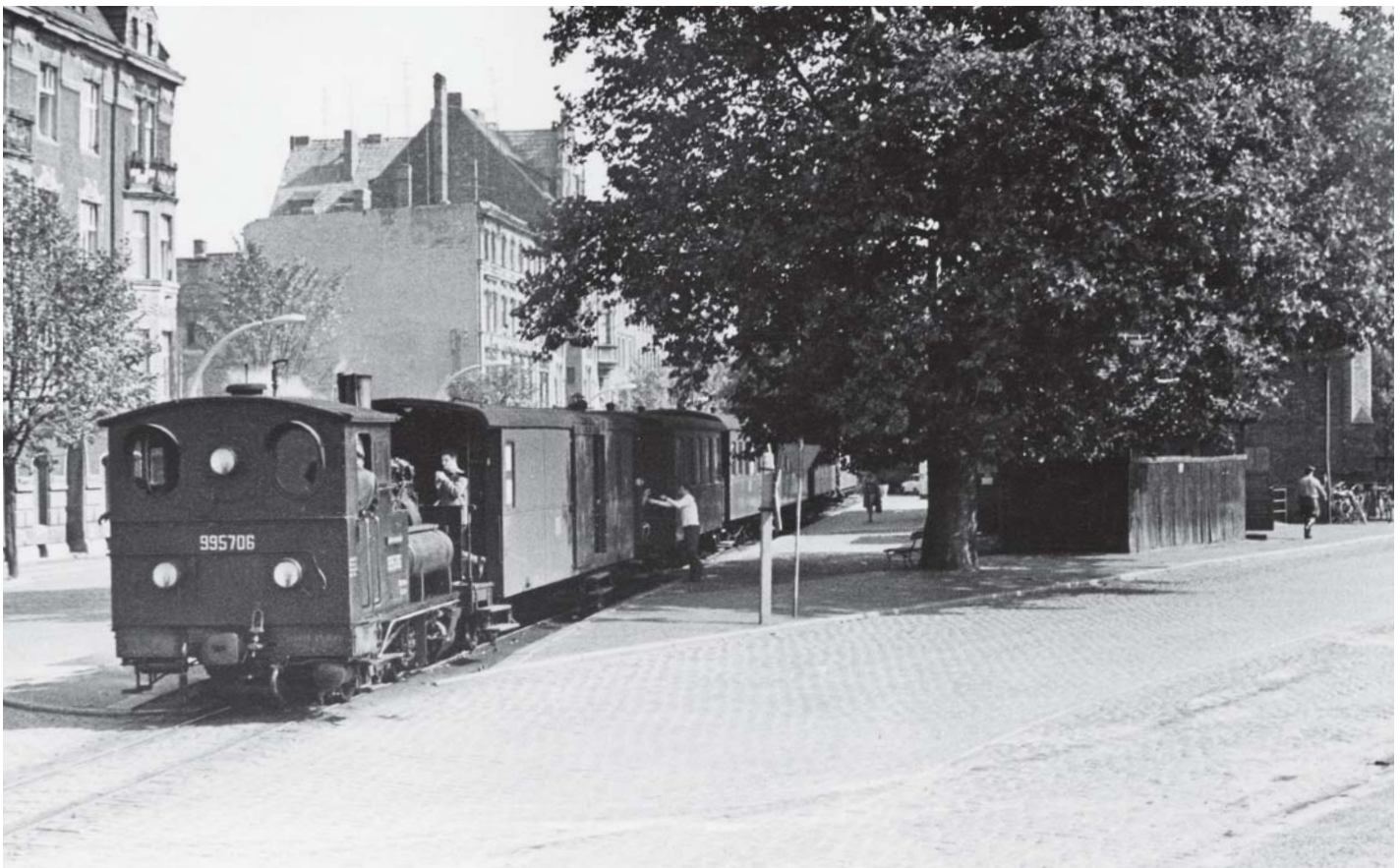
Der Endpunkt „Cottbus Spreewaldbahnhof“ bestand aus einem Stumpfgleis. Deshalb mussten alle Personenzüge in den Güterbahnhof fahren, wo die Lokomotive den Zug umfuhr und dann rückwärts an den Bahnsteig drückte, hier 99 5706 bereit zur Abfahrt nach Straupitz.
