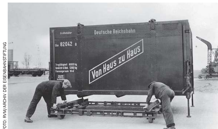
Für Haus-zu-Haus-Transporte nutzte die DRG bereits in den 1930er-Jahren derartige Standardbehälter. Beachtenswert ist auch der mobile Kran im Hintergrund.
