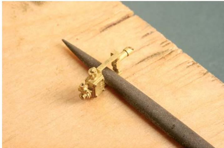
*Bei der Sifa von Weinert wird der innere Rahmen des Halters mit einigen Feilenstrichen entfernt.*
