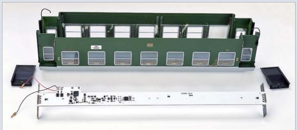
Nach der einfach durchzuführenden Demontage des Modells zeigt sich die Platine für die Innenbeleuchtung mit integriertem Digitaldecoder.
