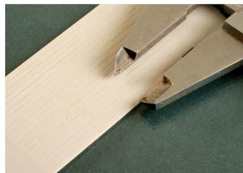
*Im Bereich des Gepäckabteiles lassen sich die Trennfugen der Holzdielen mit einer abgewinkelten Schieblehre einritzen.*
