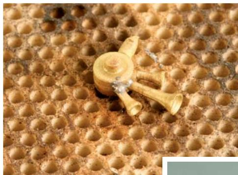
*Das dritte Horn am Weinert-Teil wird hinten abgetrennt und nach Bohren eines kleinen Loches vorn wieder angelötet.*
