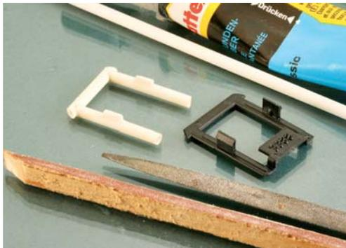
Ungekuppelt haben die Gummiwülste einen runden Querschnitt. Deshalb entsteht der steuerseitige aus 2,5-mm-Polystyrol neu.
