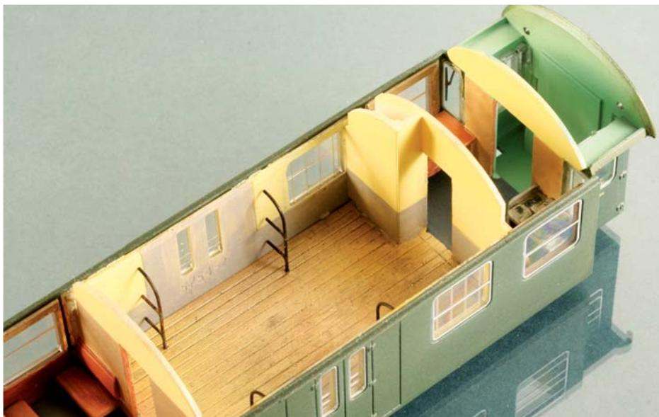
Die Sicherungsbügel für den Packraum entstehen im Eigenbau. Eine selbst gebastelte Löt-schablone aus Holz hilft beim Anlöten der Querstreben an den vertikalen Bügel.
