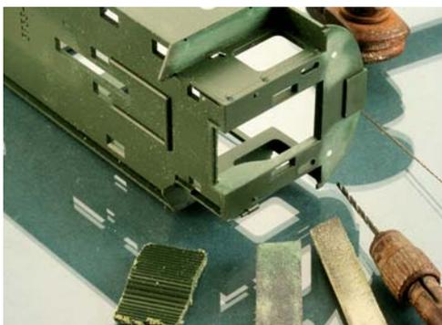
*Am Kuppelende kann man die Rollos der Übergänge heraustrennen und danach die Schnittkanten per Feile bearbeiten.*
