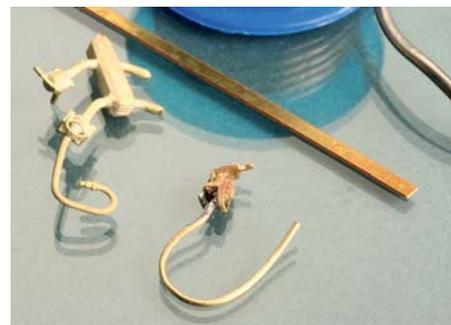
Die Aufnahme der Steuerleitung erhält einen Halter aus einem abgewinkelten Messing-Flachprofil.
