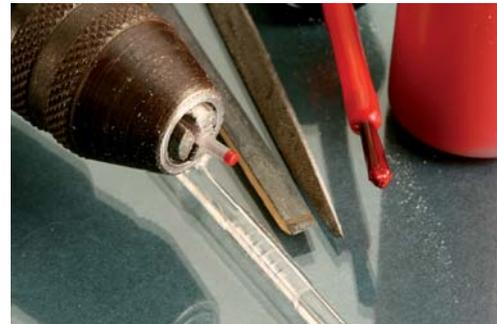
Die Schlussleuchten entstehen aus gedrehten Angusskanälen für Klarsichtteile, rot gefärbt werden sie mit Glühbirnenfarbe.
