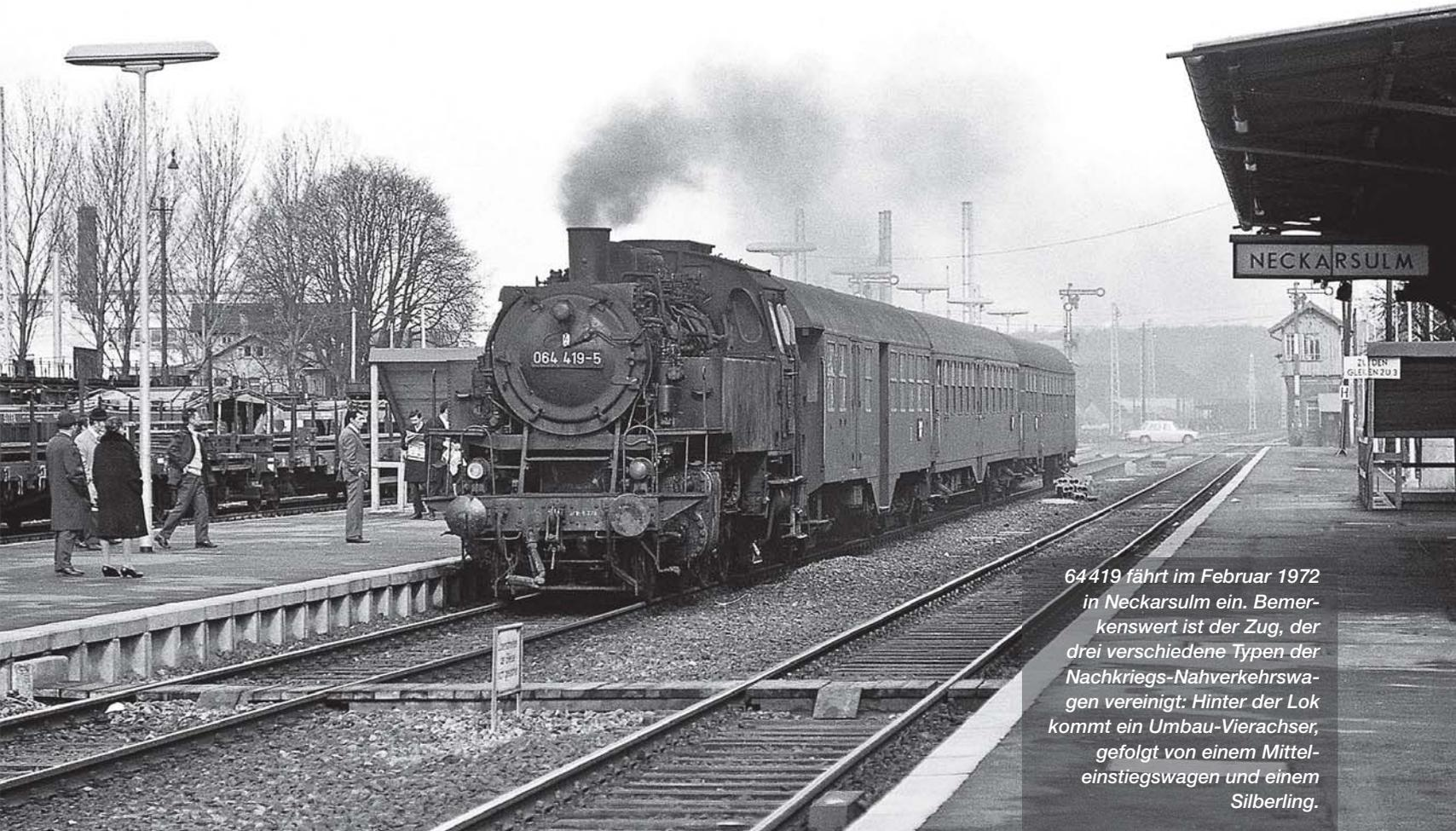
*64419 fährt im Februar 1972 in Neckarsulm ein. Bemerkenswert ist der Zug, der drei verschiedene Typen der Nachkriegs-Nahverkehrswagen vereinigt: Hinter der Lok kommt ein Umbau-Vierachser, gefolgt von einem Mitteleinstiegswagen und einem Silberling.*
