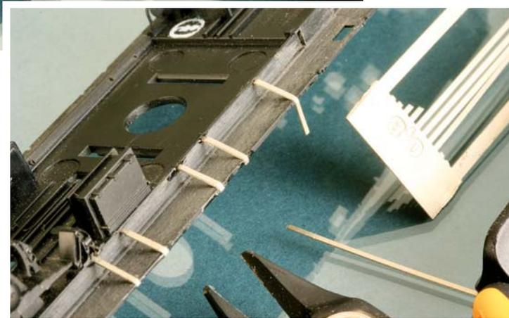
sprechenden 0,25-mm-Drahtstücken darstellen. Der obere Absatz der Sitzlehne wird etwas heruntergefeilt, so dass ein circa 0,8 mm hoher Streifen stehen bleibt. Für die Haltebügel am oberen Abschluss aus 0,3-mm-Messing- oder Neusilberdraht genügt ein Befestigungsloch. Montiert werden die Bügel erst nach der Farbgebung der Sitzgruppen.
