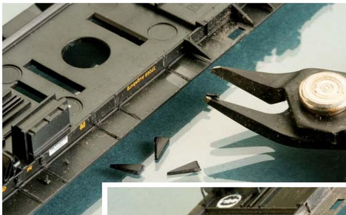
Die angeformten Kastenstützen der Antriebe lassen sich mit einem scharfen Seitenschneider abklippen. Sie werden durch Neusilberstreifen ersetzt.
