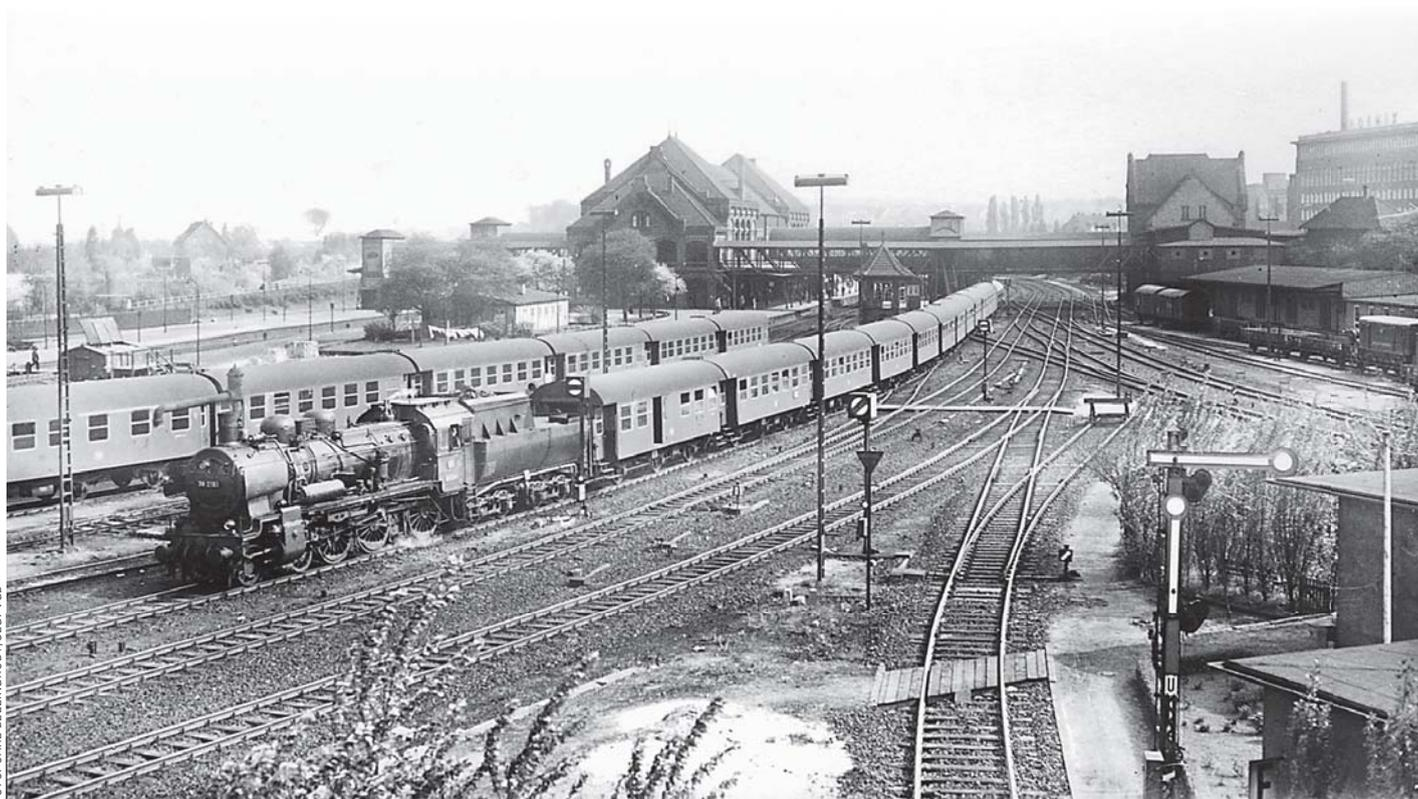
*Nur wenige Kilometer südlicher als auf dem vorhergehenden Bild: Die 382161 mit geschlossenem Führerhaus ist wendenzugfähig. Der Arbeiterzug mit nicht weniger als zehn Dreiaxsern und einem Bylf-Mittleinstiegs-Steuerwagen verlässt 1960 Hamburg-Harburg.*
