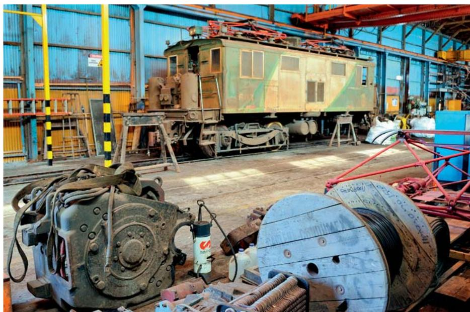
Die Lok 603 wurde 1927 bei General Electric in Schenectady, New York, mit der Fabriknummer 10155 gebaut. Im Dezember 2009, nach fast 83 Einsatzjahren, wird sie immer noch unterhalten. Im Vordergrund ist einer der alten GE-Fahrmotoren zu sehen.
