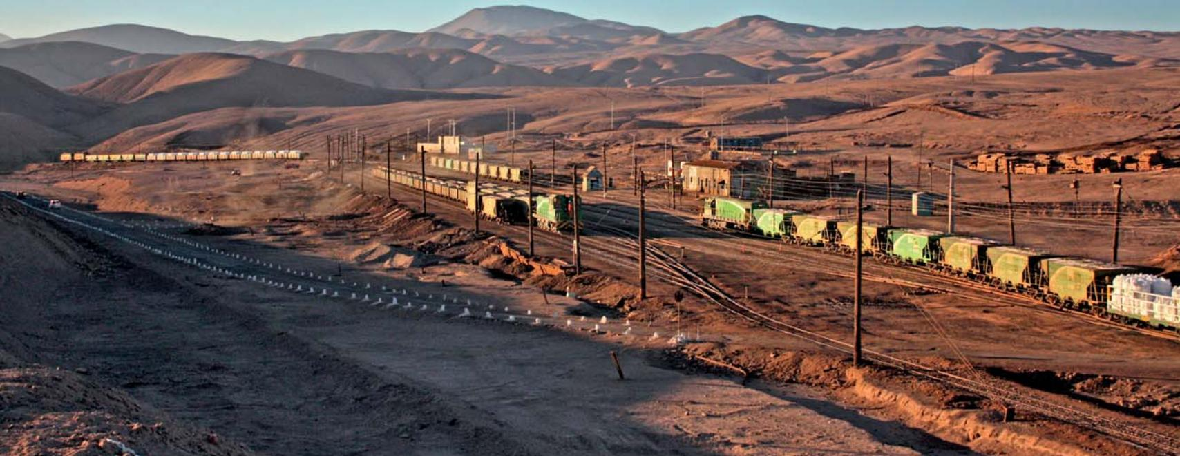
**Lokwechselbahnhof Barriles:** Während hinten ein Zug mit E-Loks talwärts ausfährt, folgt in Dieseltraktion der nächste volle Zug mit einer GE-U12C. In der Gegenrichtung wartet ein Leerzug mit einer SW 1200 auf die Ausfahrt in Richtung Westen.
