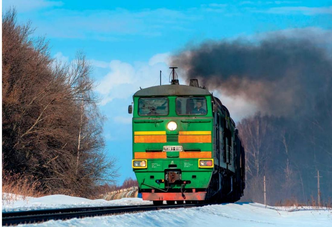
Nördlich von Tula ist 2TE10U-0159 mit beeindruckender Abgasfahne unterwegs. Die Doppellokomotive besitzt eine Leistung von mehr als 4400 kW.
