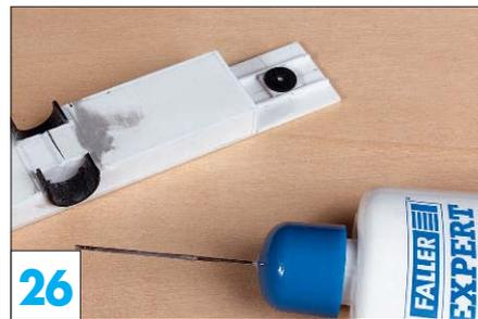
**26** Das Fahrwerk aus Polystyrol erhält Radkästen und eine Kupplung aus der Bastelkiste.
