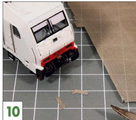
**10** Die Tritte über den Puffern entstehen aus geätztem, exakt zugeschnittenem Blech.
