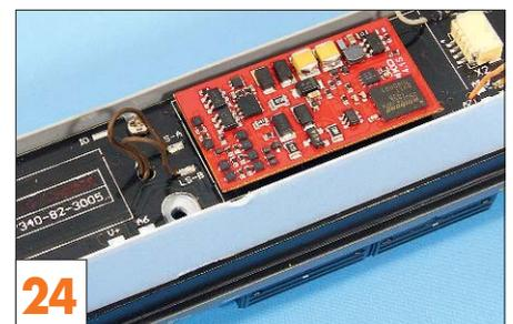
**24** Der Lautsprecheranschluss befindet sich bei Pikos 219 direkt neben dem Decoder.
