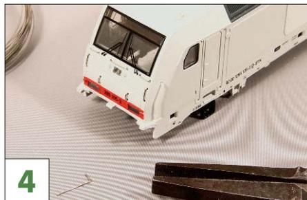
4 Die neuen Griffstangen biegt man sich mit einer Flachzange aus dünnem Draht.
