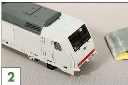
2 Mit feinem Schleifpapier erhält die Lokfront dann eine absolut glatte Oberfläche.
