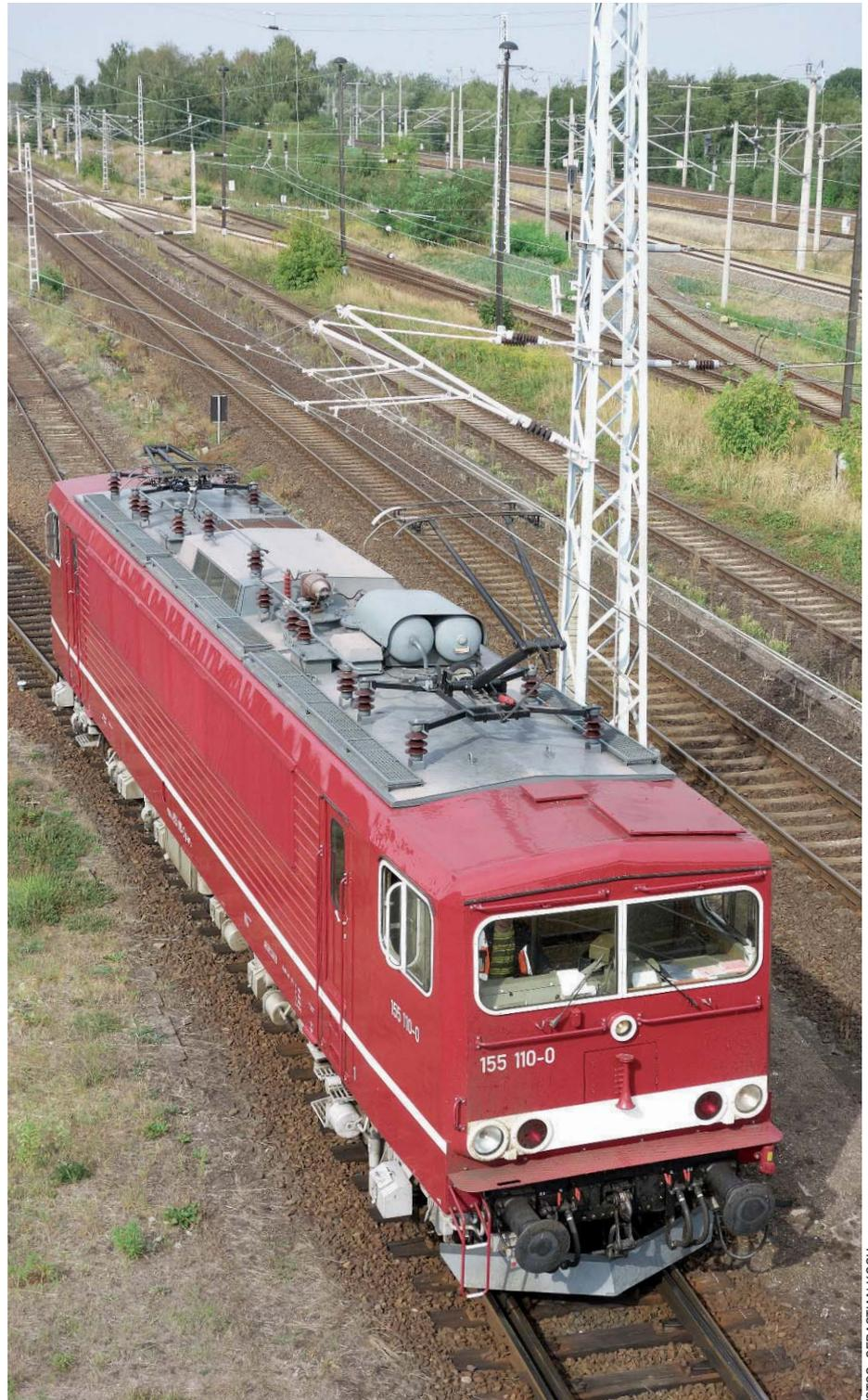
Durch die Frontfenster hat man bei der 250 einen guten Blick in den Führerstand. Beim Blick von oben ist auch die Trittfläche aus Riffelblech über den Puffern gut zu erkennen.
