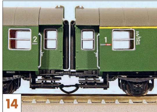
Die dreiachsigen DB-Umbauwagen standen in der Regel als kurzgekuppelte Doppereinheiten im Einsatz. Solche Pärchen kann man auch mit den Modellen von Tillig umsetzen. Um einen minimalen Abstand zu realisieren, wurde eine Starrkupplung von NME um etwa einen Millimeter gekürzt (rechts). Es sollte dann aber nur auf größeren Radien gefahren werden, da sonst eine Überpufferung droht.
