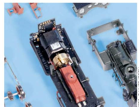
Aus Platzgründen hat Tillig bei seiner T3 den Decoder bereits auf der Platine integriert.
