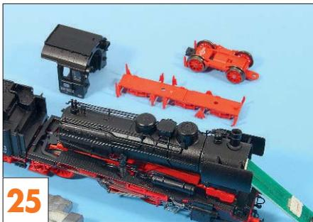
**25** Zum Lautsprechereinbau in Tilligs P8 muss der Kessel demontiert werden.
