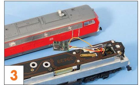
**3** Nach Montage der Platine muss der Decoder unter dem Gehäuse seinen Platz finden.
