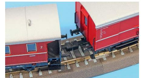
Durch die NEM-Kupplungsaufnahme lassen sich die Magnetkupplungen wie jede andere Kupplung, auch kulissengeführt und kurzgekuppelt, verwenden.
