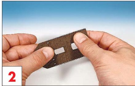
**2** Leicht verzogene Bauteile richtet man mit wenig Kraft zwischen den Fingern.
