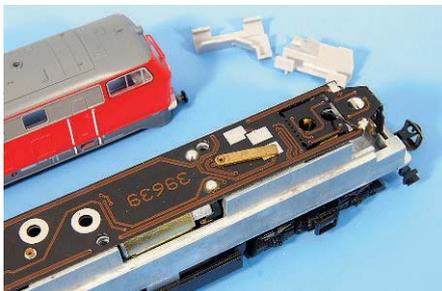
Die früheren Tillig-Modelle besaßen standardisierte Platinen. Durch Absägen einer Brücke gelangte man an die Schnittstelle.
