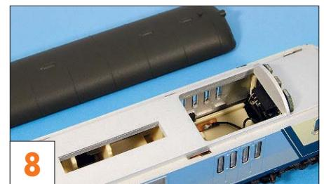
**8** Zum Einsetzen der Decoder in Steuerwagen muss man meist nur das Dach entfernen.
