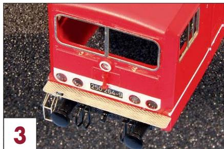
**3** Die Passung von Trittblech und Aufstiegsleiter wird vor der Lackierung überprüft.
