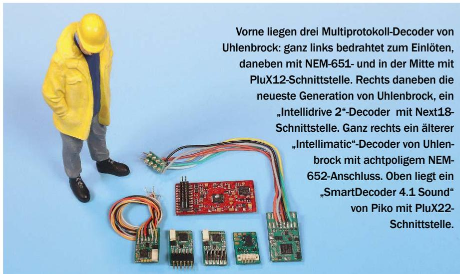
Vorne liegen drei Multiprotokoll-Decoder von Uhlenbrock: ganz links bedrahtet zum Einlöten, daneben mit NEM-651- und in der Mitte mit PluX12-Schnittstelle. Rechts daneben die neueste Generation von Uhlenbrock, ein „Intellidrive 2“-Decoder mit Next18-Schnittstelle. Ganz rechts ein älterer „Intellimatic“-Decoder von Uhlenbrock mit achtpoligem NEM-652-Anschluss. Oben liegt ein „SmartDecoder 4.1 Sound“ von Piko mit PluX22-Schnittstelle.
