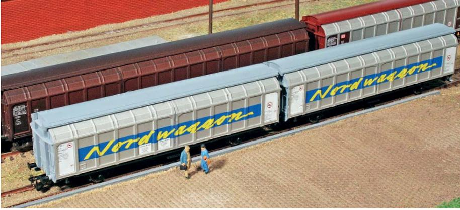
Dieses Hbbins-Pärchen ist korrekt gekuppelt. Der enge Abstand der fest gekuppelten Doppereinheit entspricht dem Vorbild. Das Wagenpärchen entstand in der Werkstatt von Frank Wüstemann unter Verwendung von zwei Roco-Fahrzeugen. Auch der umgebaute Habis im Hintergrund entstand aus den gleichen Spenderfahrzeugen.
