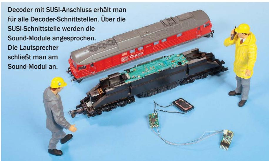
Decoder mit SUSI-Anschluss erhält man für alle Decoder-Schnittstellen. Über die SUSI-Schnittstelle werden die Sound-Module angesprochen. Die Lautsprecher schließt man am Sound-Modul an.
