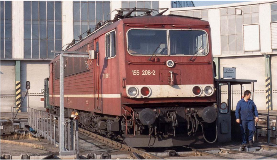
Die markante Stirnseite der 250 ist durch die dünnen Rahmen der großen Fenster geprägt. Über den Puffern befindet sich ein schmales Trittblech, das über eine Leiter an der rechten Frontseite der Lok bestiegen werden kann. (Bw Angermünde, 9. September 2000)
