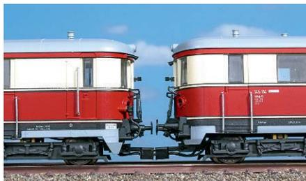
In der Seitenansicht ist gut zu erkennen, dass die Kabel dicht unter der Kupplung verlaufen und kaum zu sehen sind. Noch vor den Drehgestellen führen sie ins Innere.
