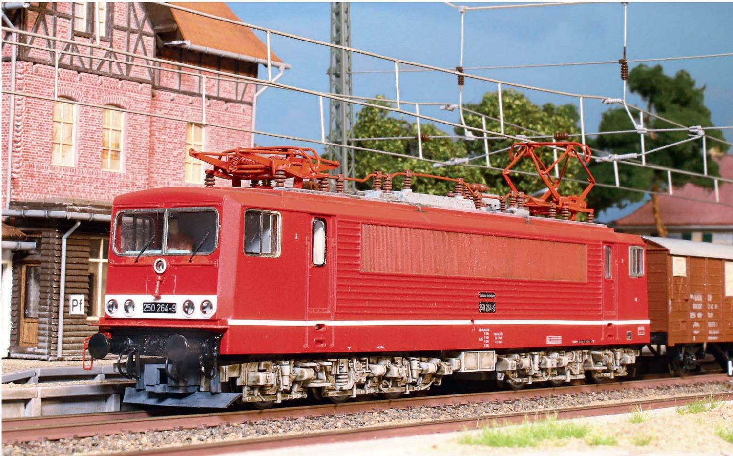
Die neuen Scheiben stehen der 250 sehr gut und lassen das gesamte Modell deutlich filigraner erscheinen. Auch neue Scheibenwischer wurden aus Ätzteilen angesetzt. Eine dezente Alterung lässt die Konturen des Gehäuses sehr gut zur Geltung kommen.
