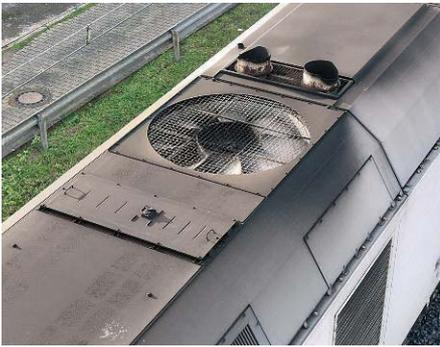
Das Lüfterrad fehlt am Start-Modell. Beim Vorbild ist es durch ein Gitter abgedeckt. Dahinter liegen die Abgasöffnungen.
