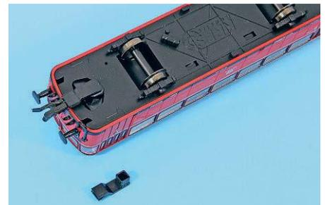
Statt der stromführenden Kupplungsdeichseln kann man auch NEM-Schächte einsetzen. Beim VT/VS98 der DB lassen sich so auch normale Wagen kuppeln.
