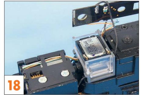
**18** Der Lautsprecheranschluss erfolgt drahtlos mit Federkontakten unterhalb der Platine.
