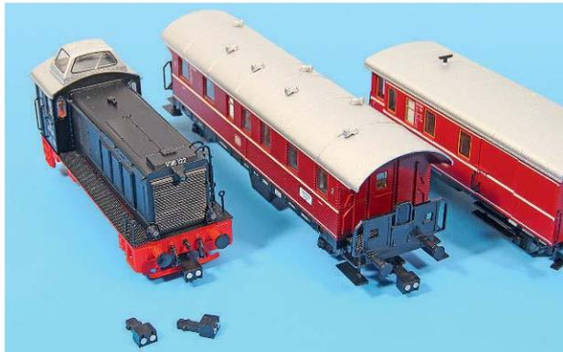
Die Peho-Magnetkupplungen besitzen zwei gegenseitig gepolte Magnete mit hoher Anziehungskraft auch für schwere Züge. Sie ermöglichen auch das Kurzkuppeln.
