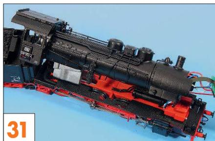
**31** Die Kabel führt man nach vorne und setzt den Kessel wieder auf das Fahrwerk.
