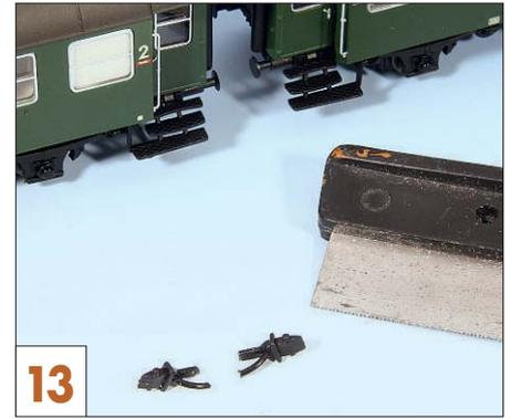
www.modellbahnmanufaktur-crottendorf.de) TT-Schraubenkupplungen als Attrappe oder als funktionsfähige Version zum Nachrüsten. Die unbeweglichen Kupplungen bestehen aus Messingguss und sind bereits geschwärzt (Art.-Nr. 900036). Sie müssen nur vom Gussbaum getrennt und in eine 1-mm-Bohrung im Pufferträger geklebt werden.
