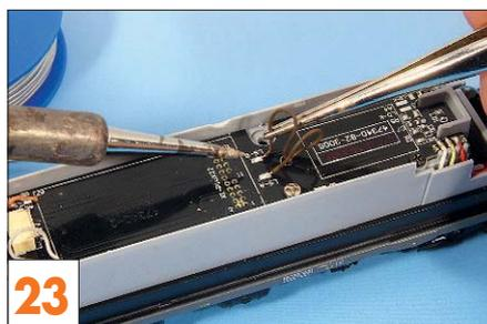
**23** Auf der Oberseite der Platine lötet man die Drähte mit einem feinen LötKolben an.
