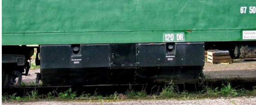
Zweimal 500 Liter Dieselmotorkraftstoff fassten die beiden Tanks des Maschinenwagens. Der Sprit war für die beiden W50-Motoren vorgesehen.
