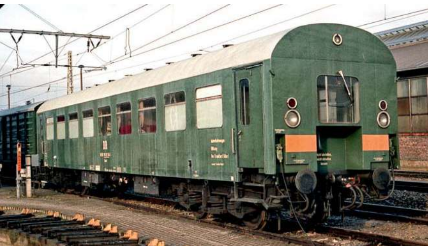
Der Aufenthaltswagen des Hilfszugs war auch mit einem Steuerabteil ausgerüstet (Frankfurt/Oder, 12. Januar 1994).
