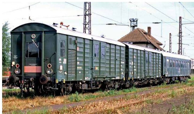
Am anderen Ende des Hilfszugs war der Maschinenwagen eingereiht, ebenfalls mit einem Hilfs-Führerstand ausgestattet.
