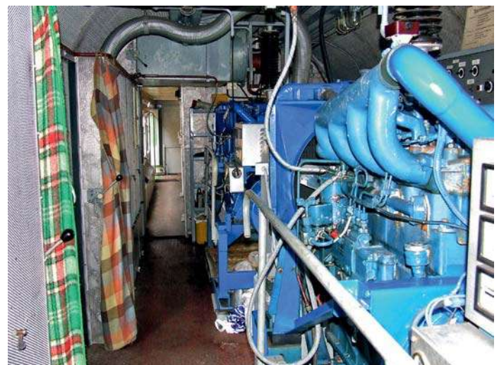
Autarkie ist Trumpf. Die Dieselmotoren im Maschinenwagen dienten zur Stromversorgung des K-Zuges.
