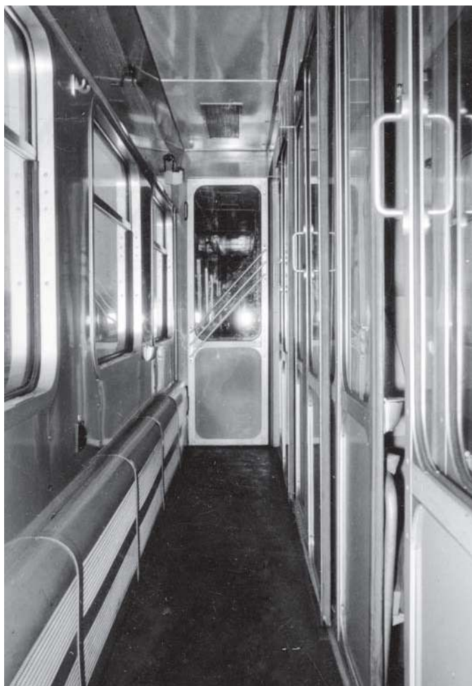
Eloxiertes Aluminium und Sprelacart: Beim Neubau der Wagenkästen wurde auf ein zeitgemäßes Interieur Wert gelegt.
