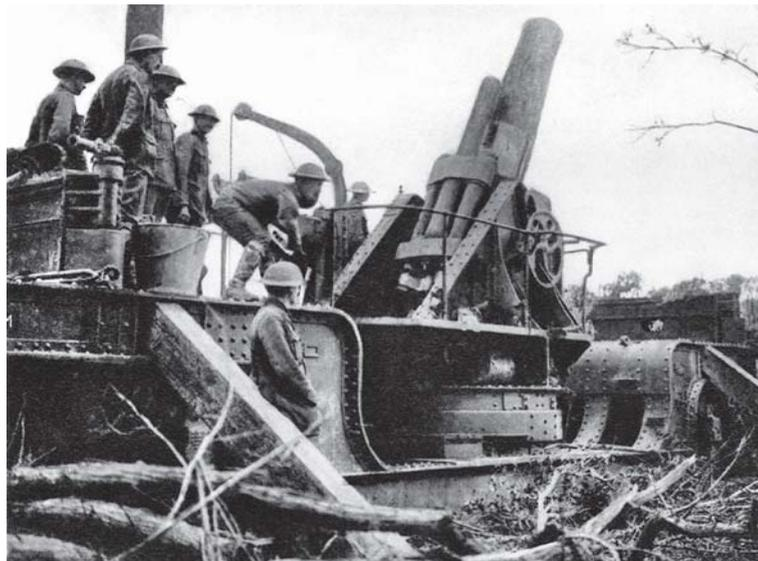
*Die britische 305-Millimeter-Eisenbahnhaubitze MK I zeichnete sich speziell durch ihre rundum drehbare Kanone aus und kam ab Ende 1916 an der Westfront zum Einsatz.*
