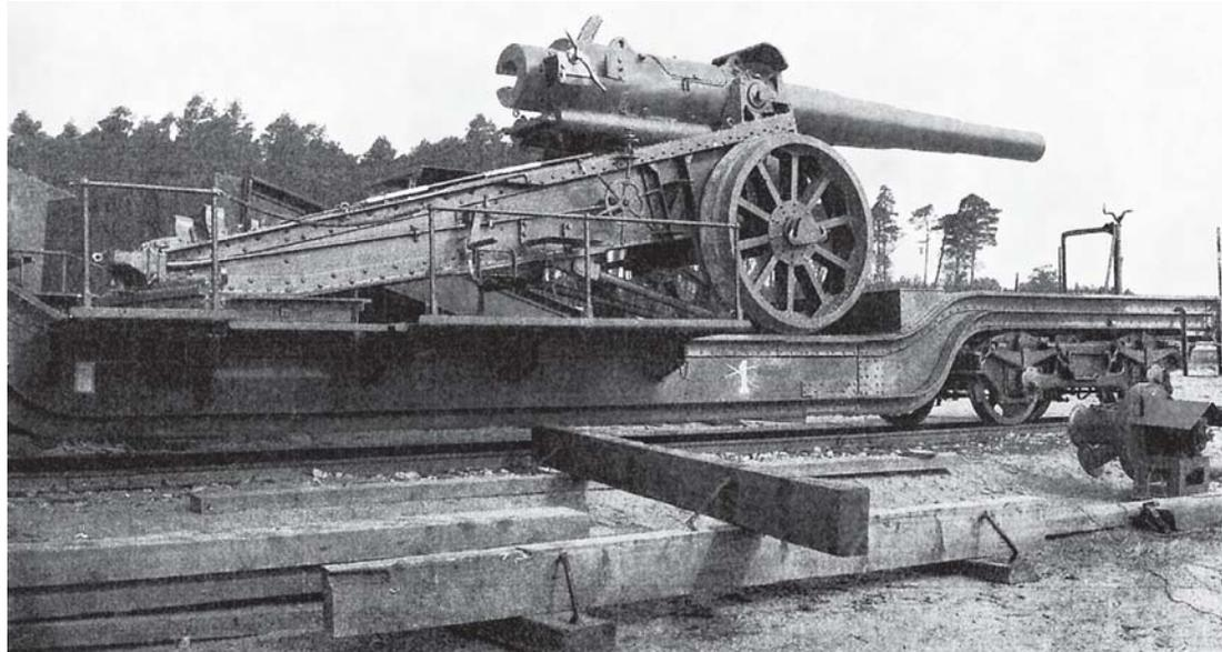
Die deutsche 17-cm Eisenbahnkanone L/40 kam ab 1916 zum Einsatz an der Westfront, konnte um 27 Grad seitlich ausgerichtet werden. Die Kanone war ein Schiffsgeschütz.
