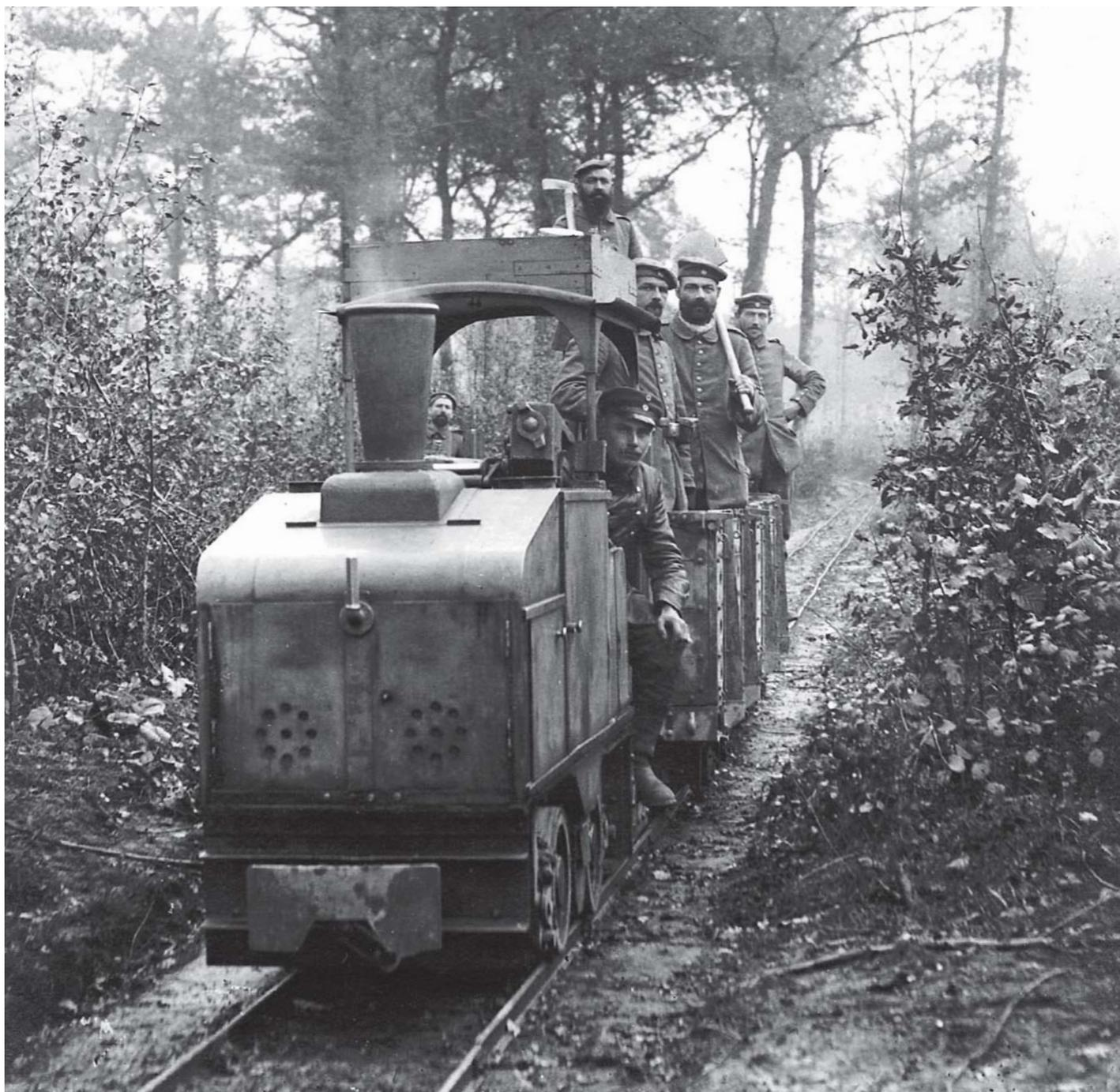
Größte Verbreitung im deutschen Feldbahnbetrieb fanden die einzylindrigen Benzolmotorlokomotiven, hauptsächlich vom Hersteller Deutz. Hinter der Westfront empfahlen sie sich insbesondere durch das Fehlen von verräterischen Rauch- und Dampfwolken.
