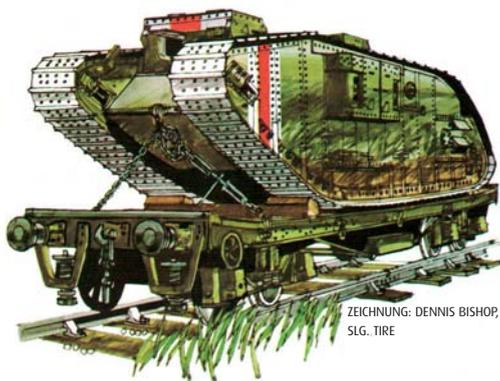
Für die englischen MK-IV-Panzer wurde 1917 ein spezieller Wagen entwickelt, der so genannte Rectank-Waggon.
