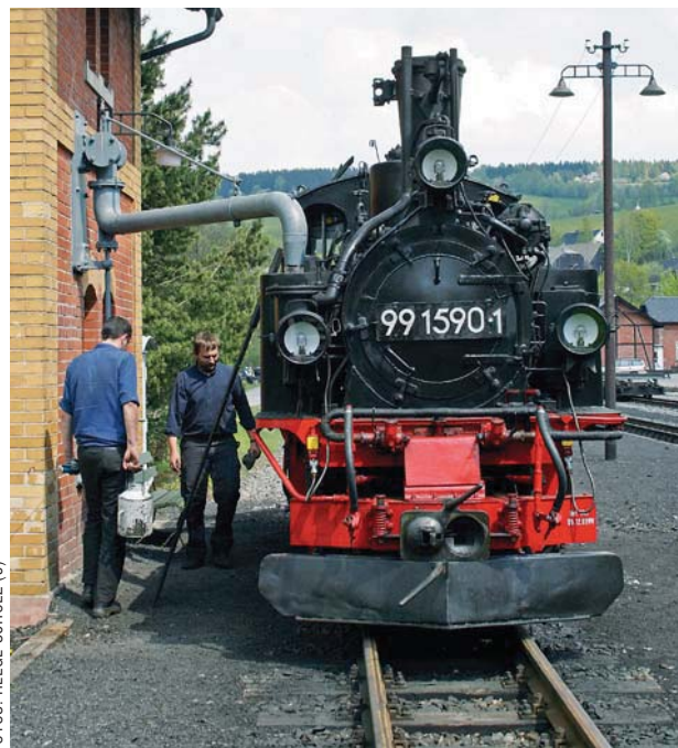
Am Steinbacher Wasserhaus ist der einzige noch funktionsfähige Wandwasserkran Sachsens Quell des Kesselspeisewassers.
