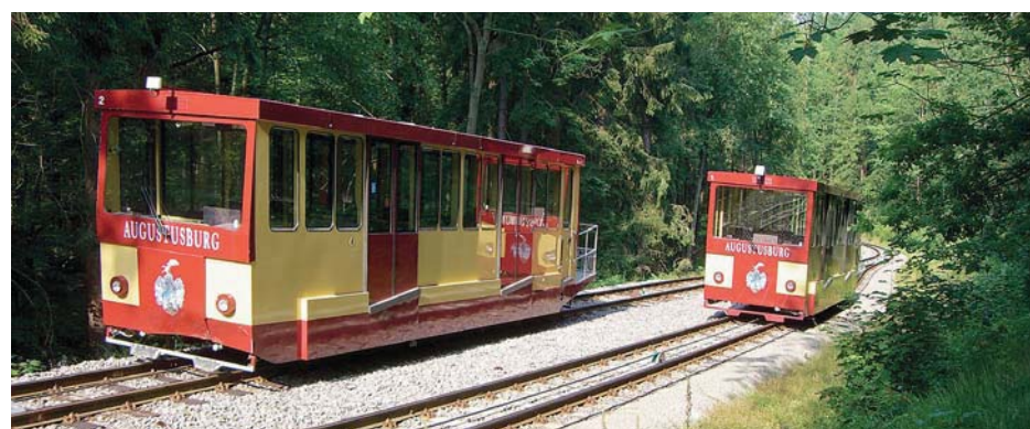
Die beiden Wagen der Standseilbahn, die den Ortsteil Erdmannsdorf mit der Stadt Augustusburg verbindet, begegnen sich an der Ausweichstelle.
