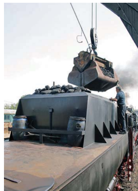
52 8080-5 wird für ihre Abreise nach Löbau mit Kohle versorgt. Laut poltern die Brocken in den Tender hinein.
