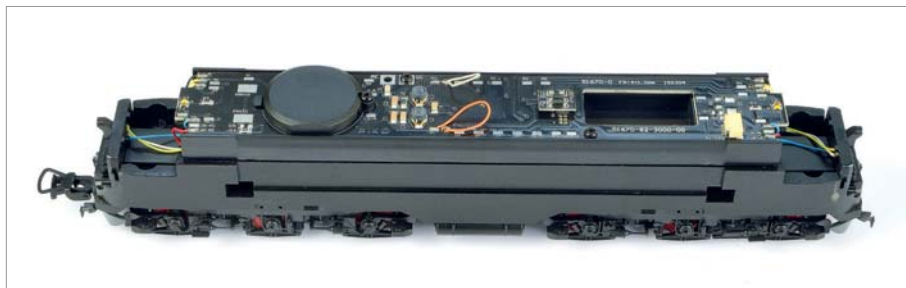
Das Innere präsentiert sich aufgeräumt. Zur Digitalisierung ist lediglich der leicht außermittig sitzende Brückenstecker gegen den Decoder zu tauschen. Der Rahmen besteht aus Zink.
