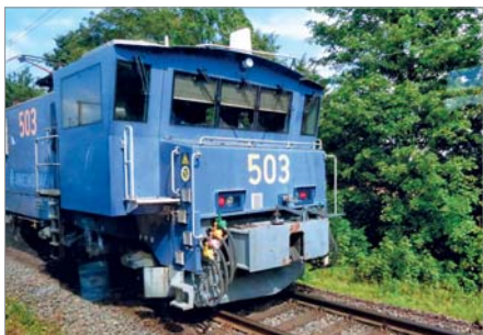
Die EL 2000 haben für geschobene Fahrten einen besonders breiten Führerstand.
