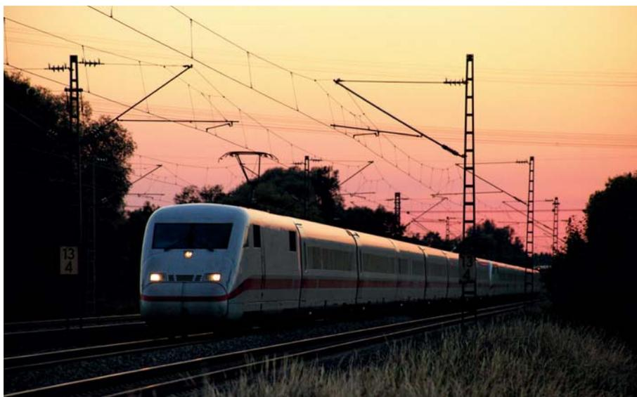
Bremst ein ICE aus 250 km/h bis zum Stillstand, wird viel Bremsenergie frei, die dank Drehstromtechnik unkompliziert ins Netz zurückgespeist werden kann.
