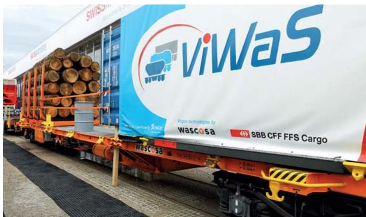
Der Wascosa-Wagen mit Entwicklungen des EU-Forschungsvorhabens ViWaS zur Optimierung des Einzelwagenverkehrs.
