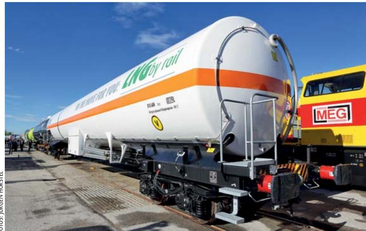
Beinahe 25 Meter ist der beeindruckende VTG-Kesselwagen für LNG (liquefied natural gas). Flüssiges Erdgas hat etwa eine Temperatur von minus 160 Grad Celsius.
