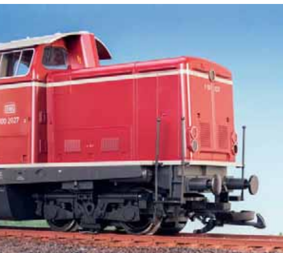
Auf empfindliche Ansetzdetails hat der Hersteller verzichtet. Lediglich die Rangierertritte und die Puffer sind in den Rahmen gesteckt.
