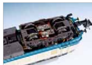
Bei der 217 treibt der Drehgestell-Motor über einen Gummiring zwei Radsätze an.
