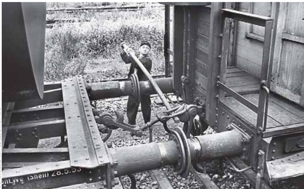
Der Moment des Abkuppelns: Der „Loshänger“ hebt im Rangierbahnhof Gremberg die bereits entspannte Schraubenkupplung vom Kupplungshaken. Die Aufnahme stammt von 1955.
