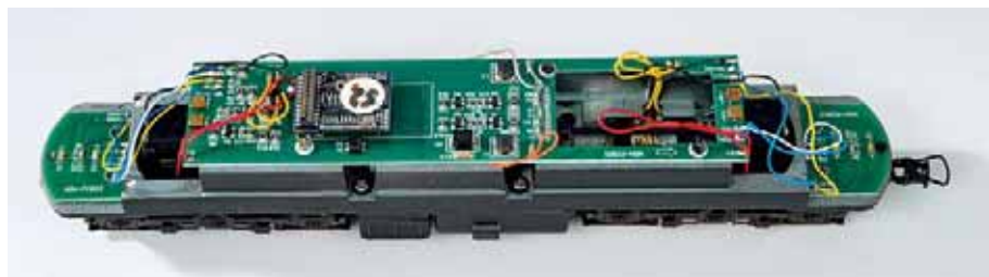
Die getestete Digital-Version ist mit einem ESU-Decoder ausgestattet. Sogar ein Lautsprecher ist schon eingebaut, doch ohne Sounddecoder gibt er keinen Mucks von sich.
